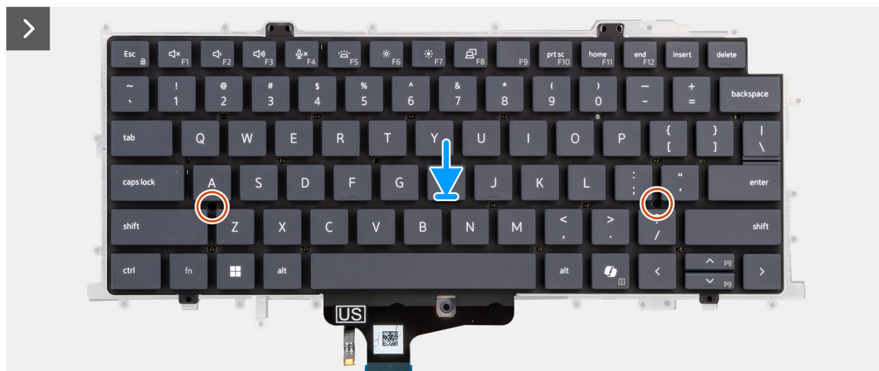
Rysunek 83. Instalowanie klawiatury
