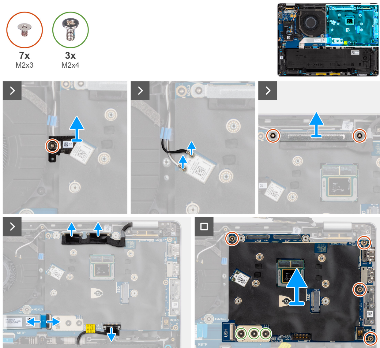
Rysunek 48. Wymontowywanie płyty głównej
