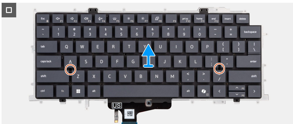
Rysunek 82. Wymontowywanie klawiatury
