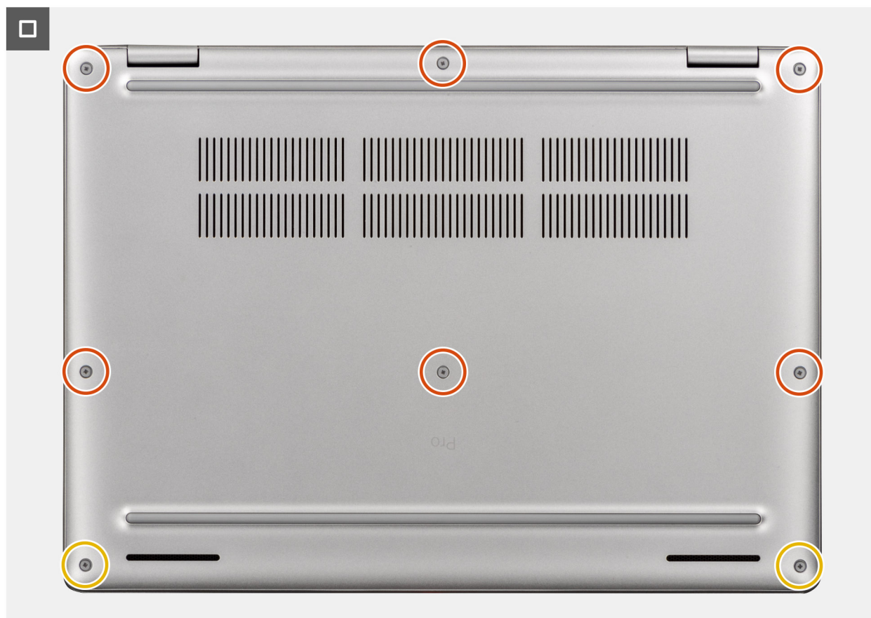
Rysunek 26. Instalowanie pokrywy dolnej
