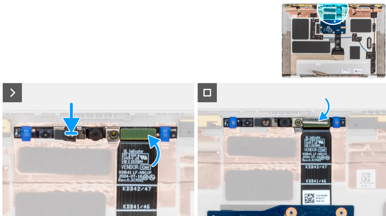
Rysunek 78. Instalowanie kamery MIPI
