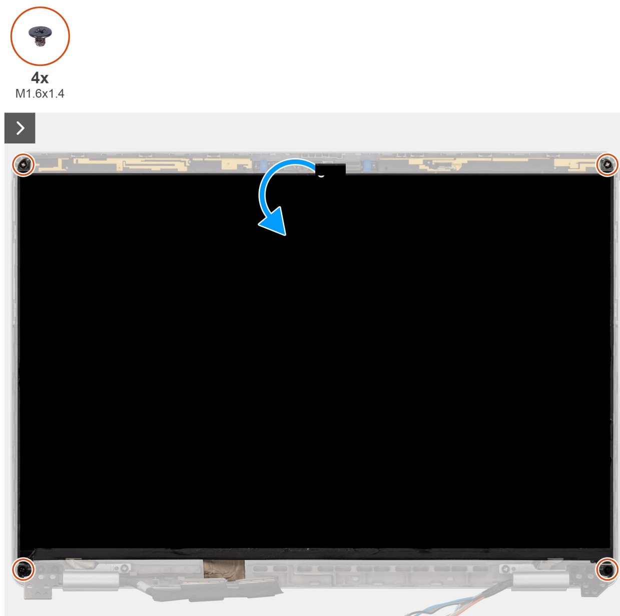
Rysunek 68. Wymontowywanie wyświetlacza
