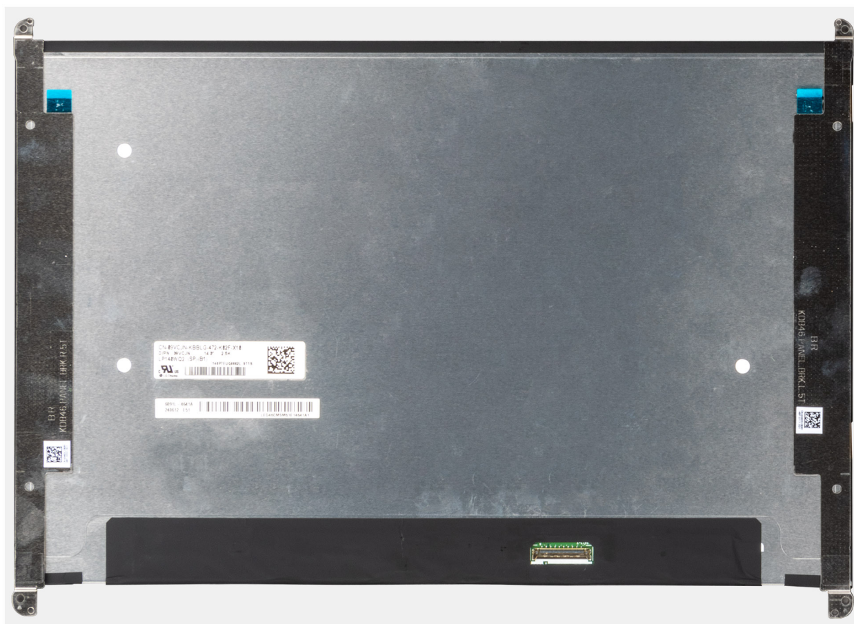
Rysunek 70. Panel wyświetlacza z uchwytami
