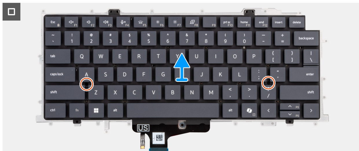
Rysunek 98. Wymontowywanie klawiatury
