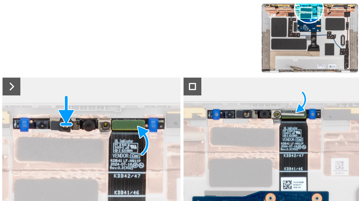
Rysunek 84. Instalowanie kamery MIPI
