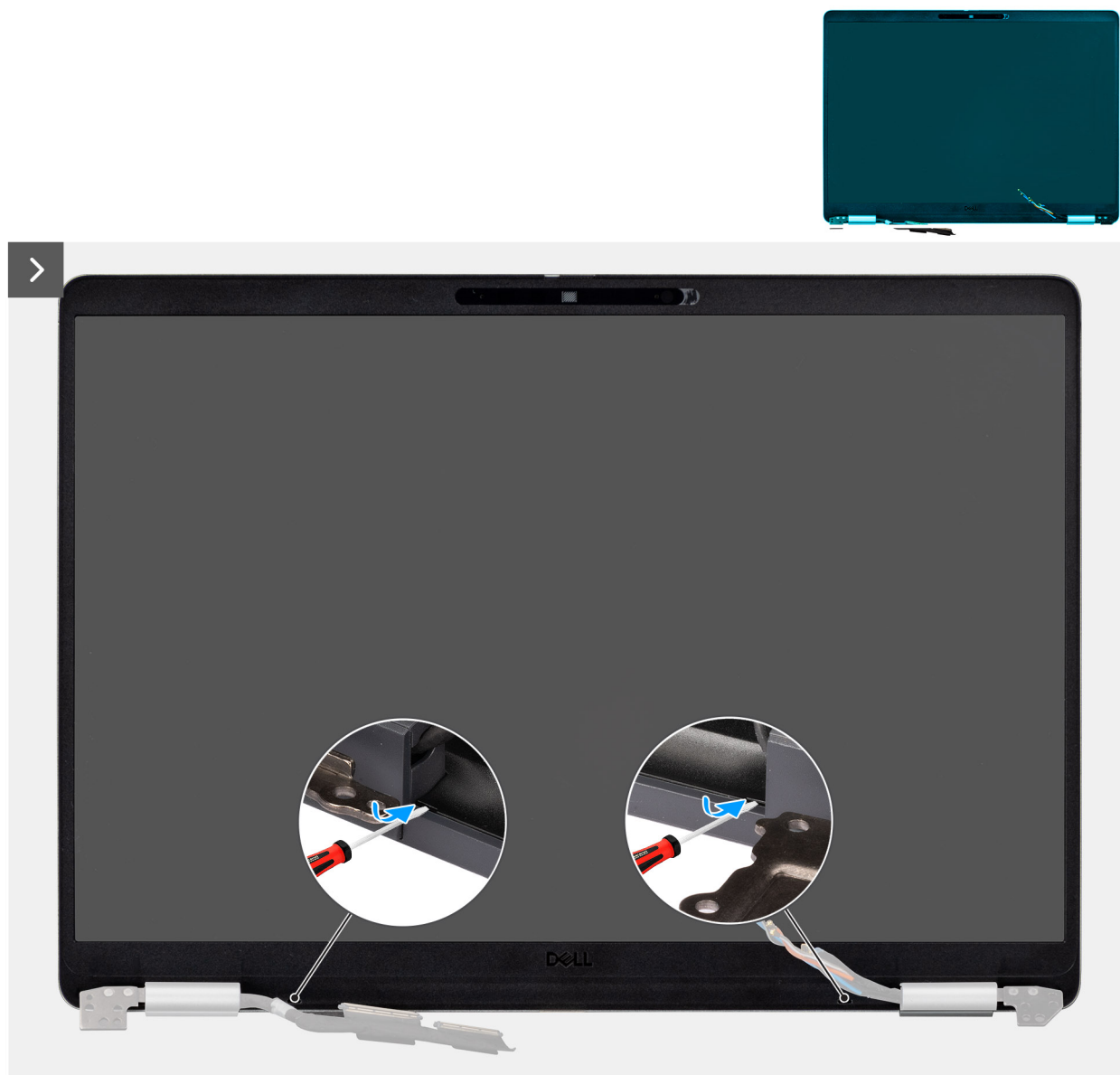
Rysunek 65. Podważanie plastikowej ramki
