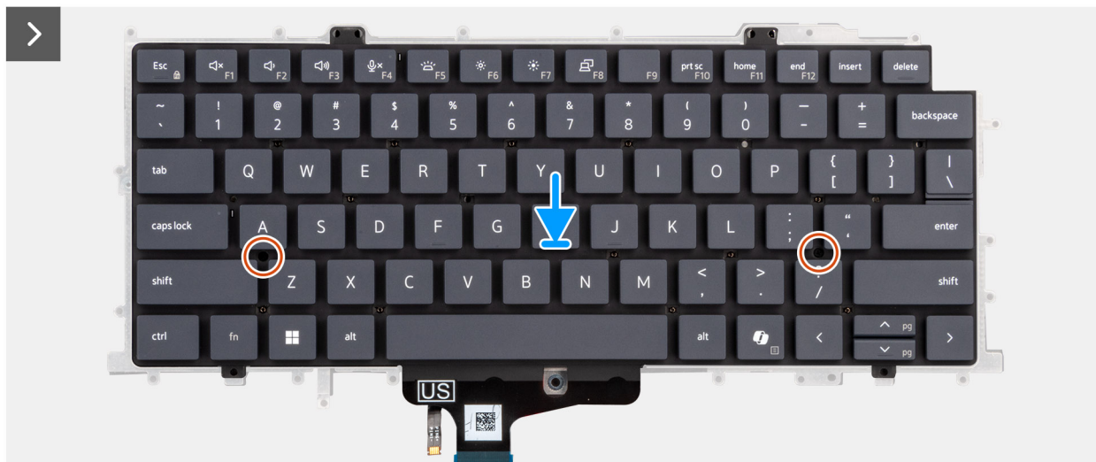
Rysunek 99. Instalowanie klawiatury
