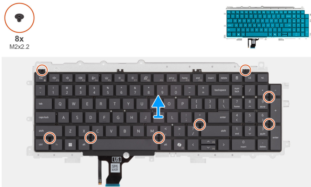
Rysunek 85. Wymontowywanie płyty nośnej klawiatury
