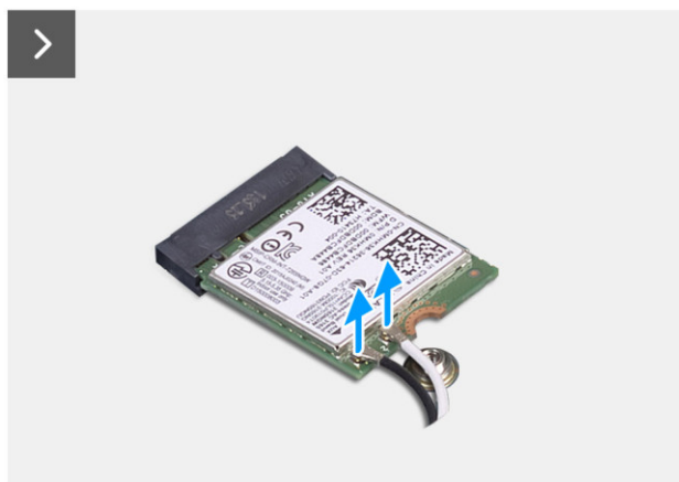
Rysunek 25. Wymontowywanie karty sieci bezprzewodowej
