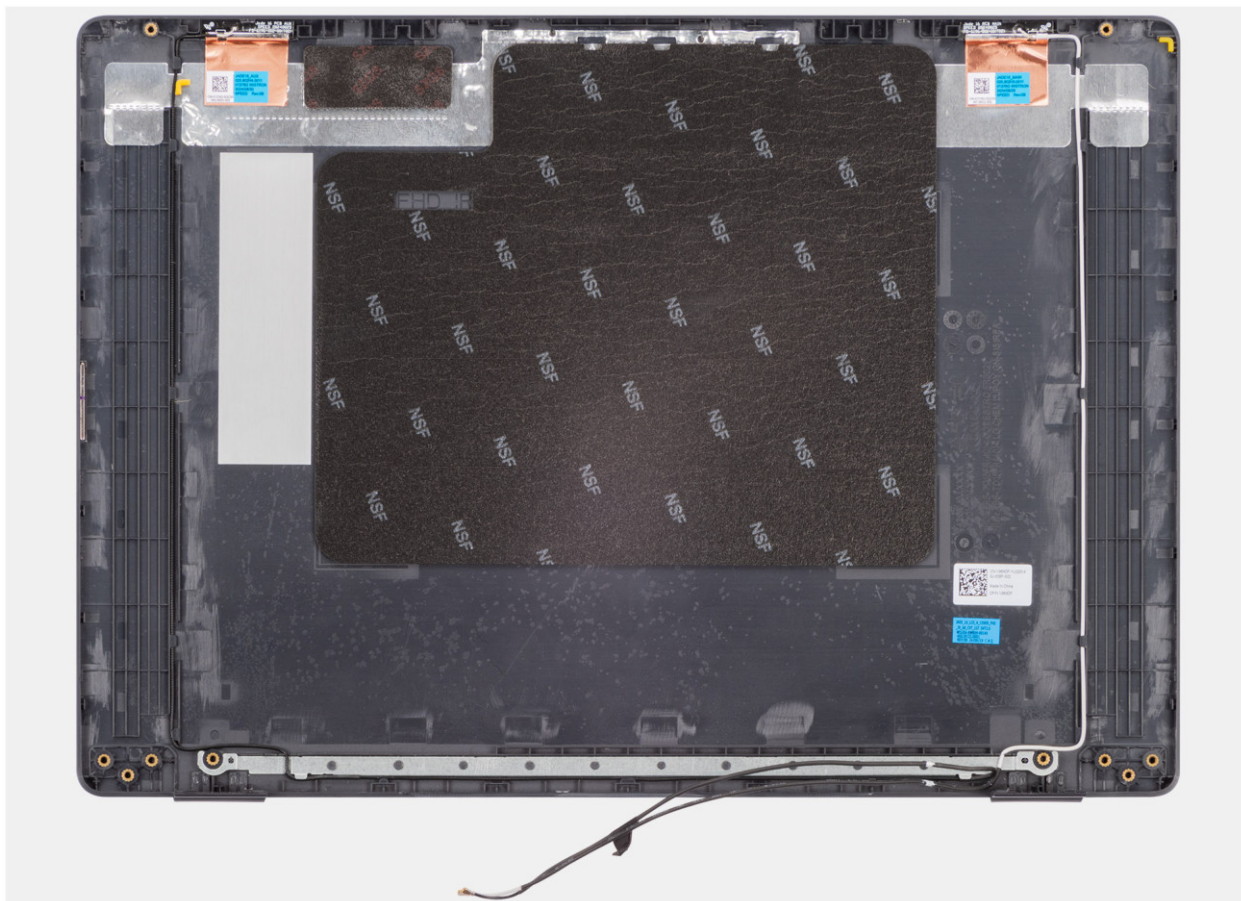
Rysunek 117. Wymontowywanie zestawu pokrywy tylnej wyświetlacza
