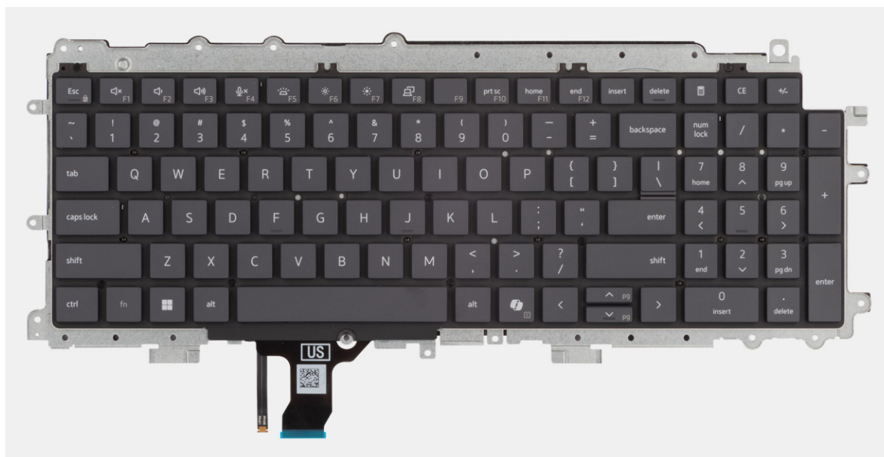
Rysunek 81. Wymontowywanie klawiatury
