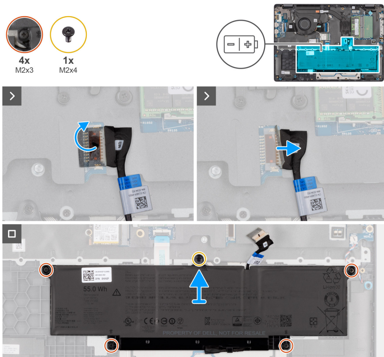
Rysunek 17. Wymontowywanie baterii
