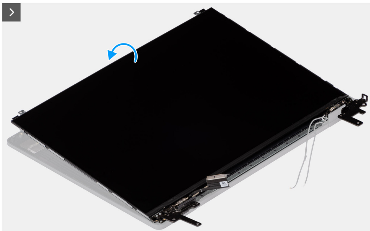
Rysunek 111. Instalowanie zestawu panelu wyświetlacza
