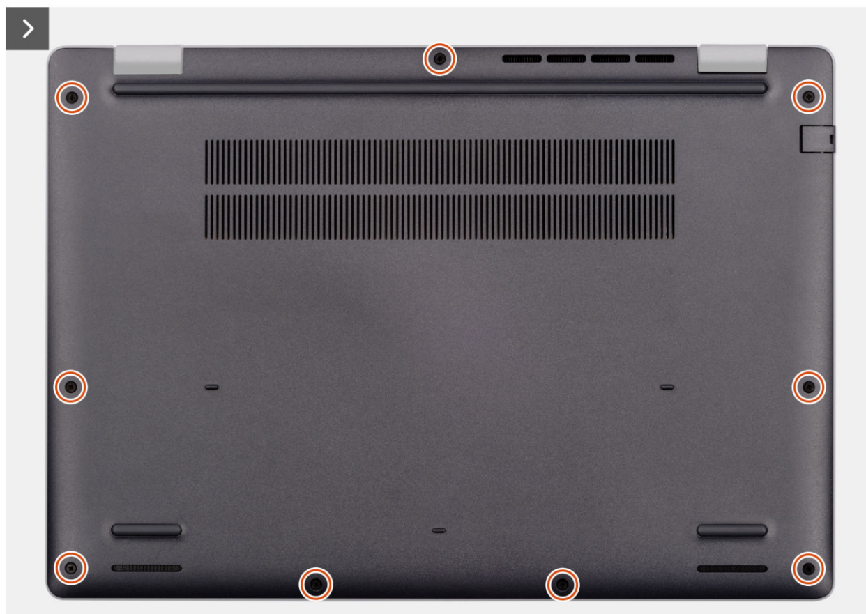
Rysunek 11. Wymontowywanie pokrywy dolnej
