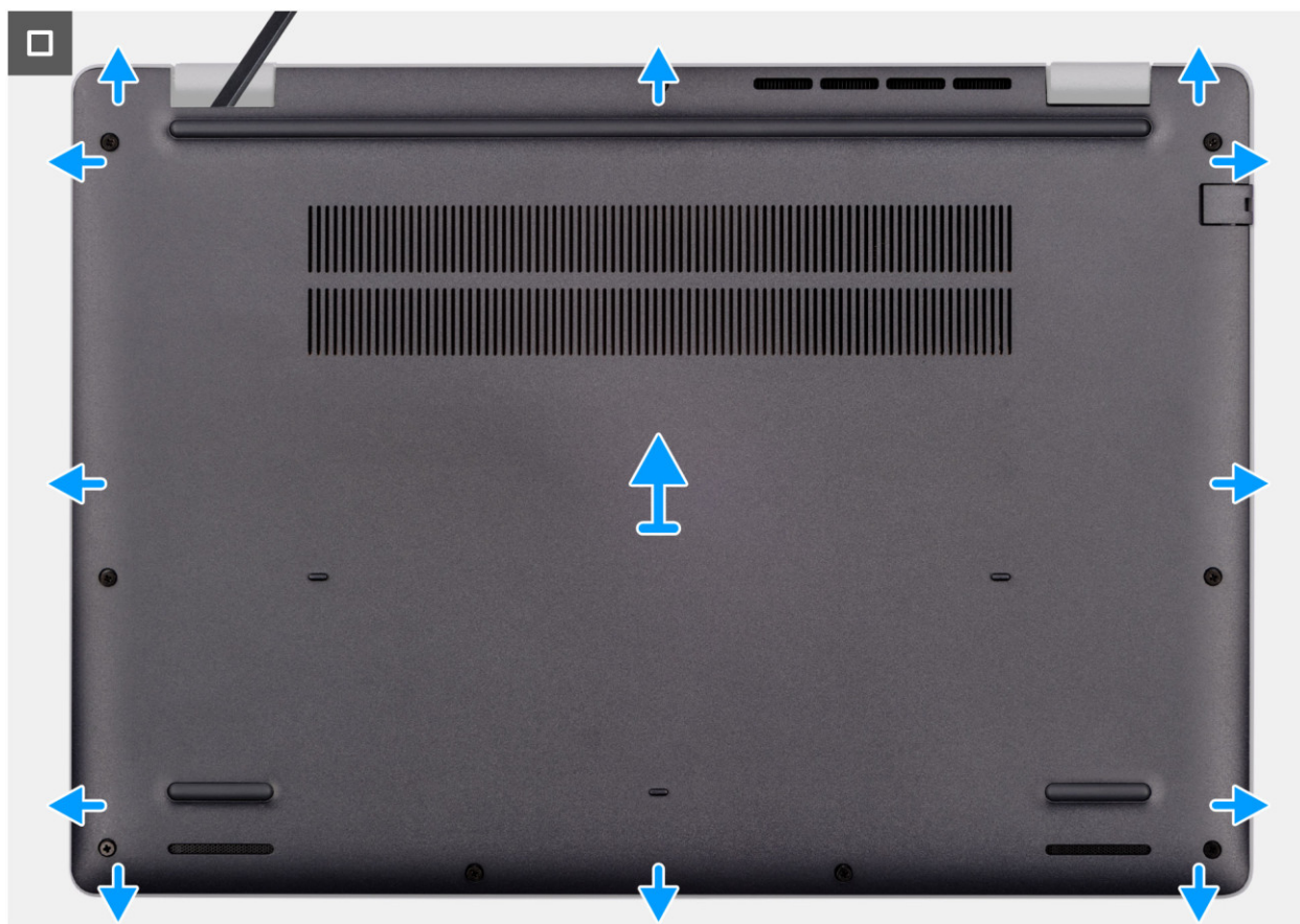
Rysunek 12. Wymontowywanie pokrywy dolnej
