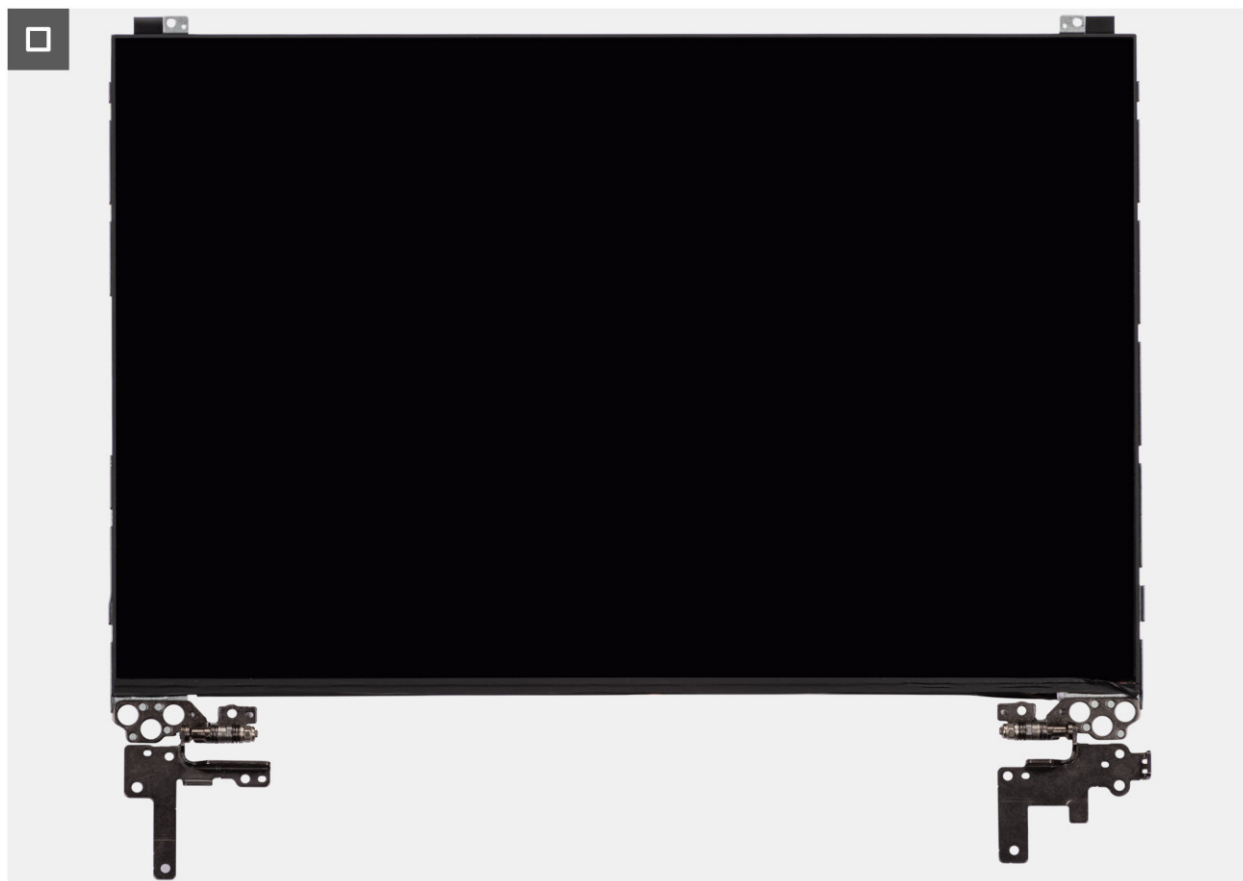
Rysunek 108. Wymontowywanie zestawu panelu wyświetlacza
