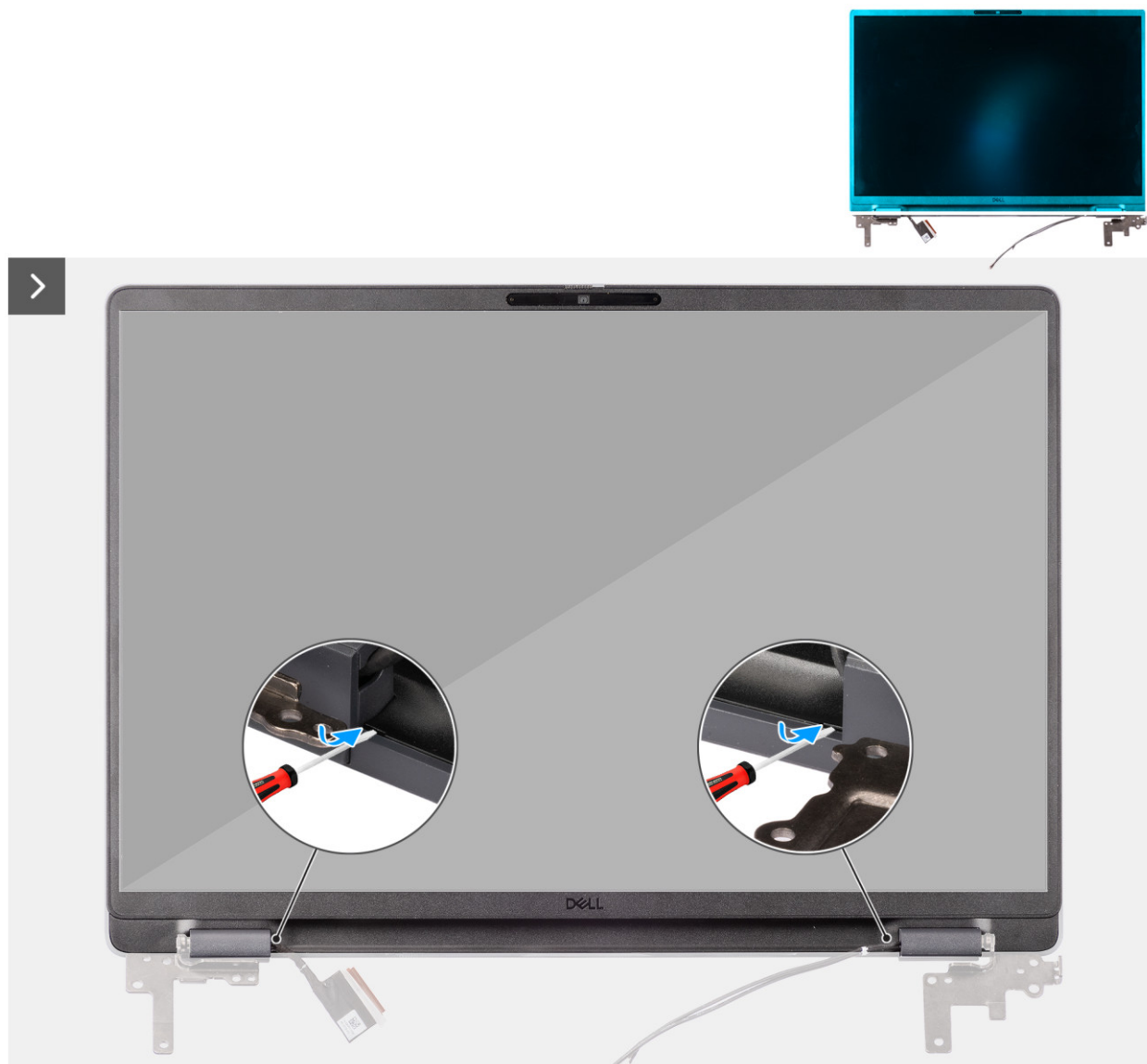
Rysunek 98. Wymontowywanie ramki wyświetlacza
