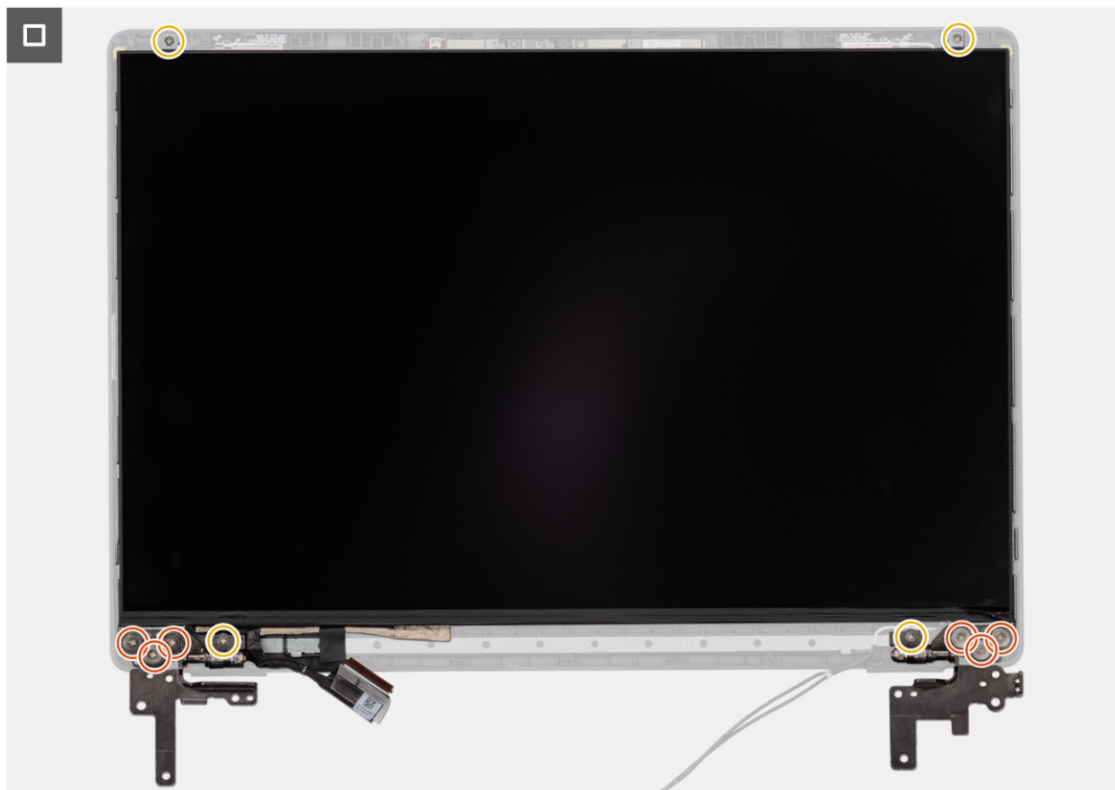
Rysunek 112. Instalowanie zestawu panelu wyświetlacza
