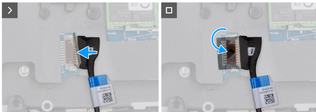
Rysunek 14. Podłączanie kabla baterii
