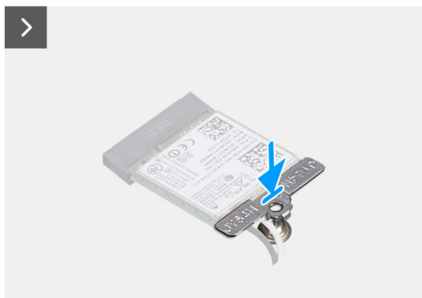
Rysunek 26. Instalowanie karty sieci bezprzewodowej
