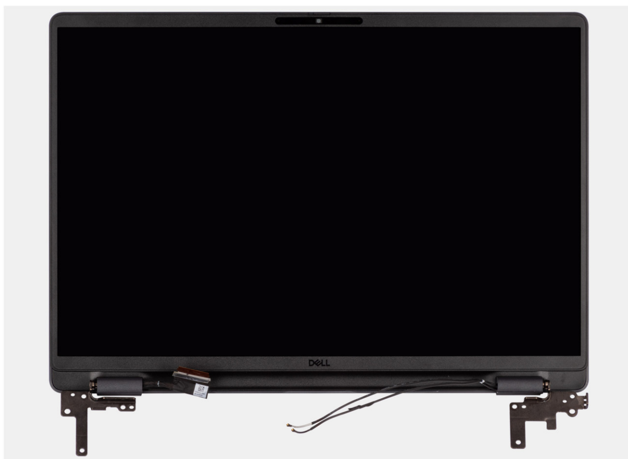
Rysunek 95. Wymontowywanie zestawu wyświetlacza
