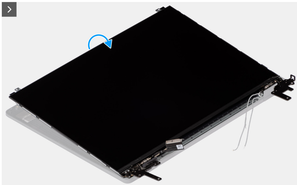
Rysunek 106. Wymontowywanie zestawu panelu wyświetlacza
