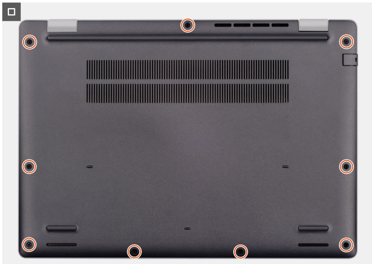
Rysunek 16. Instalowanie pokrywy dolnej
