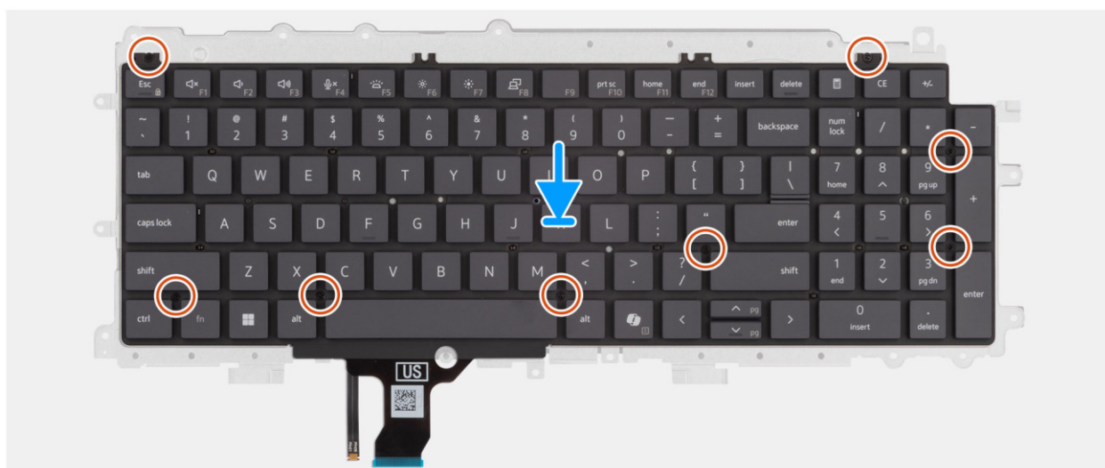
Rysunek 88. Instalowanie płyty nośnej klawiatury
