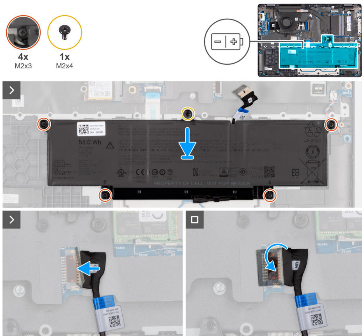
Rysunek 18. Instalowanie baterii
