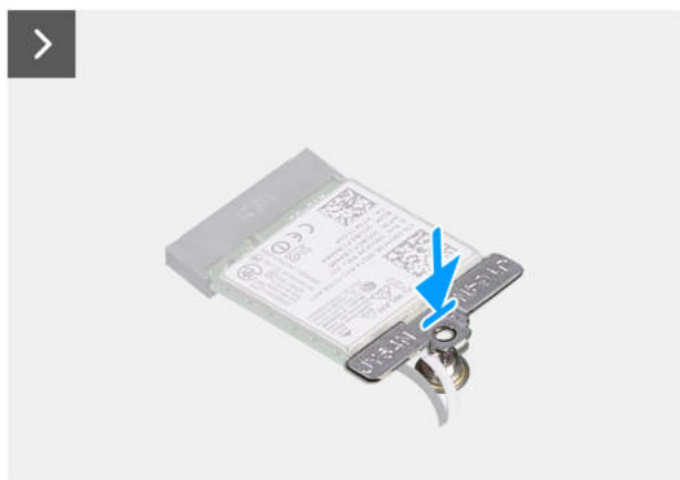
Rysunek 36. Instalowanie karty sieci WLAN
