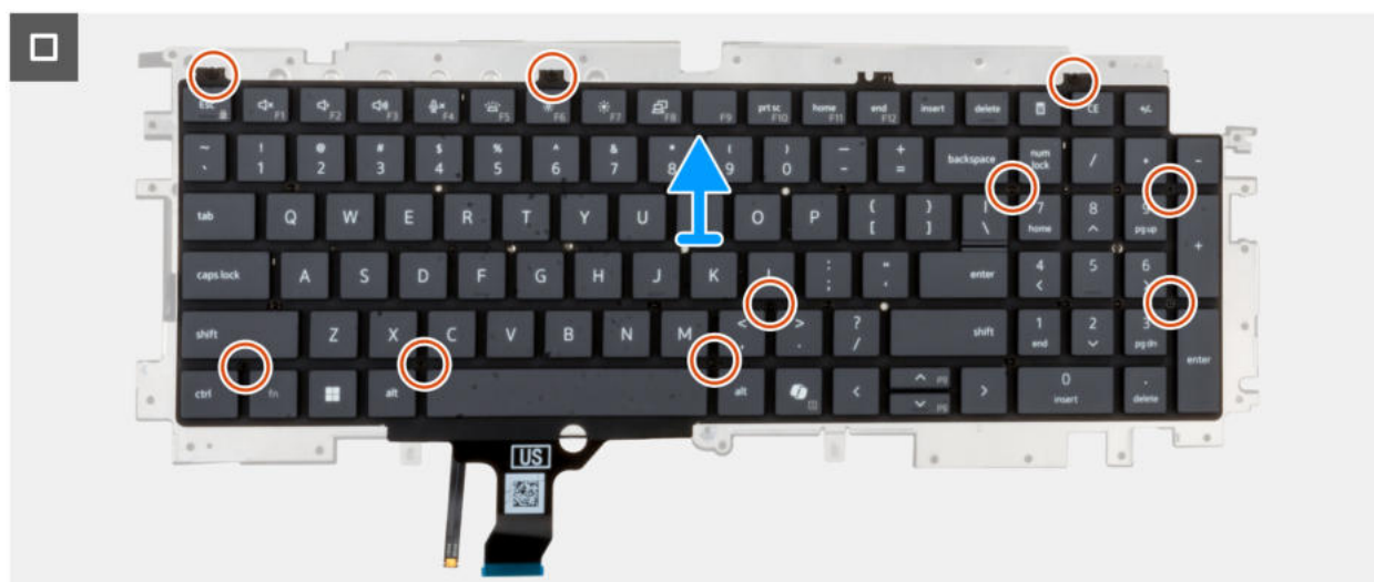
Rysunek 85. Wymontowywanie klawiatury
