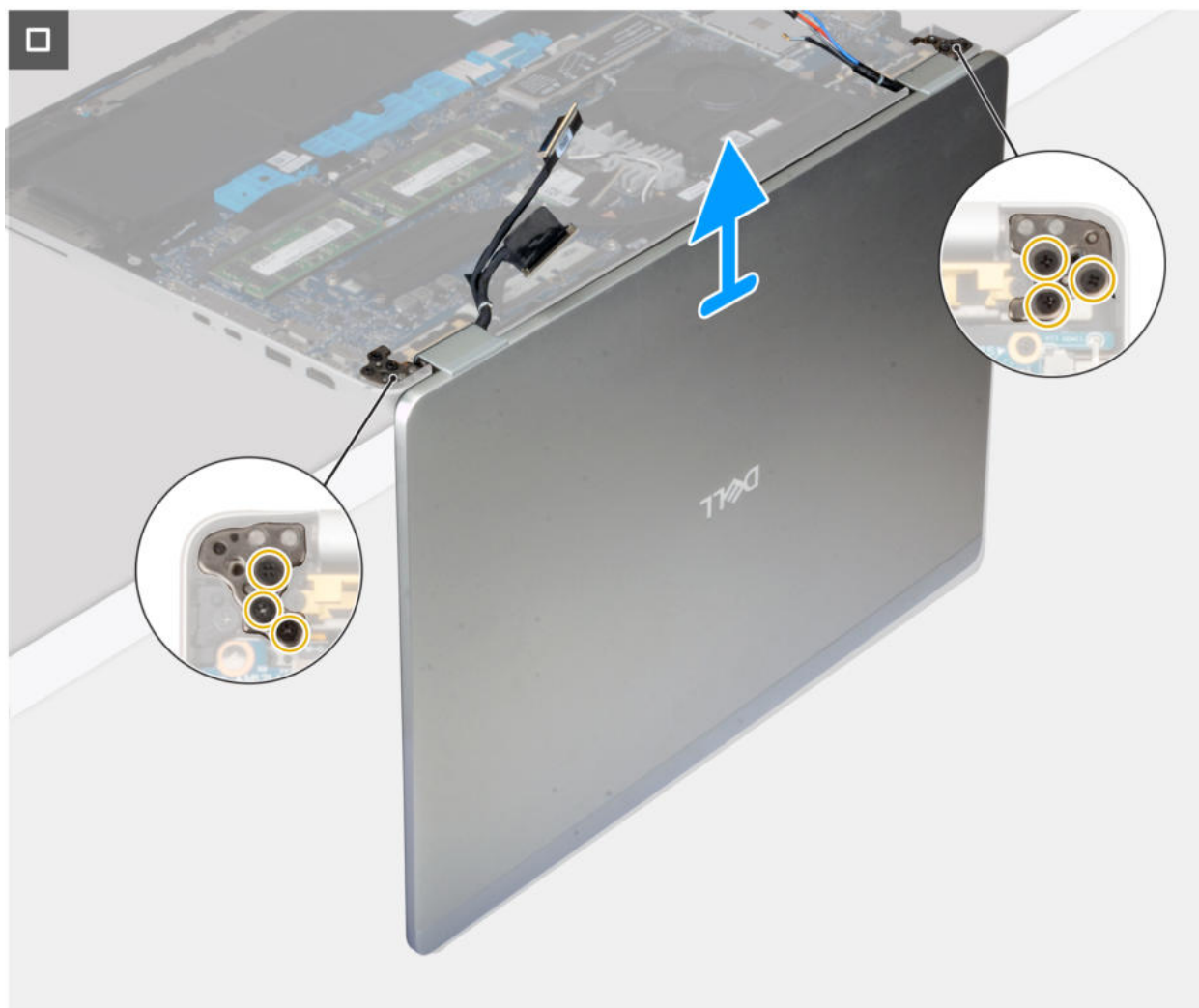
Rysunek 62. Wymontowywanie zestawu wyświetlacza
