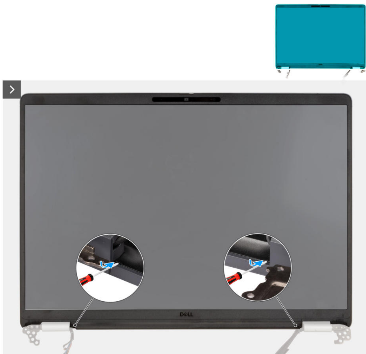
Rysunek 64. Podważanie plastikowej ramki
