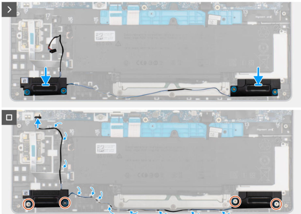
Rysunek 39. Instalowanie głośników
