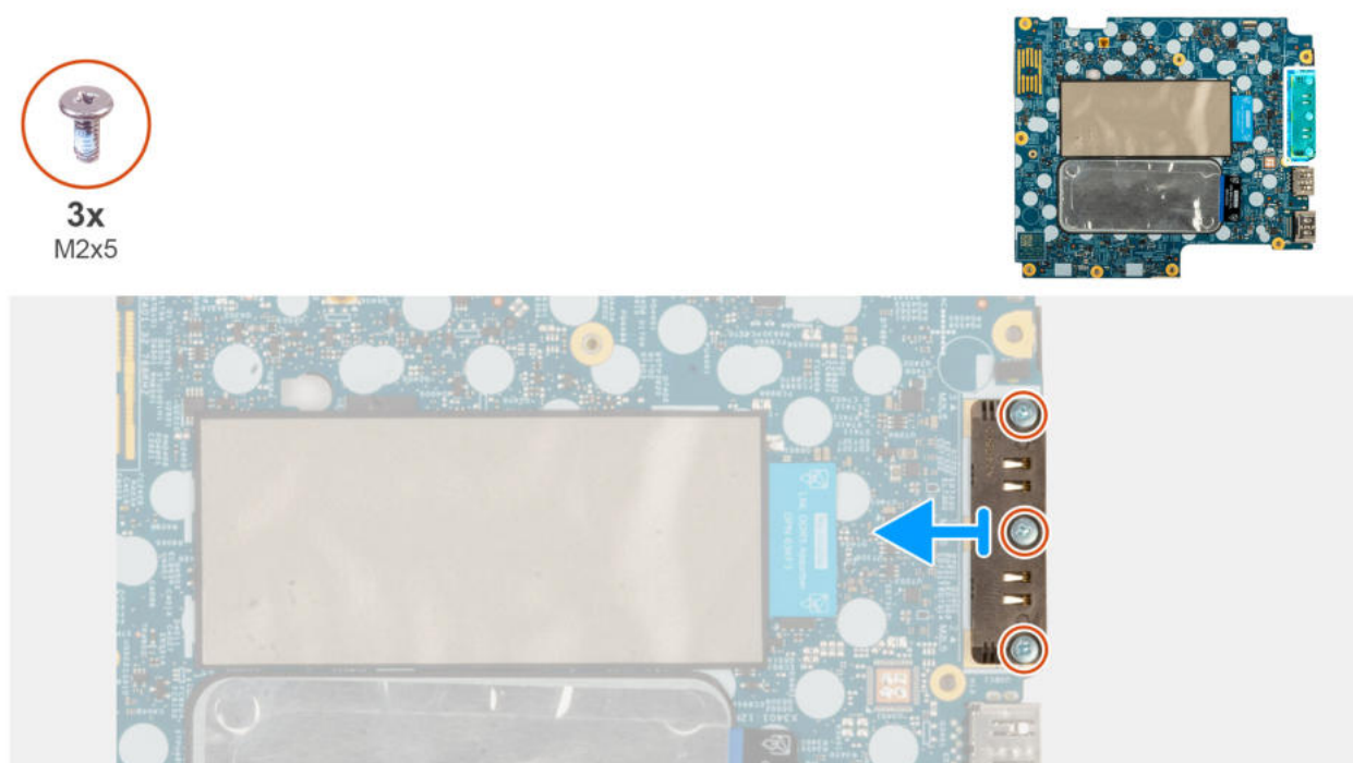
Rysunek 77. Wymontowywanie modułu łącznika USB Type-C
