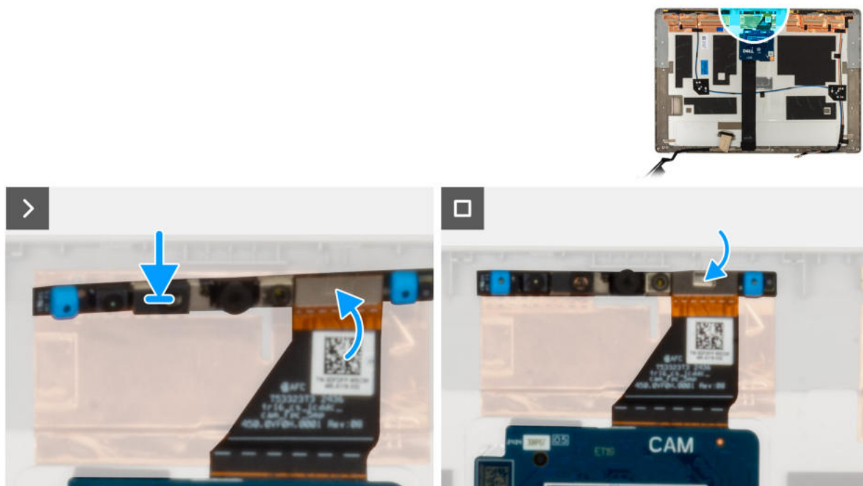
Rysunek 74. Instalowanie modułu kamery
