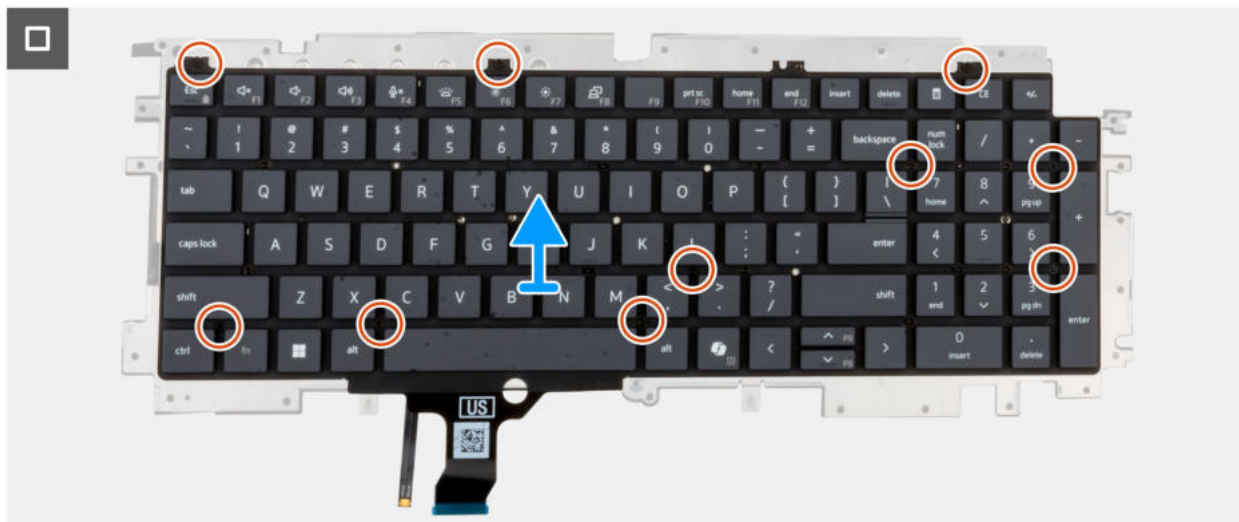
Rysunek 80. Wymontowywanie klawiatury
