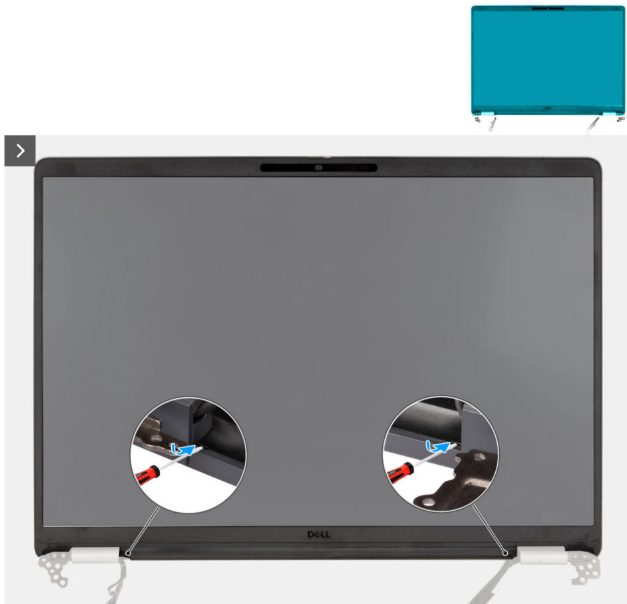
Rysunek 59. Podważanie plastikowej ramki
