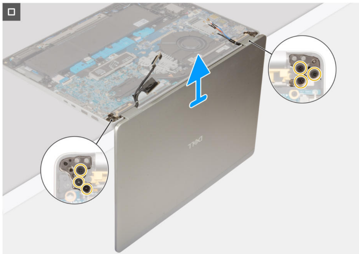
Rysunek 56. Wymontowywanie zestawu wyświetlacza
