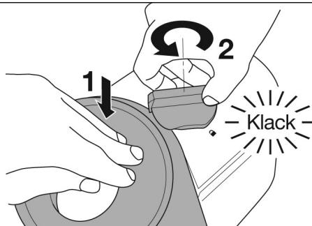
Dabei immer sicherstellen, dass sich der Funktionsknopf auf der „Aus“-Position ( ⓘ ) befindet, bevor der Deckel verriegelt wird.
