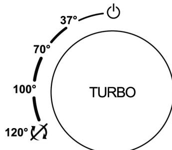
**37°:** Maden er varmet til 37 °C og rørt rundt ved 200 rpm.
