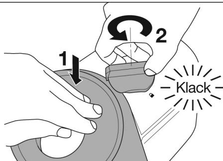
Se alltid till att funktionsknappen står på "Av" (⌚) innan locket läses fast.
