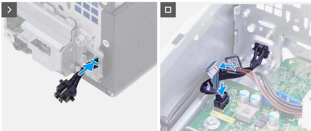
Rysunek 44. Instalowanie przycisku zasilania
