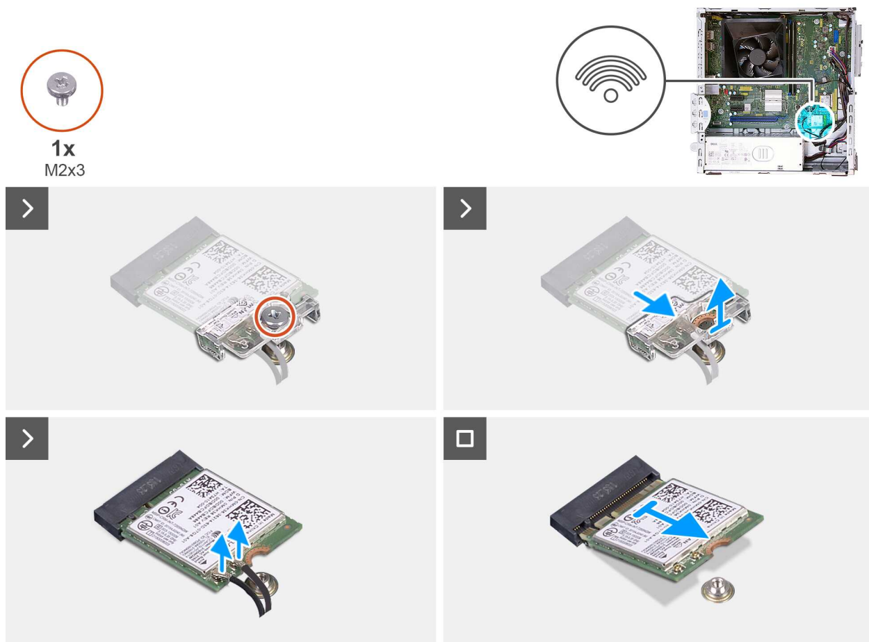
Rysunek 27. Wymontowywanie karty sieci bezprzewodowej
