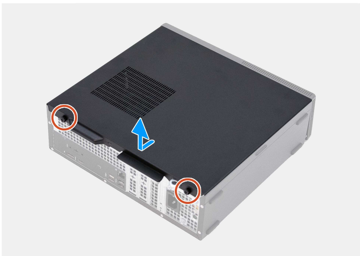
Rysunek 11. Wymontowywanie lewej pokrywy bocznej
