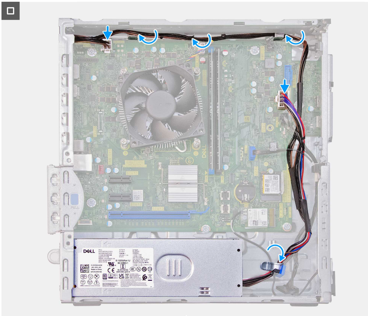
Rysunek 36. Instalowanie zasilacza
