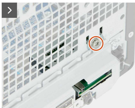
Rysunek 29. Wymontowywanie czytnika kart pamięci
