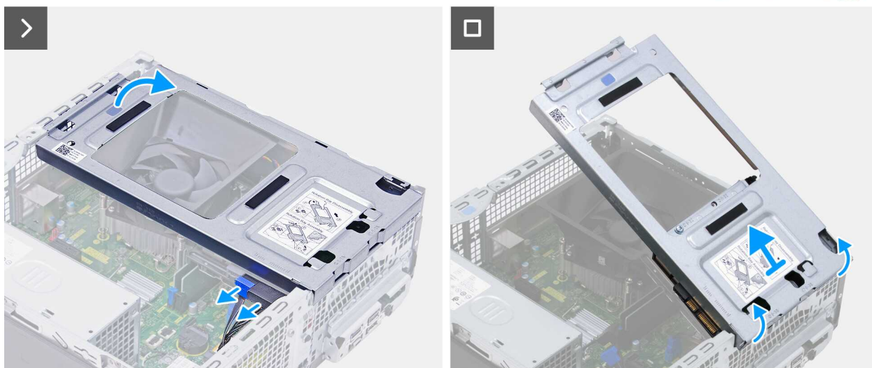
Rysunek 19. Wymontowywanie kieszeni obrotu
