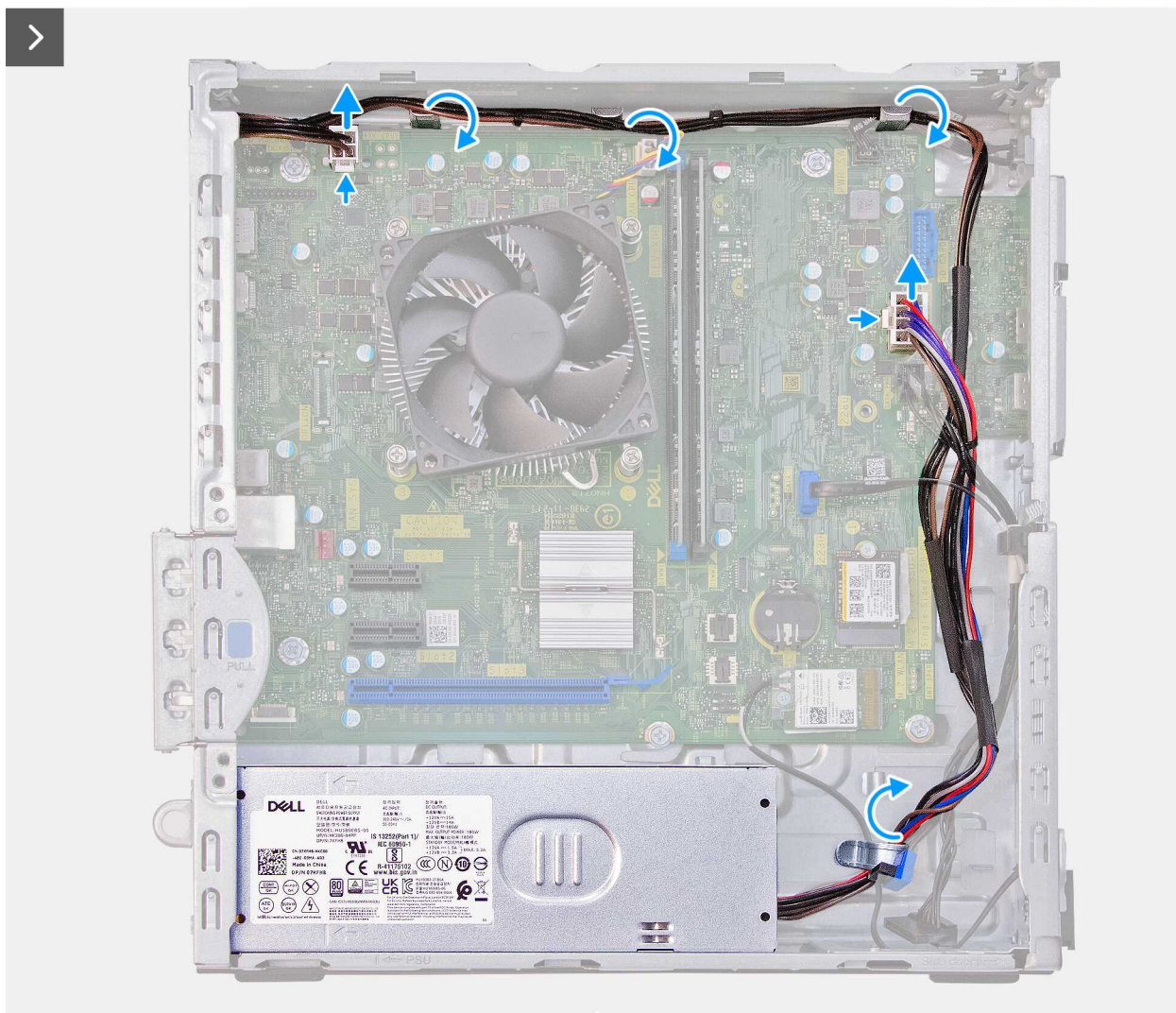
Rysunek 33. Wymontowywanie zasilacza
