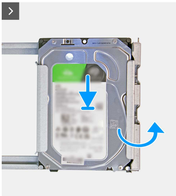
Rysunek 22. Instalowanie dysku twardego
