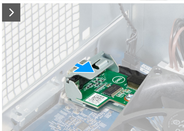
Rysunek 41. Wymontowywanie modułu portu szeregowego
