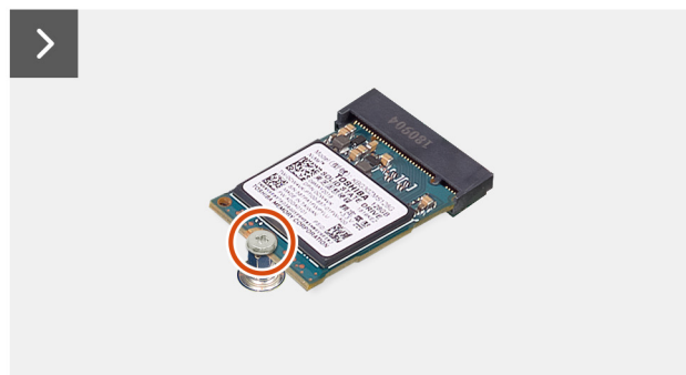
Rysunek 22. Wymontowywanie dysku SSD M.2 2230
