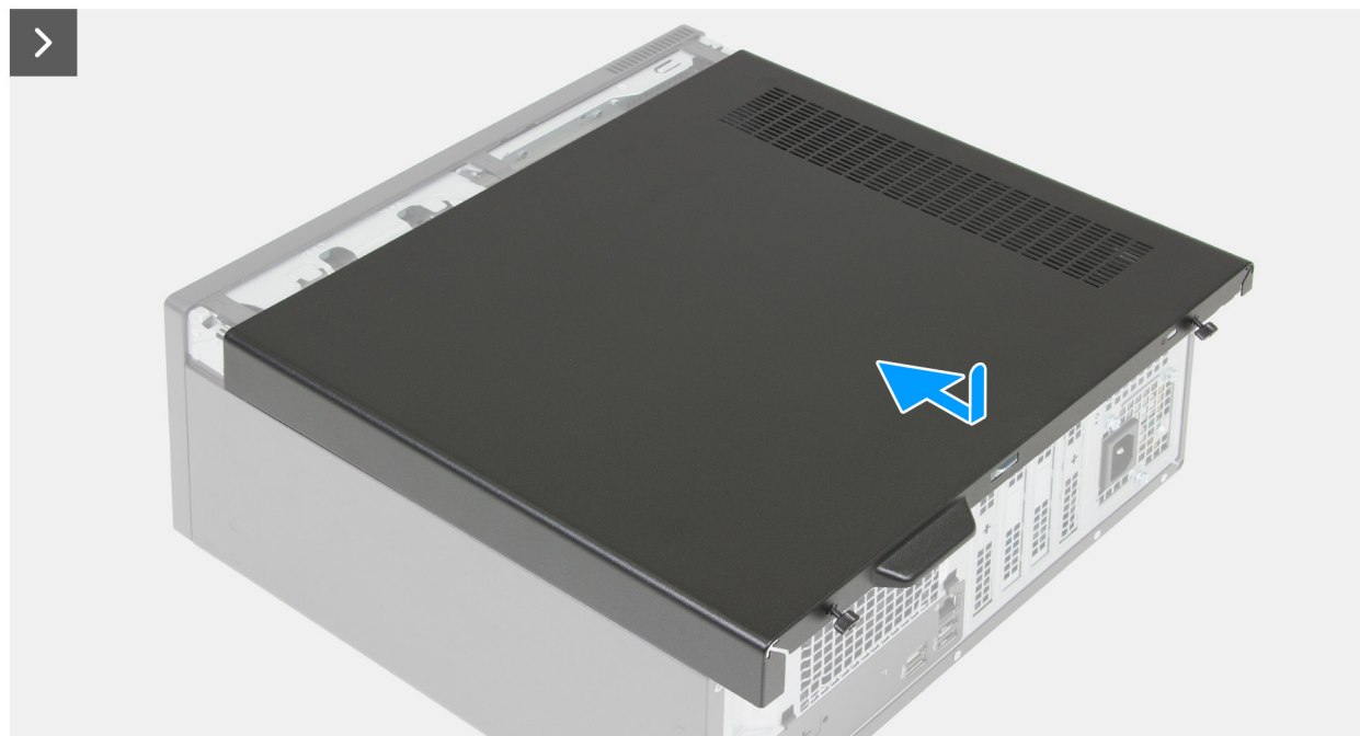
Rysunek 12. Instalowanie lewej pokrywy bocznej
