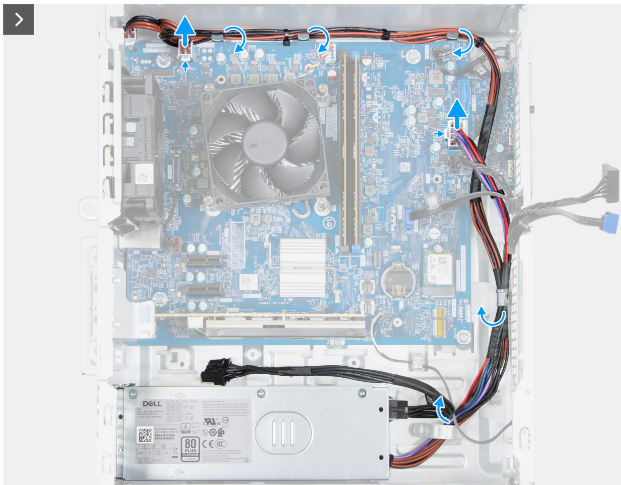
Rysunek 46. Wymontowywanie zasilacza
