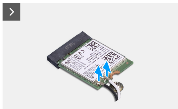
Rysunek 23. Wymontowywanie karty sieci bezprzewodowej
