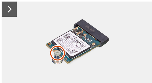
Rysunek 28. Wymontowywanie dysku SSD M.2 2230 z gniazda M.2 nr 1
