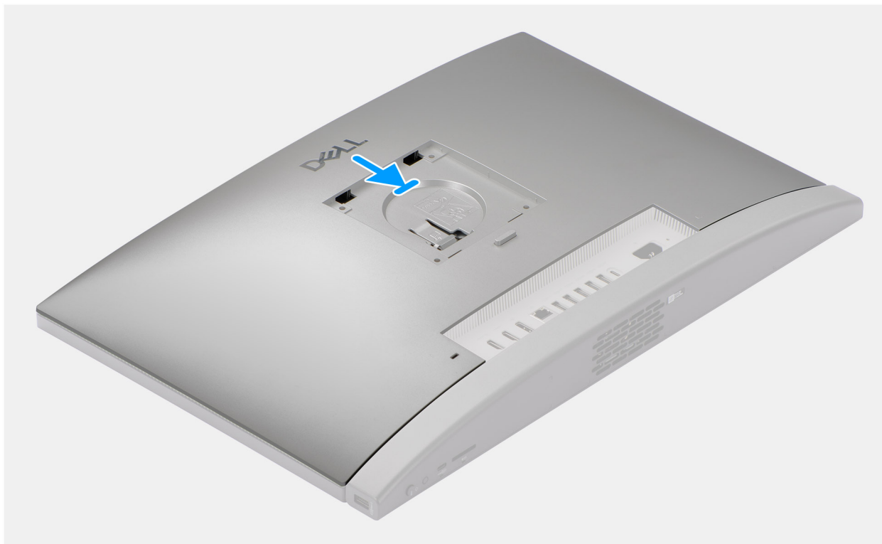
Rysunek 22. Instalowanie pokrywy tylnej
