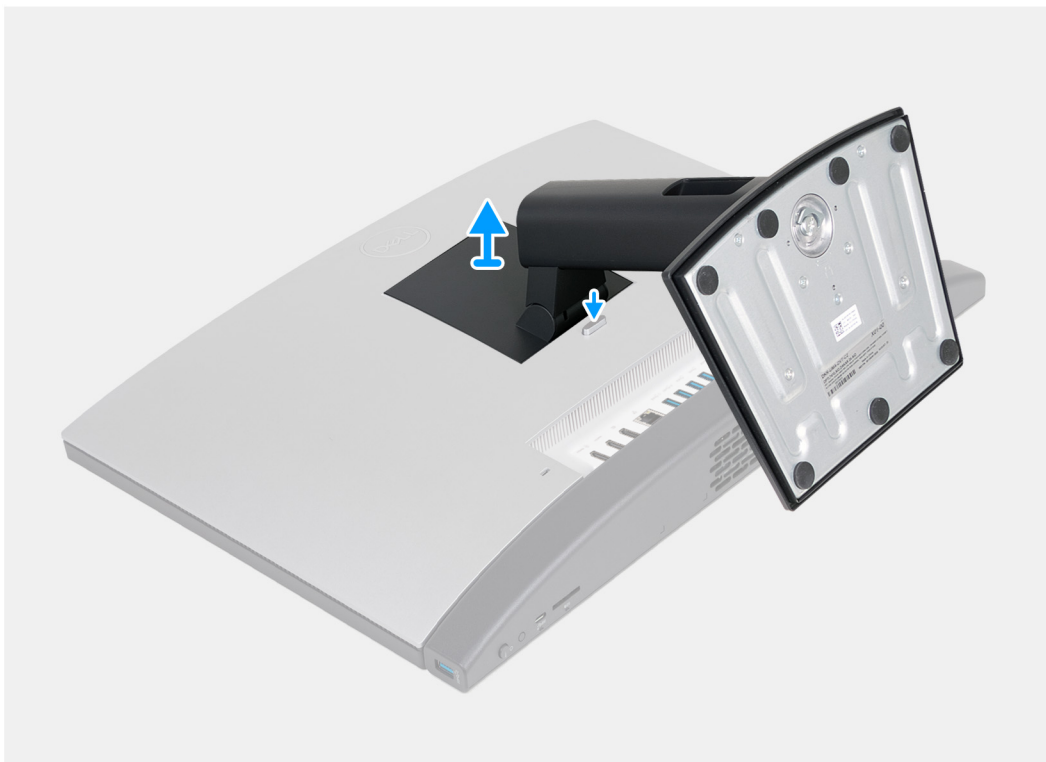
Rysunek 17. Wymontowywanie podstawy stałej
