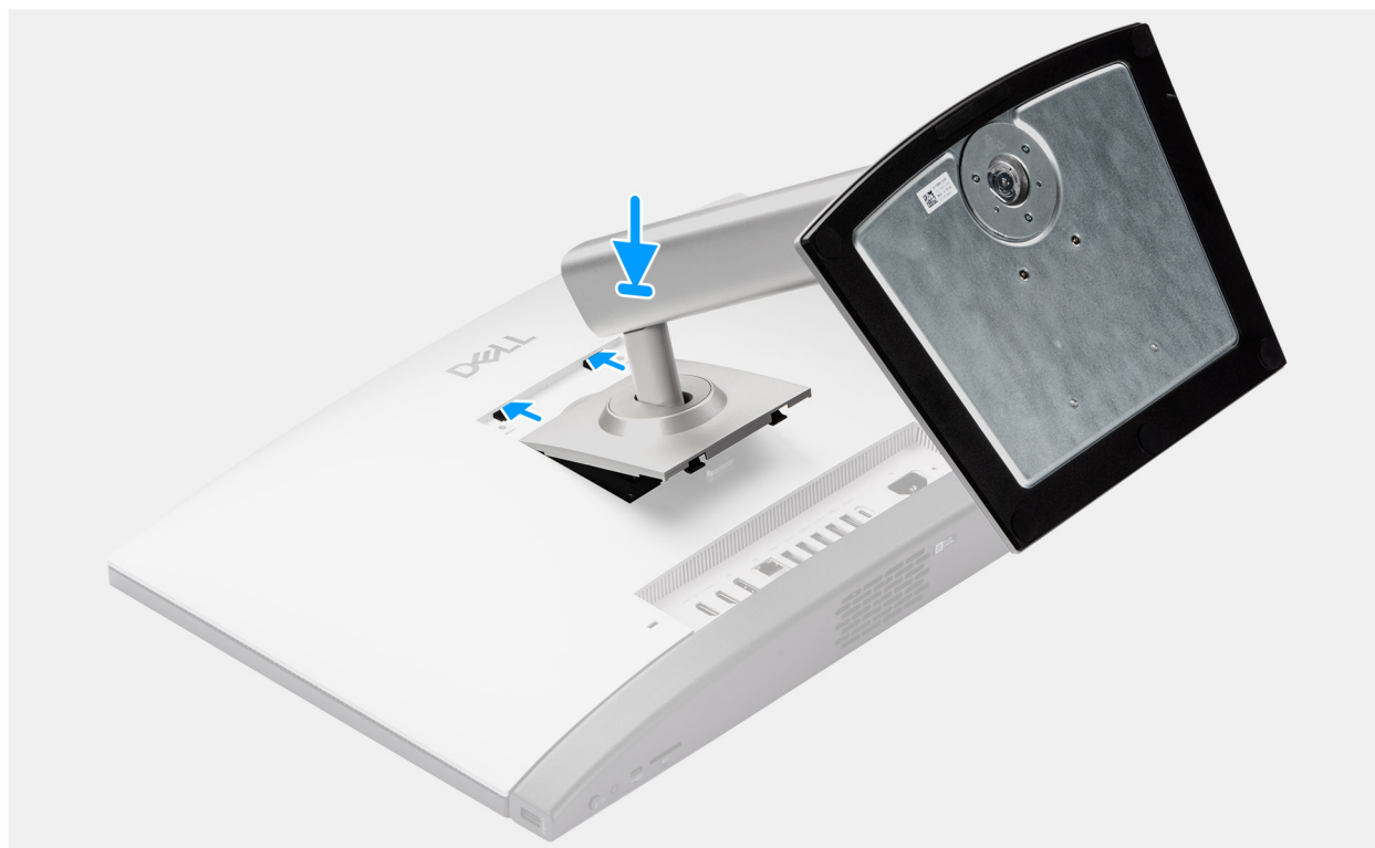
Rysunek 18. Instalowanie podstawy o regulowanej wysokości
