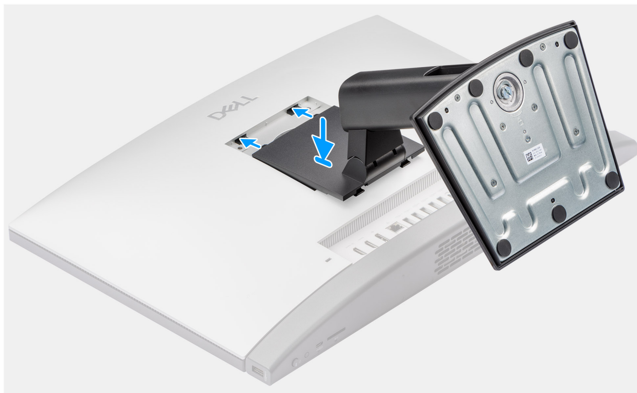
Rysunek 20. Instalowanie podstawy stałej
