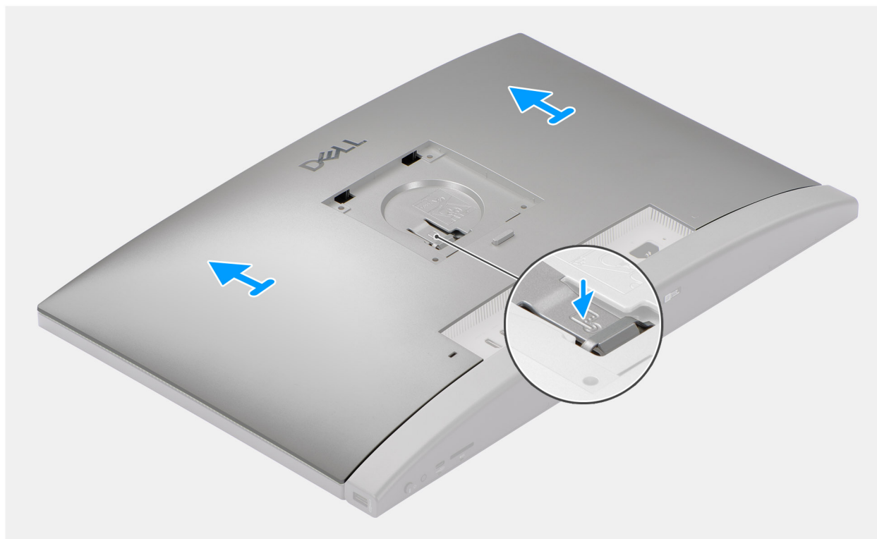
Rysunek 21. Wymontowywanie pokrywy tylnej
