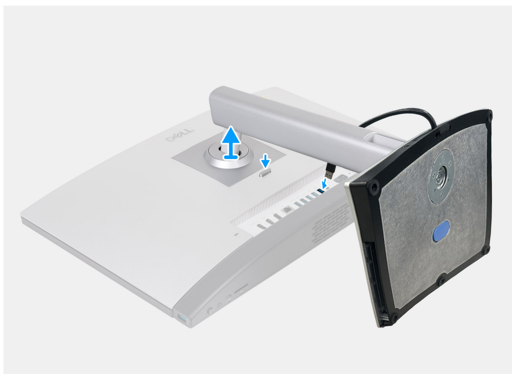
Rysunek 16. Wymontowywanie podstawy o regulowanej wysokości (HAS) z napędem optycznym
