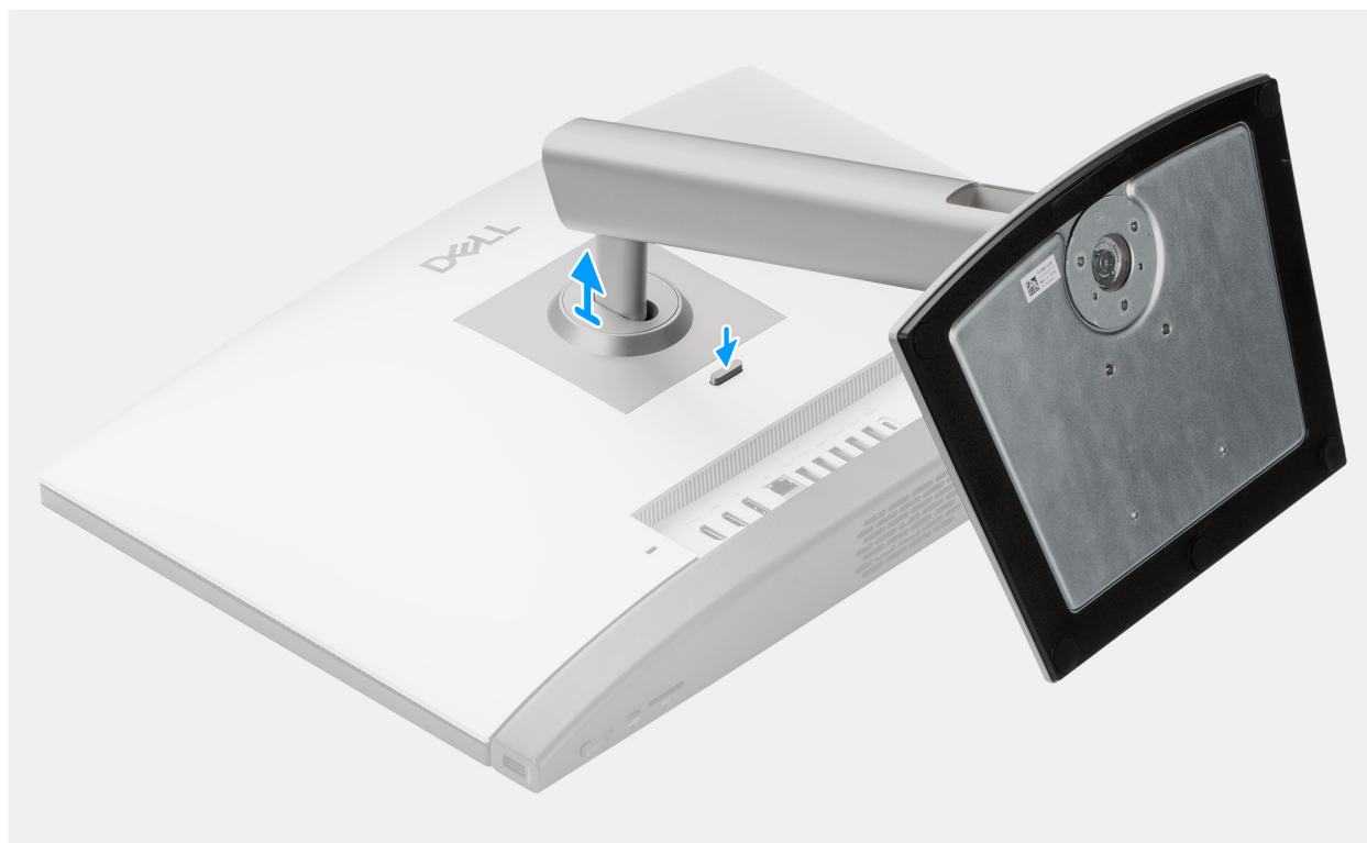
Rysunek 15. Wymontowywanie podstawy o regulowanej wysokości
