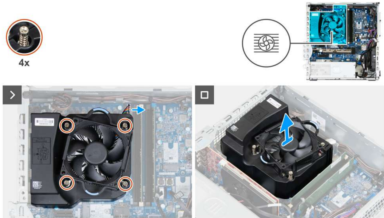
Rysunek 75. Wymontowywanie zestawu wentylatora i radiatora procesora (Dell Pro Slim Plus QBS1250 XE5)
