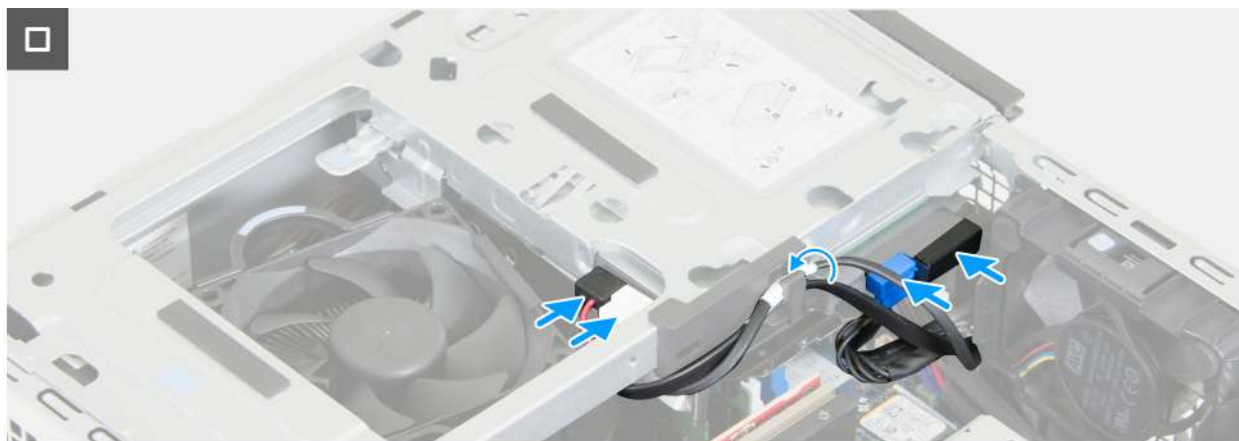
Rysunek 52. Instalowanie wnęki na dysk
