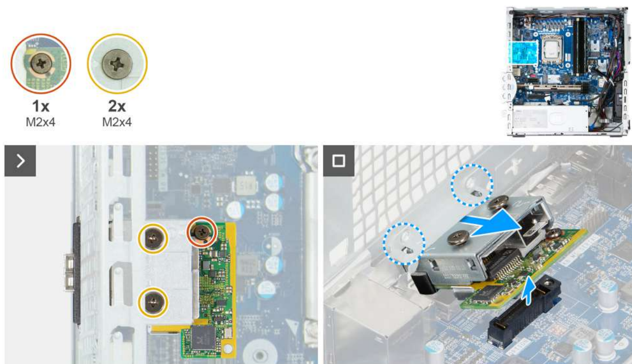
Rysunek 81. Wymontowywanie modułu portu światłowodowego
