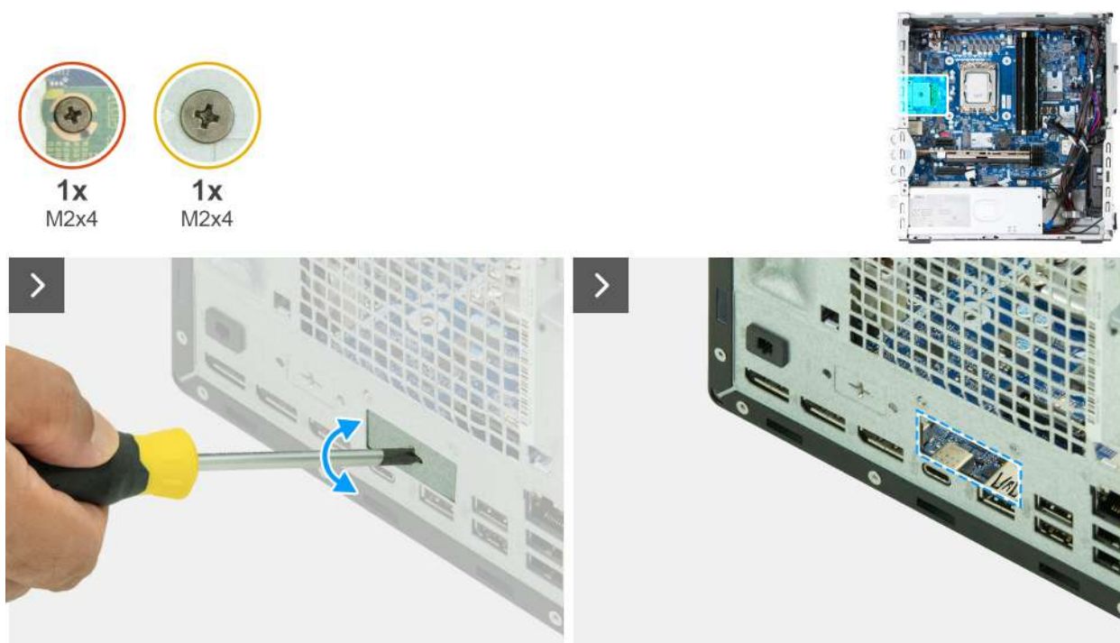
Rysunek 79. Instalowanie modułu opcjonalnego portu
