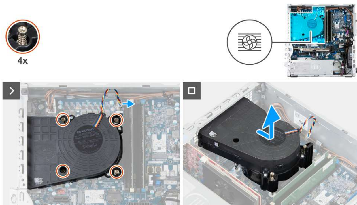
Rysunek 74. Wymontowywanie zestawu wentylatora i radiatora procesora (Dell Pro Slim Plus QBS1250)
