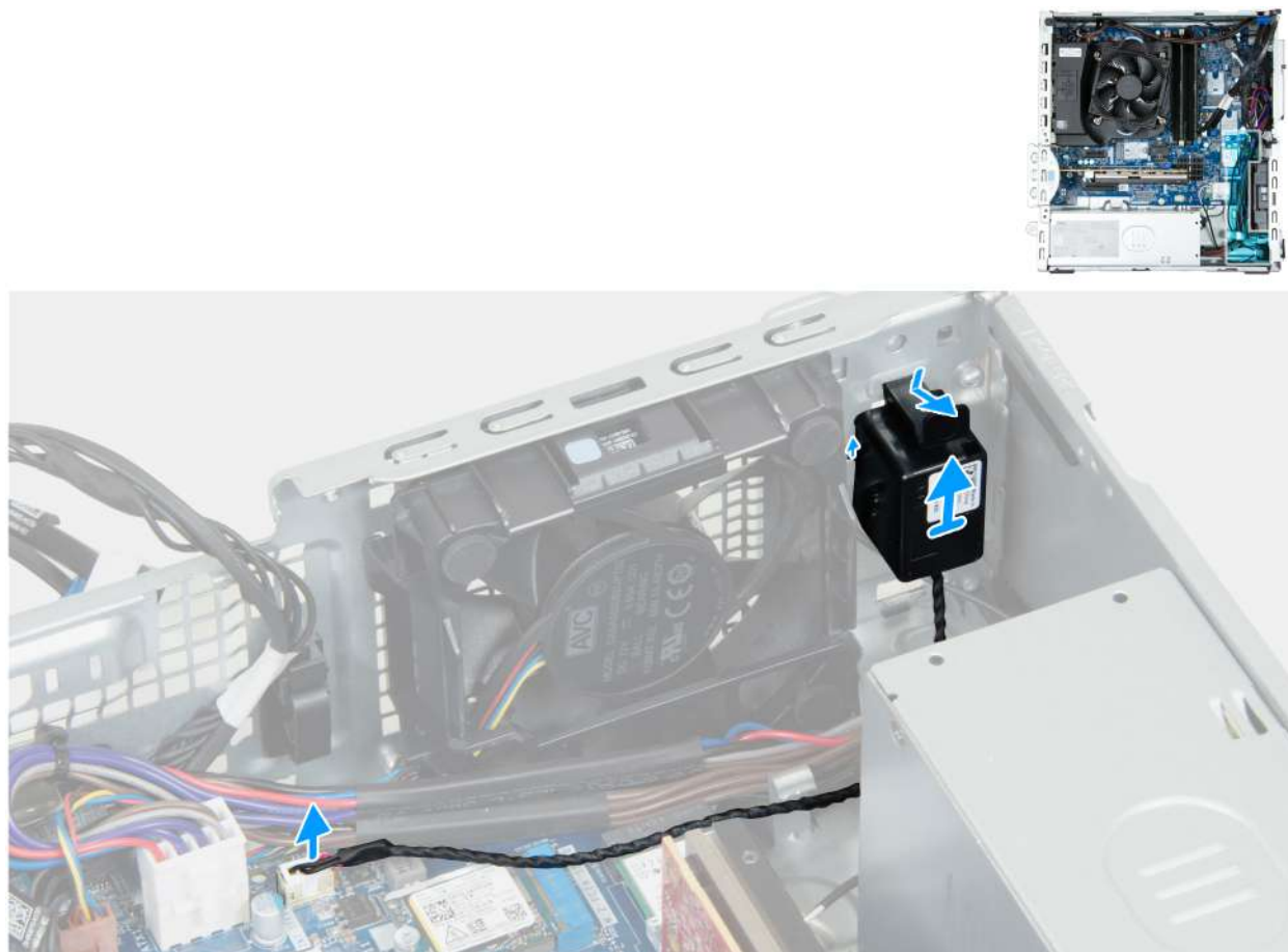
Rysunek 18. Wymontowywanie głośnika wewnętrznego
