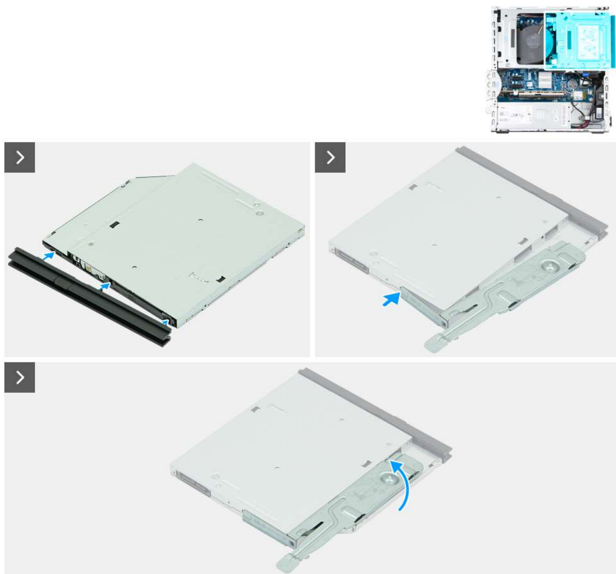
Rysunek 47. Instalowanie napędu optycznego
