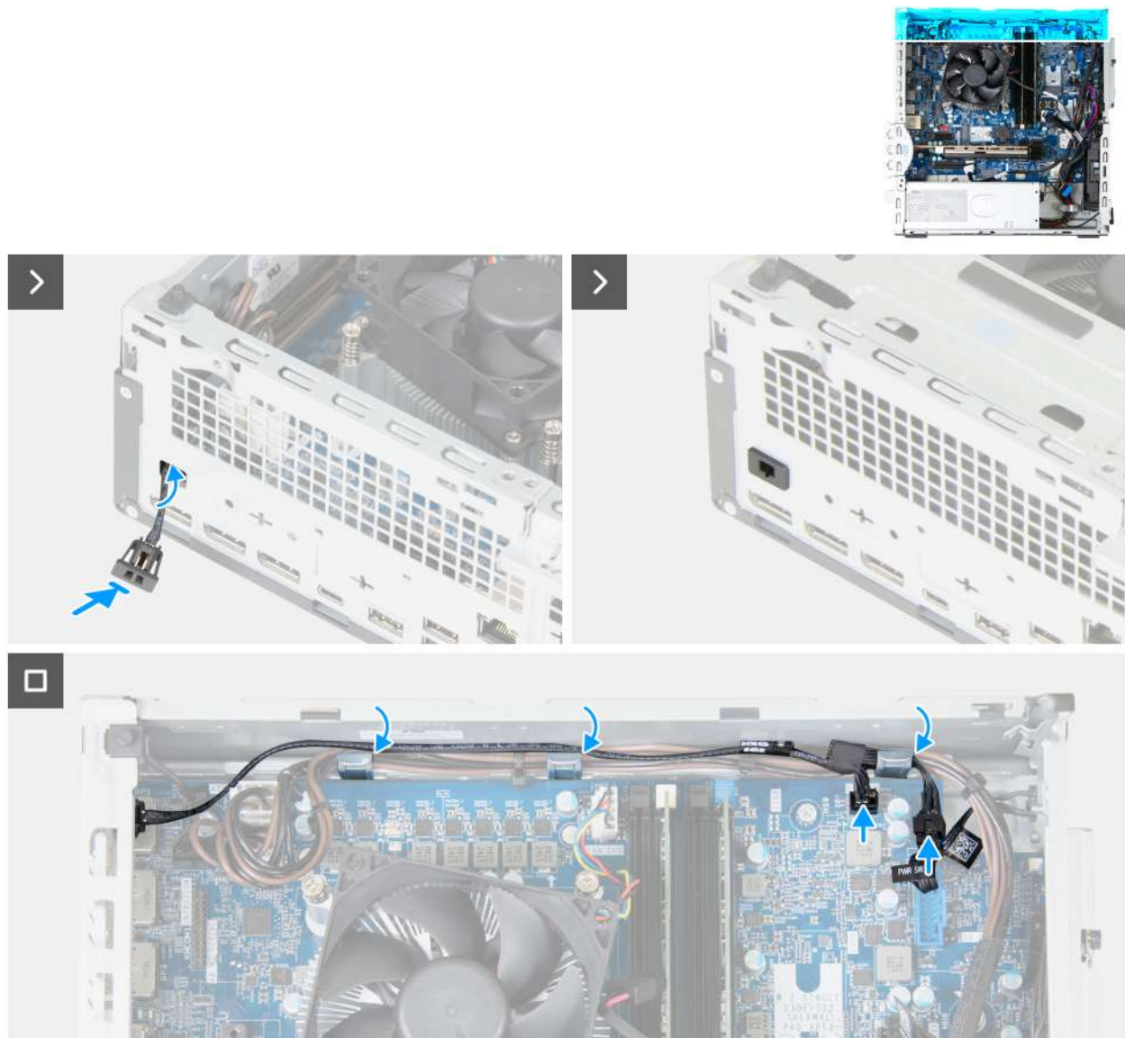
Rysunek 60. Instalowanie zdalnego przełącznika zasilania
