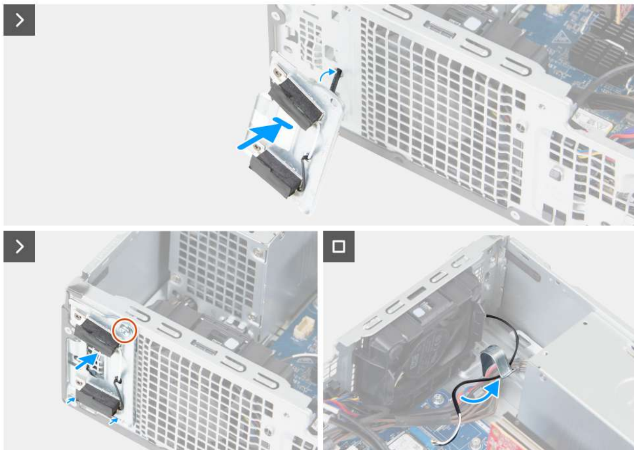
Rysunek 69. Instalowanie modułów anten
