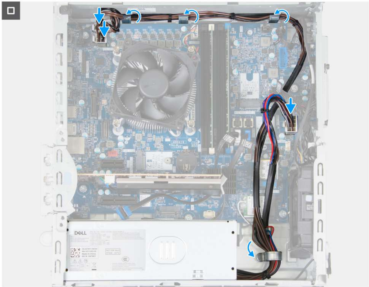
Rysunek 73. Instalowanie zasilacza
