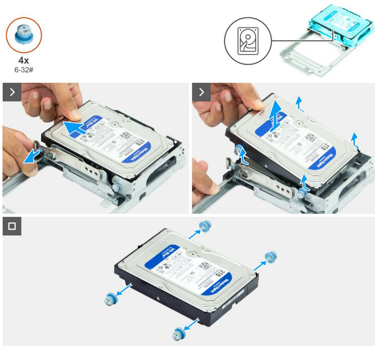
Rysunek 53. Wymontowywanie dysku twardego
