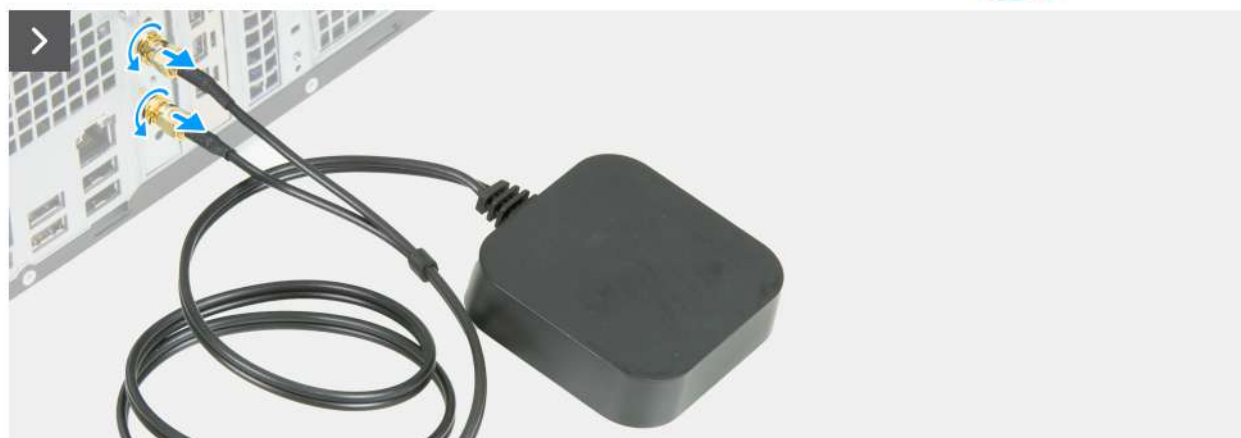
Rysunek 41. Wymontowywanie karty rozszerzenia anteny krążkowej
