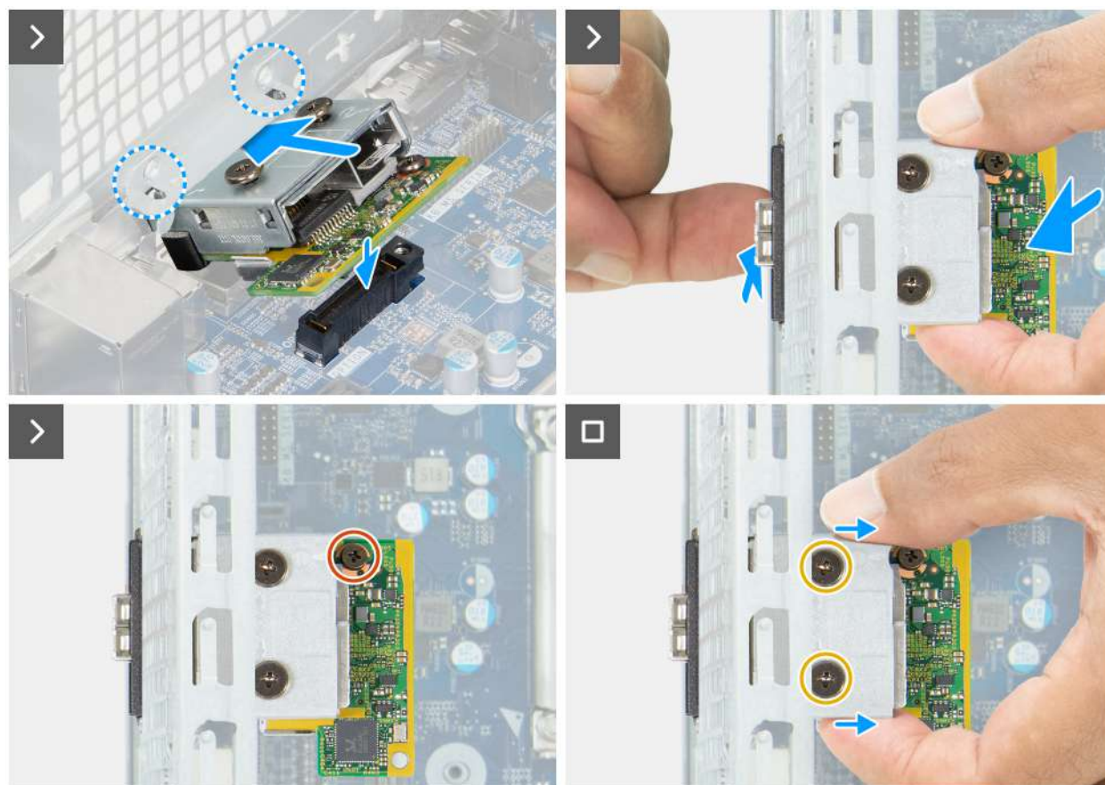
Rysunek 83. Instalowanie modułu portu światłowodowego
