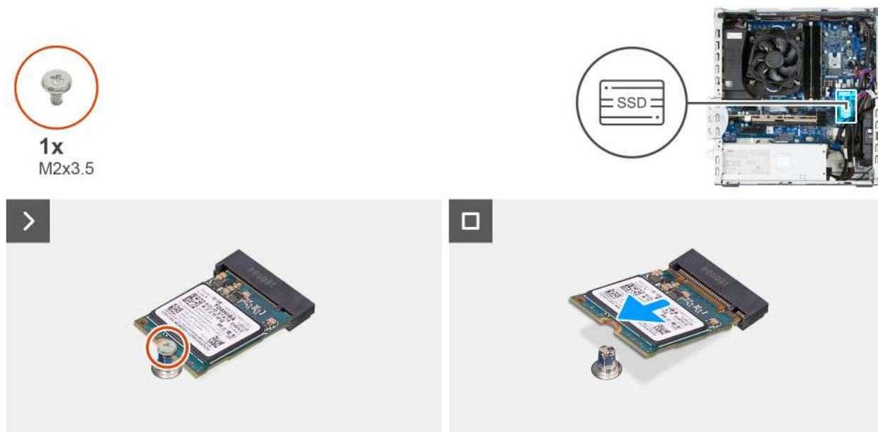
Rysunek 22. Wymontowywanie dysku SSD M.2 2230 z gniazda 0
