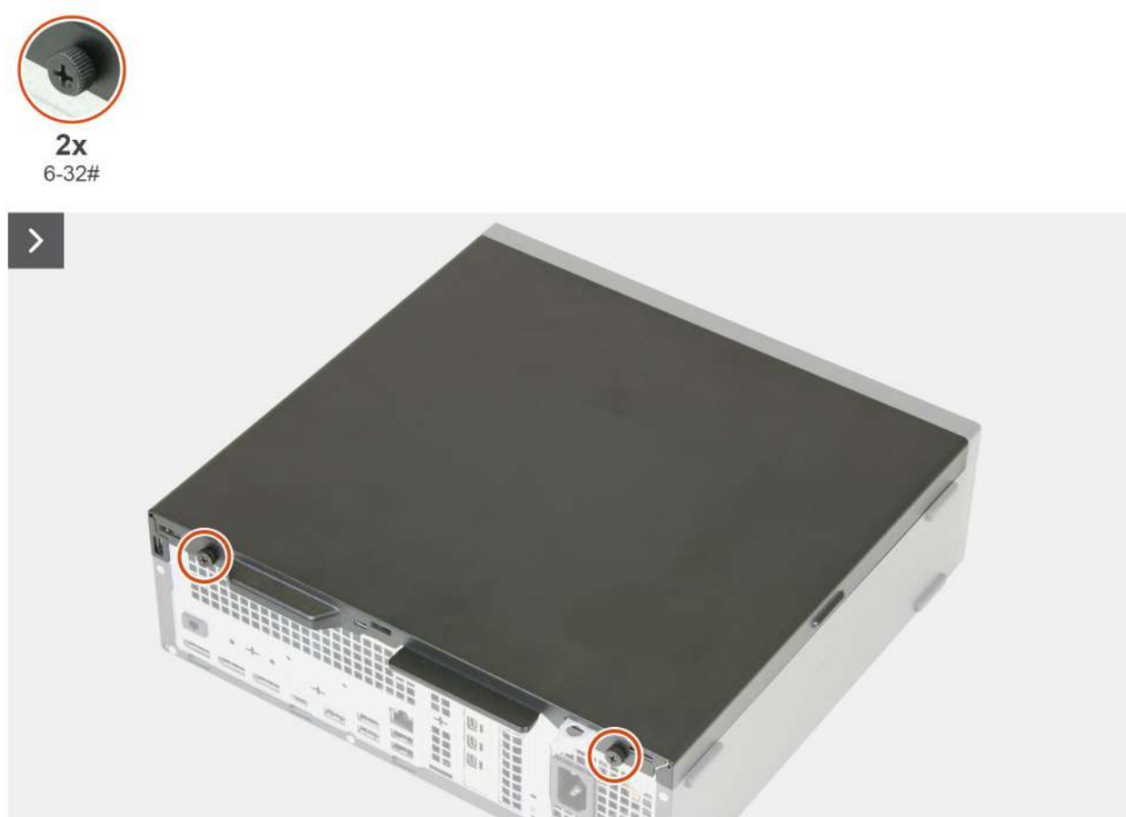
Rysunek 6. Wymontowywanie pokrywy bocznej
