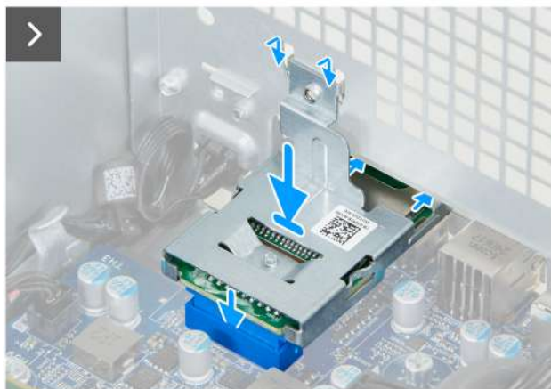
Rysunek 67. Instalowanie czytnika kart pamięci
