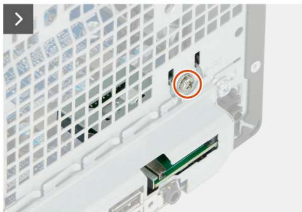
Rysunek 66. Wymontowywanie czytnika kart pamięci
