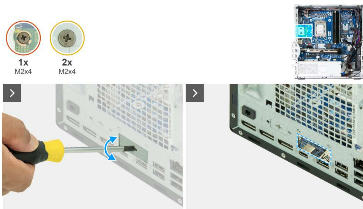
Rysunek 82. Instalowanie modułu portu światłowodowego
