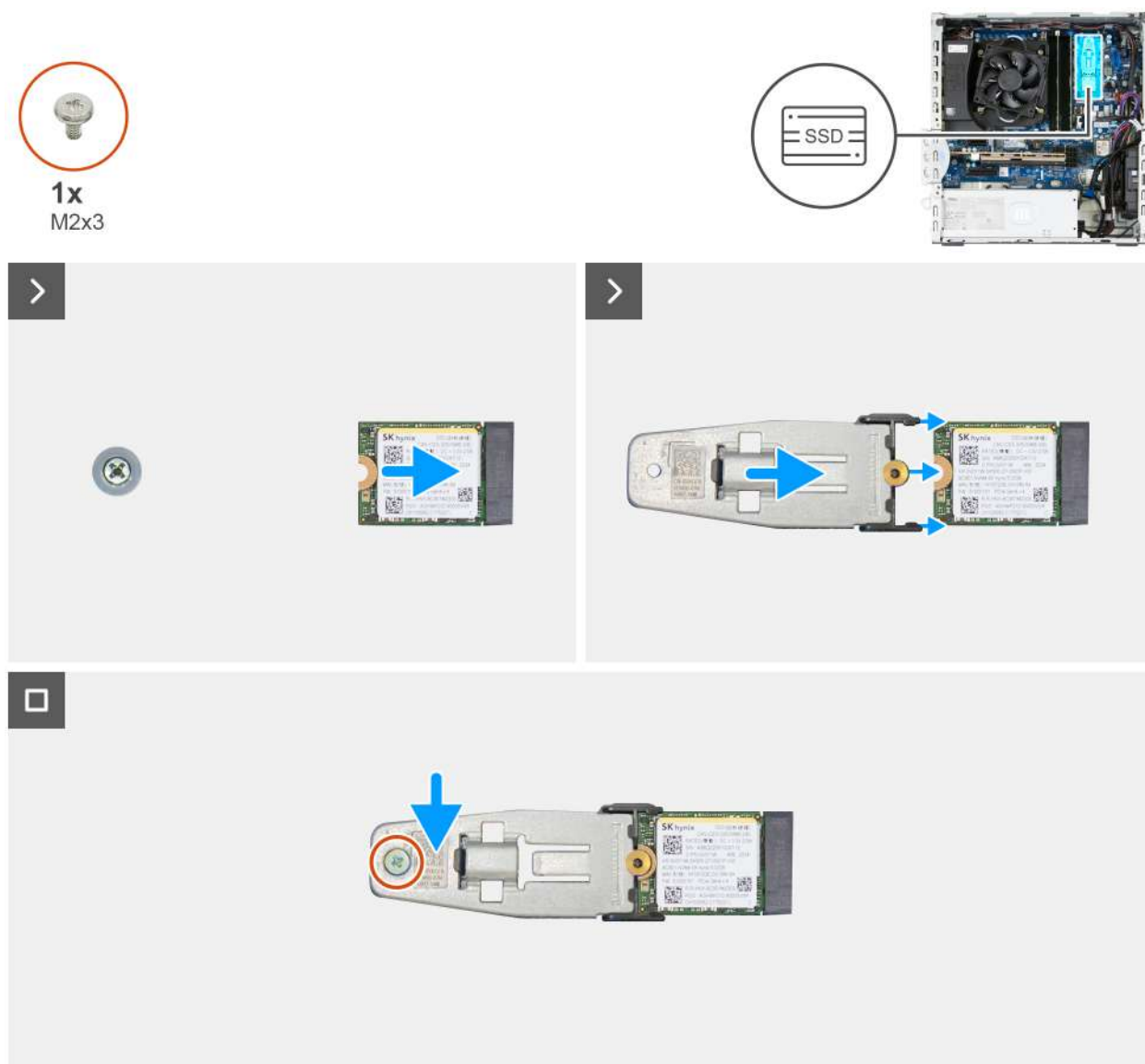
Rysunek 30. Instalowanie dysku SSD M.2 2230 w drugim gnieździe
