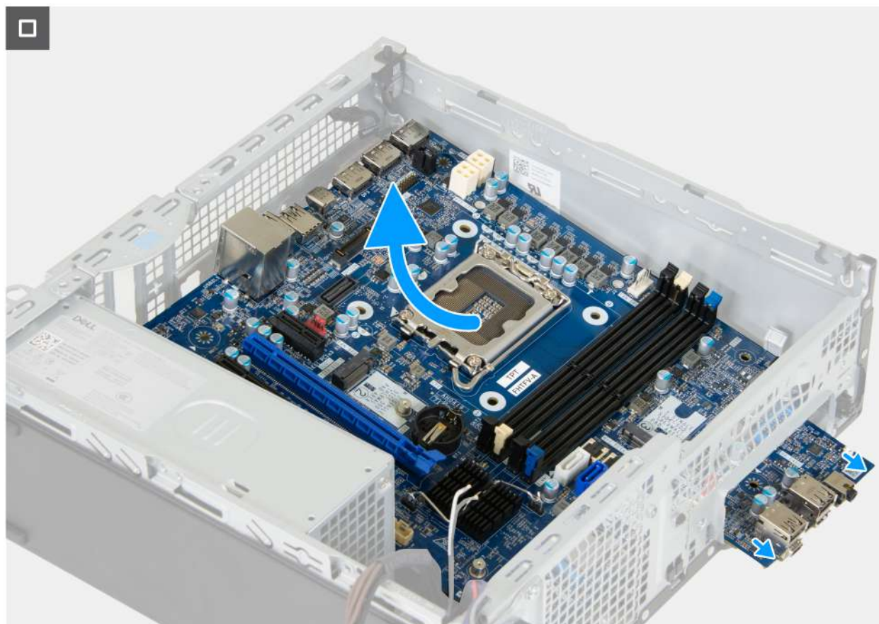
Rysunek 90. Wymontowywanie płyty systemowej
