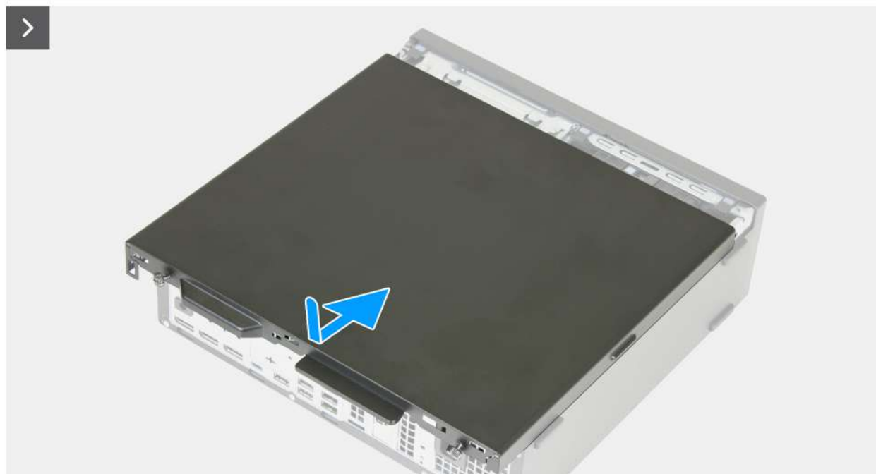
Rysunek 8. Instalowanie pokrywy bocznej
