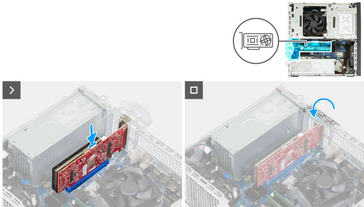
Rysunek 34. Instalowanie karty graficznej
