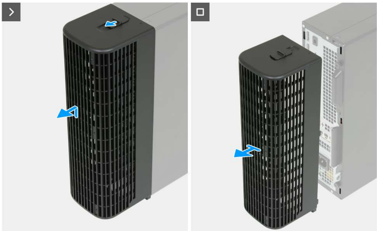
Rysunek 4. Wymontowywanie osłony kabli
