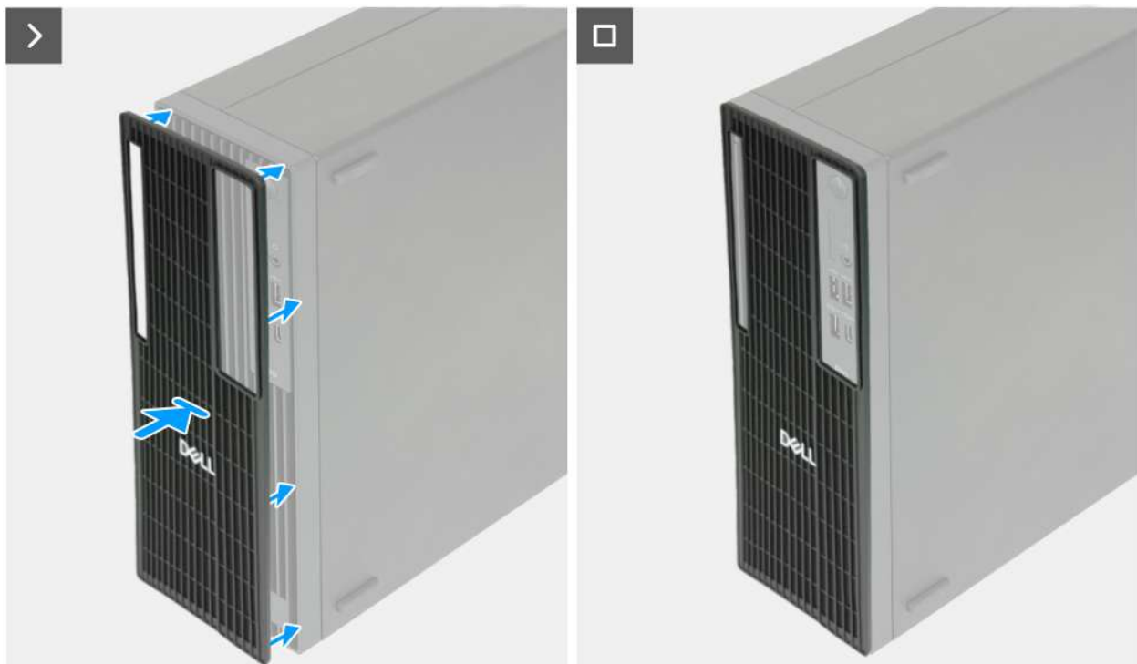
Rysunek 15. Instalowanie filtra przeciwpyłowego
