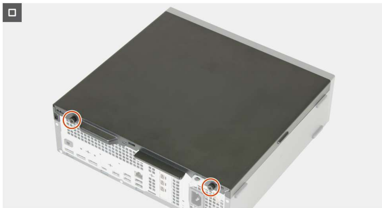
Rysunek 9. Instalowanie pokrywy bocznej
