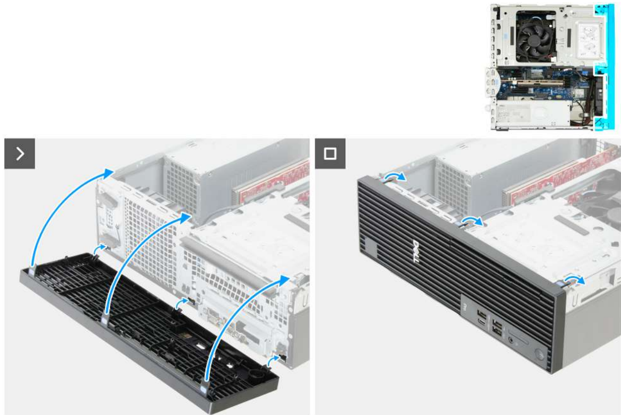
Rysunek 17. Instalowanie pokrywy przedniej
