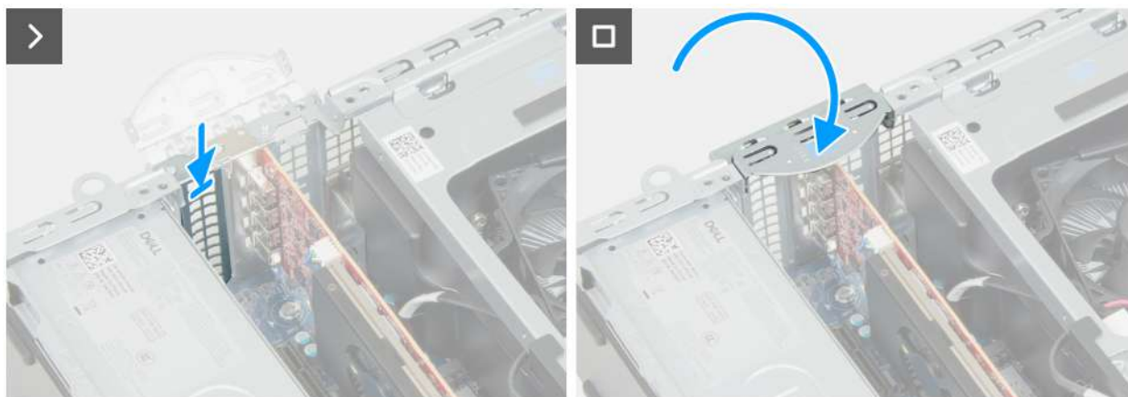
Rysunek 38. Wymontowywanie karty rozszerzeń SSD
