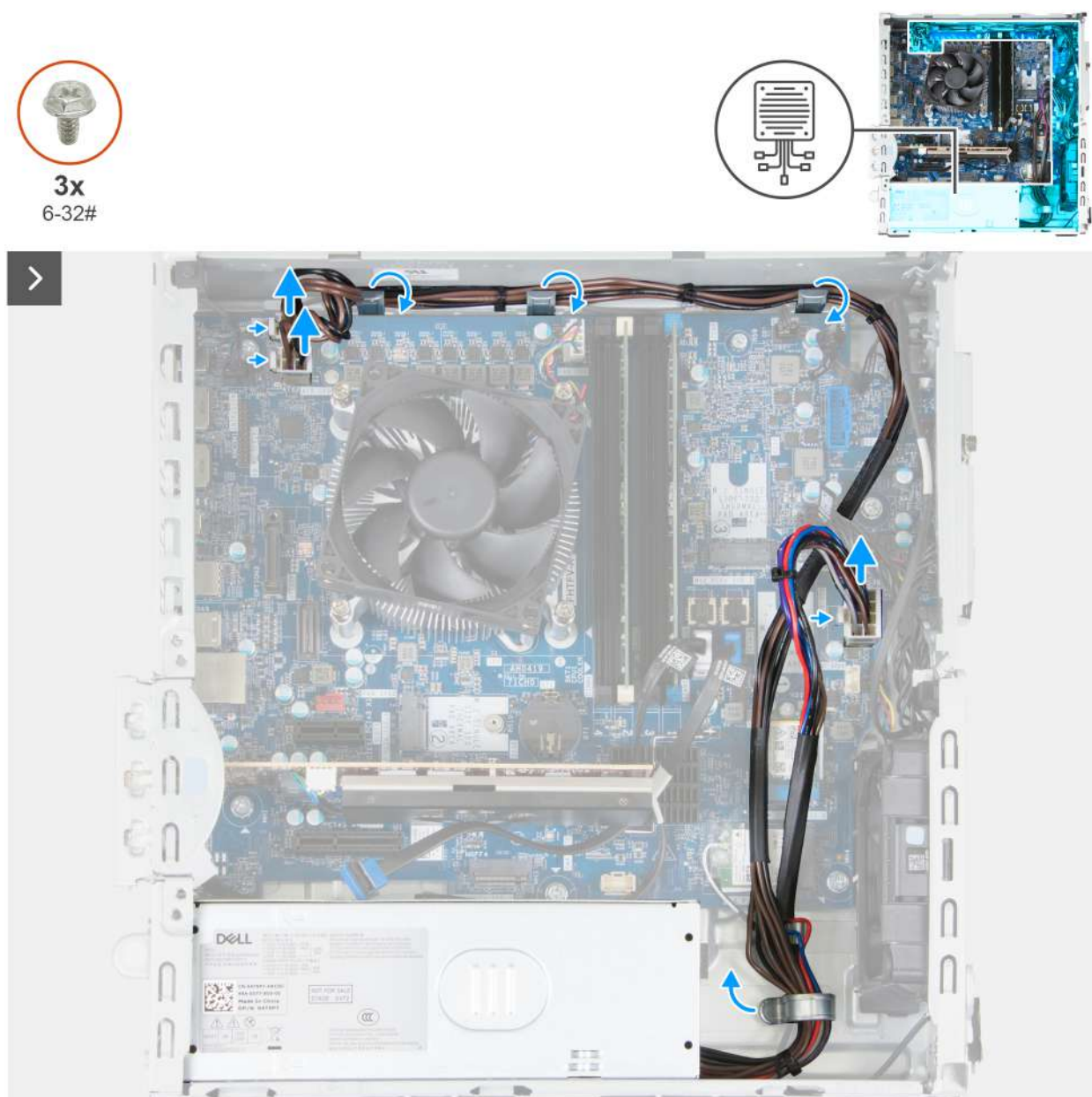
Rysunek 70. Instalowanie zasilacza
