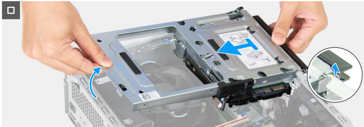
Rysunek 50. Wyjmowanie wnęki na dysk
