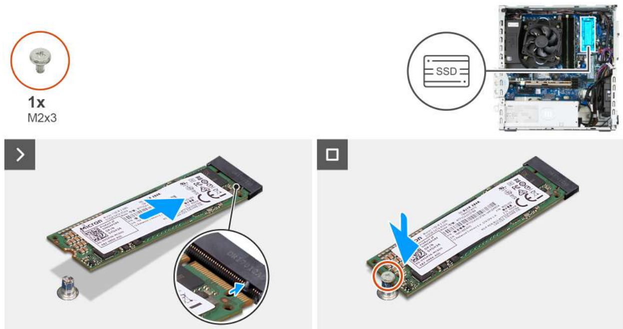
Rysunek 32. Instalowanie dysku SSD M.2 2280 w drugim gnieździe
