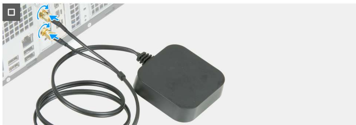
Rysunek 44. Instalowanie karty rozszerzenia anteny krążkowej
