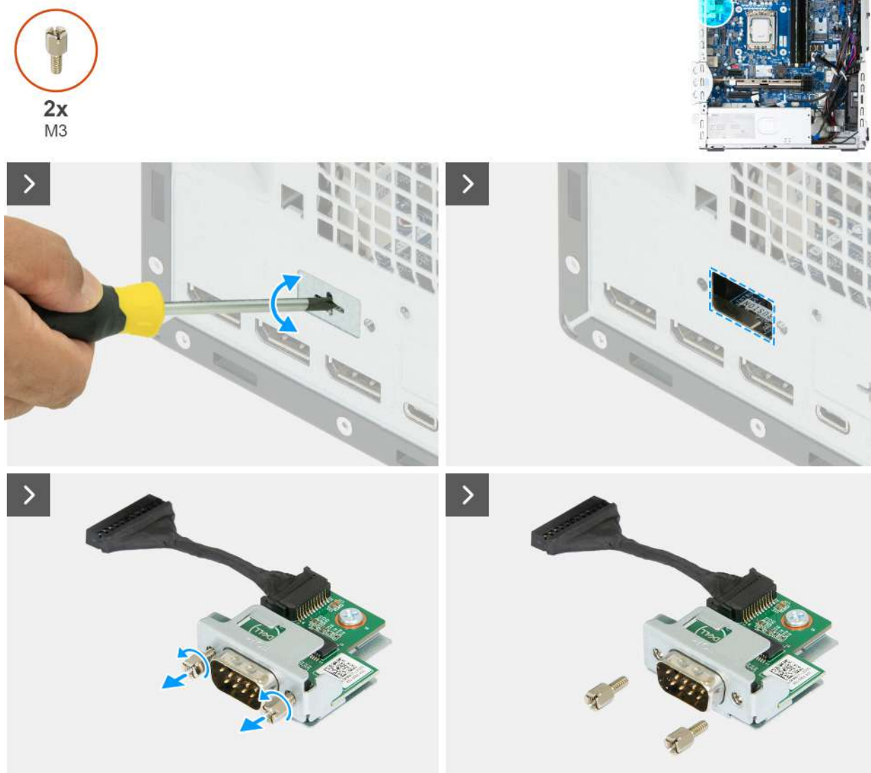
Rysunek 64. Instalowanie modułu portu szeregowego
