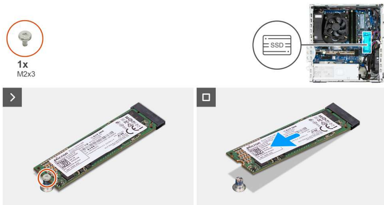
Rysunek 24. Wymontowywanie dysku SSD M.2 2280 z gniazda 0
