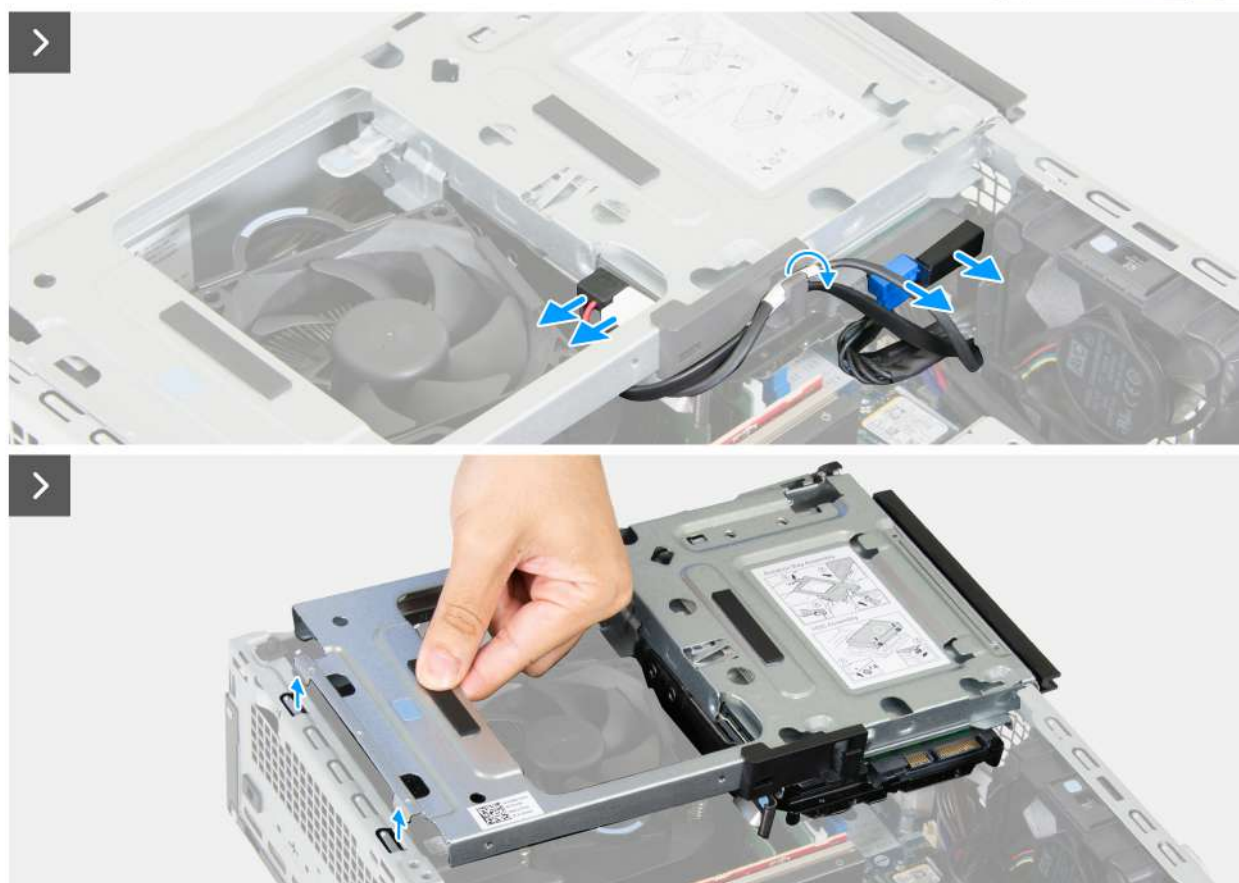
Rysunek 49. Wymowanie wnęki na dysk
