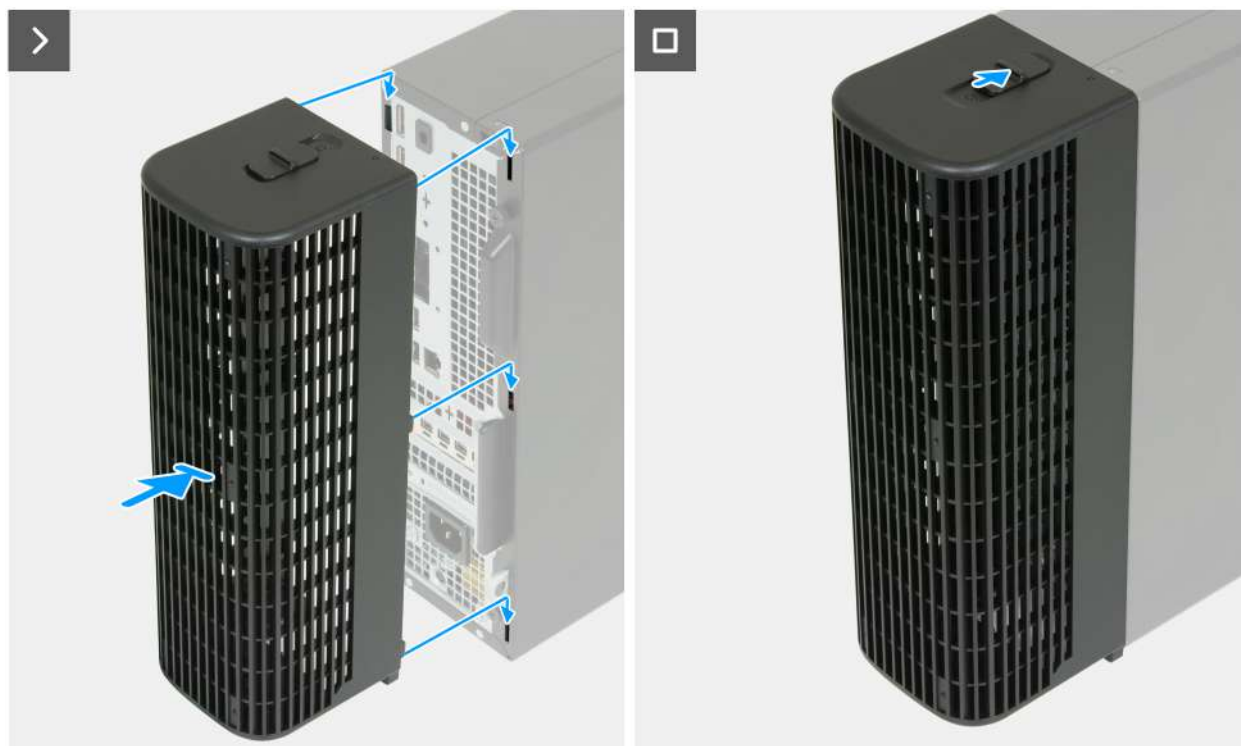
Rysunek 5. Instalowanie osłony kabli
