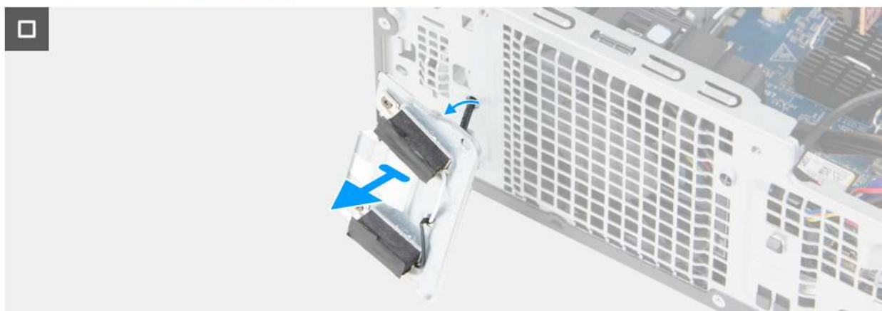
Rysunek 68. Wymontowywanie modułów anten
