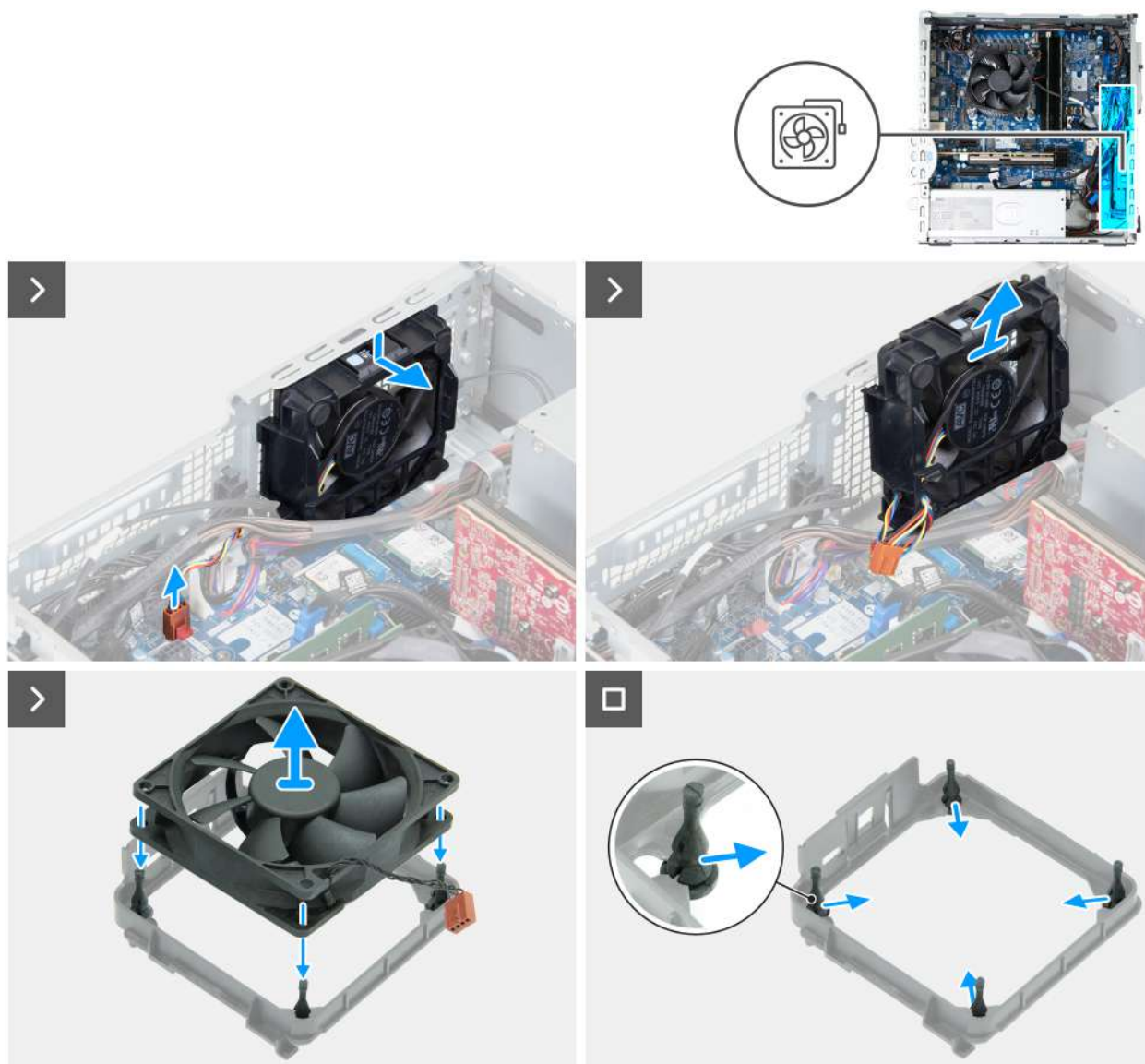
Rysunek 57. Wymontowywanie wentylatora
