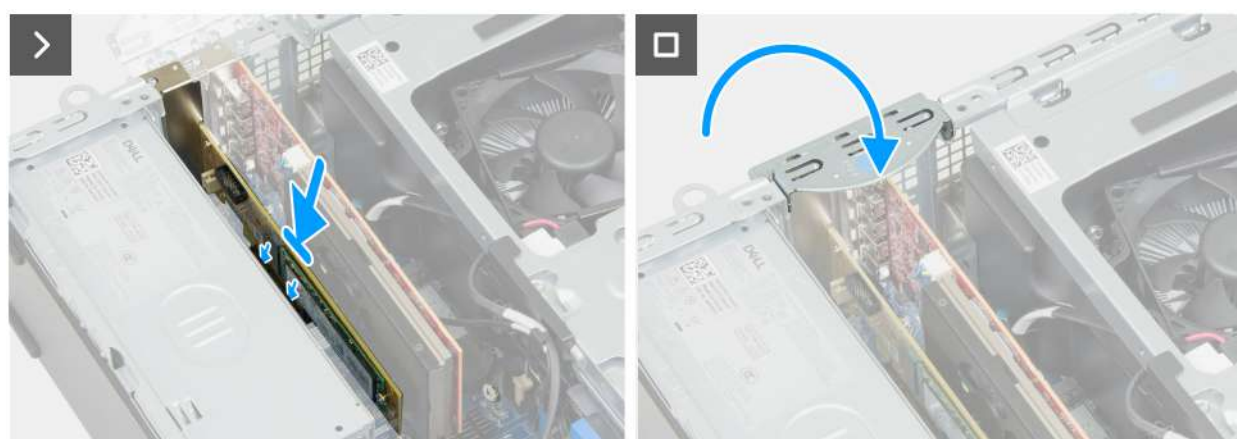
Rysunek 40. Instalowanie karty rozszerzeń SSD
