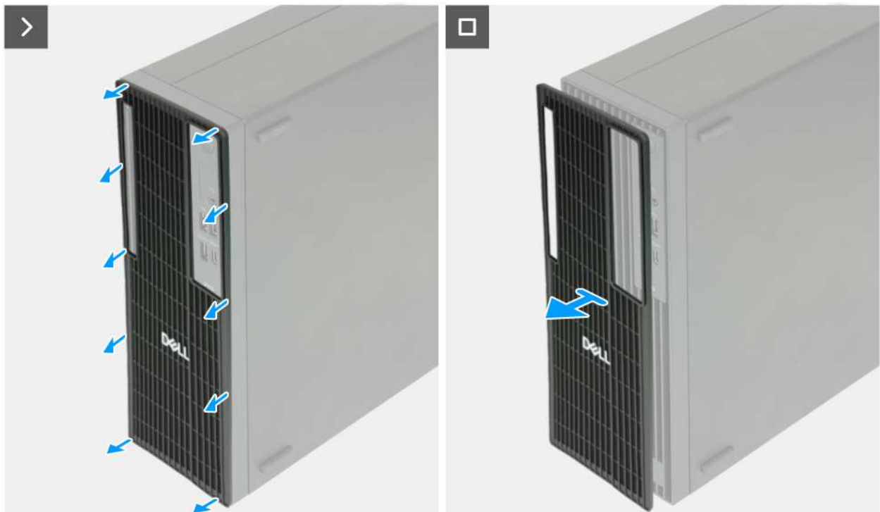
Rysunek 14. Wymontowywanie filtra przeciwpylowego
