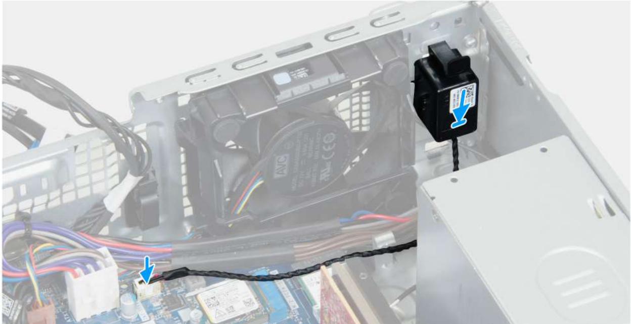
Rysunek 19. Instalowanie głośnika wewnętrznego
