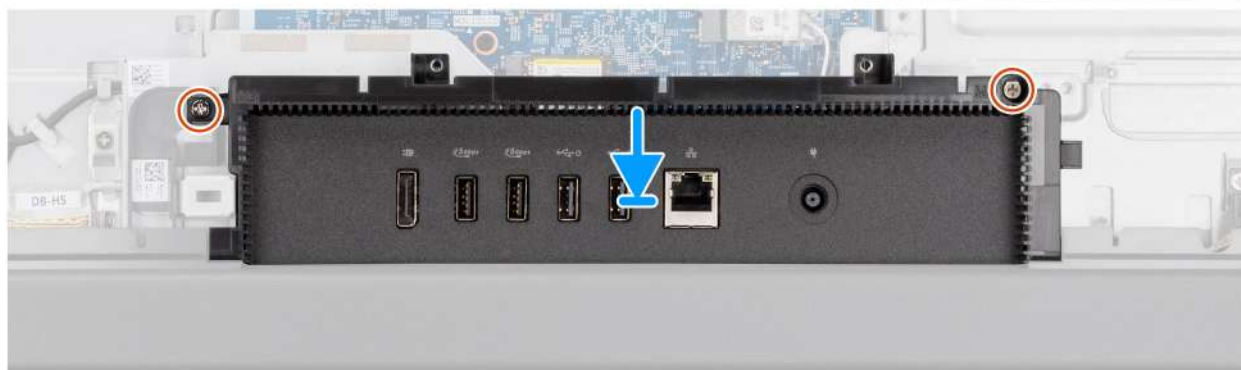
Rysunek 31. Instalowanie pokrywy złączy we/wy
