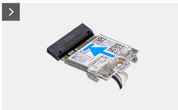
Rysunek 24. Instalowanie karty sieci bezprzewodowej
