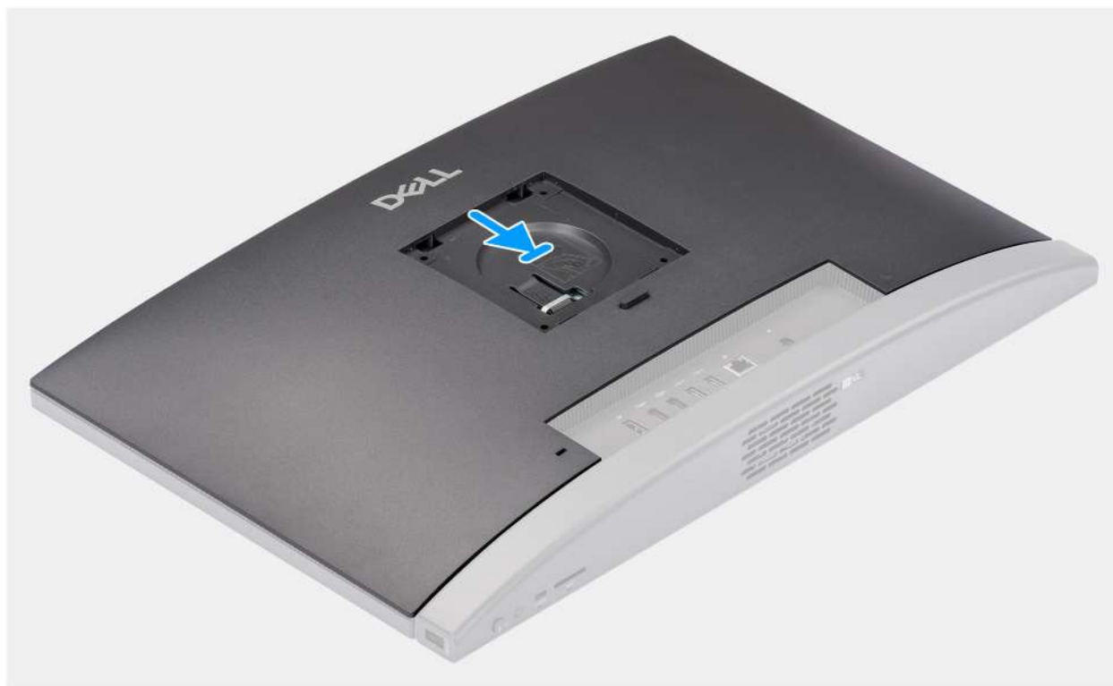
Rysunek 18. Instalowanie pokrywy tylnej
