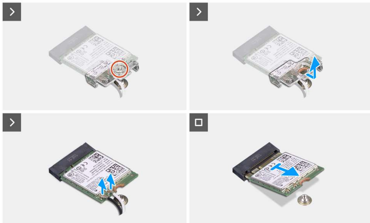
Rysunek 23. Wymontowywanie karty sieci bezprzewodowej
