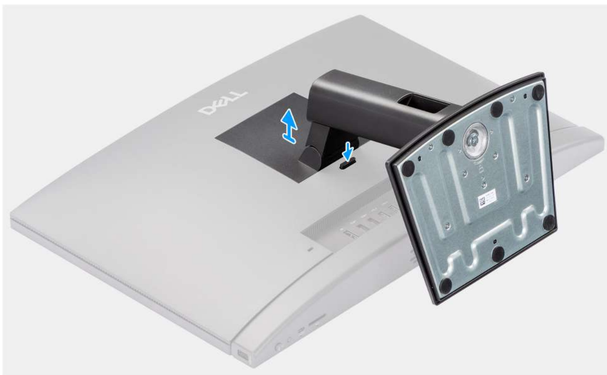
Rysunek 14. Wymontowywanie podstawy stałej
