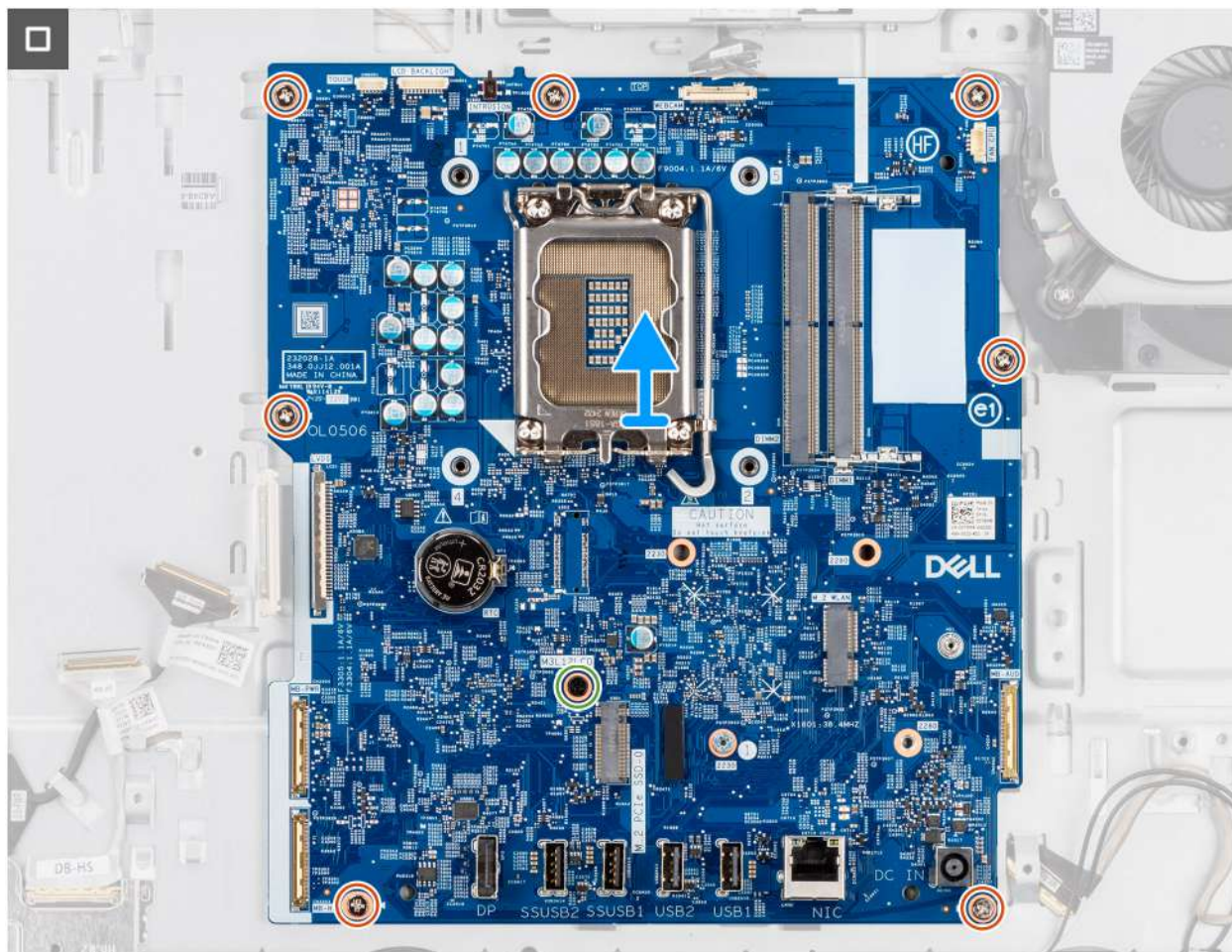
Rysunek 48. Wymontowywanie płyty głównej
