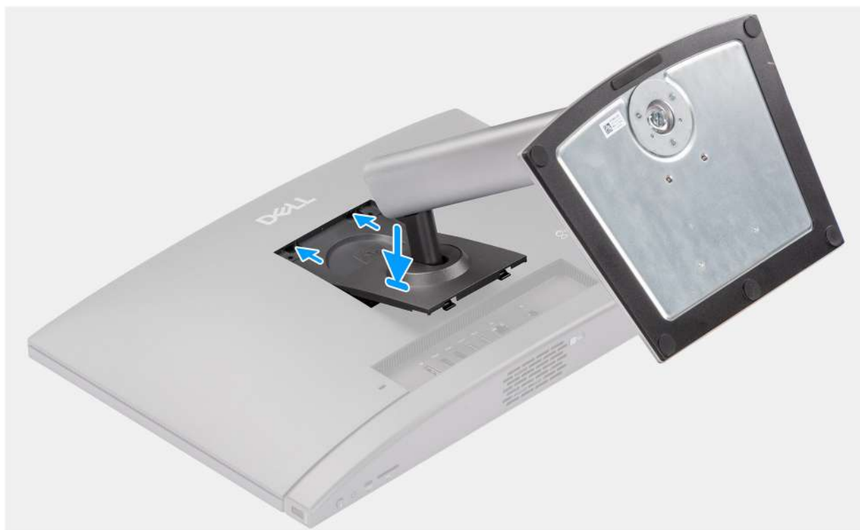
Rysunek 15. Instalowanie podstawy o regulowanej wysokości
