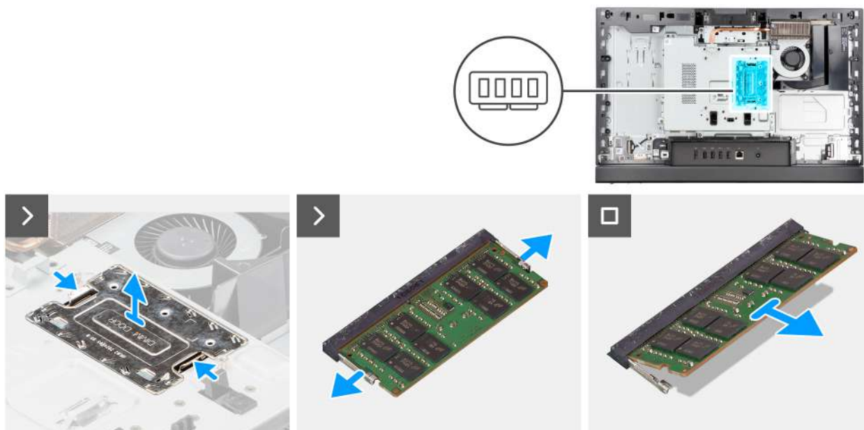
Rysunek 19. Wymontowywanie modułów pamięci
