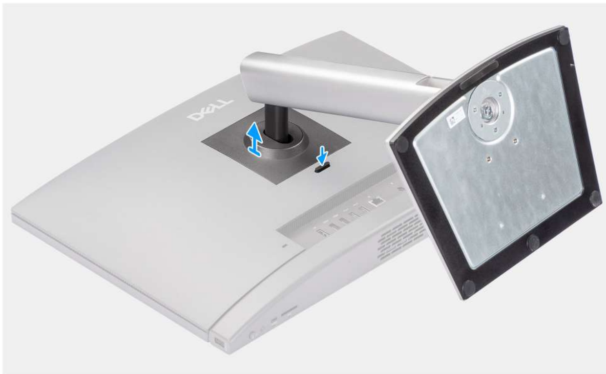
Rysunek 13. Wymontowywanie podstawy o regulowanej wysokości
