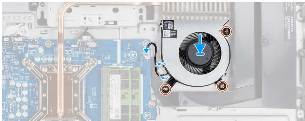
Rysunek 37. Instalowanie wentylatora
