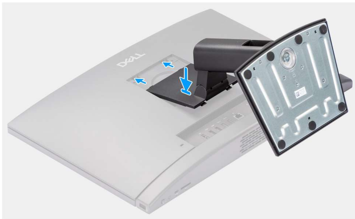
Rysunek 16. Instalowanie podstawy stałej
