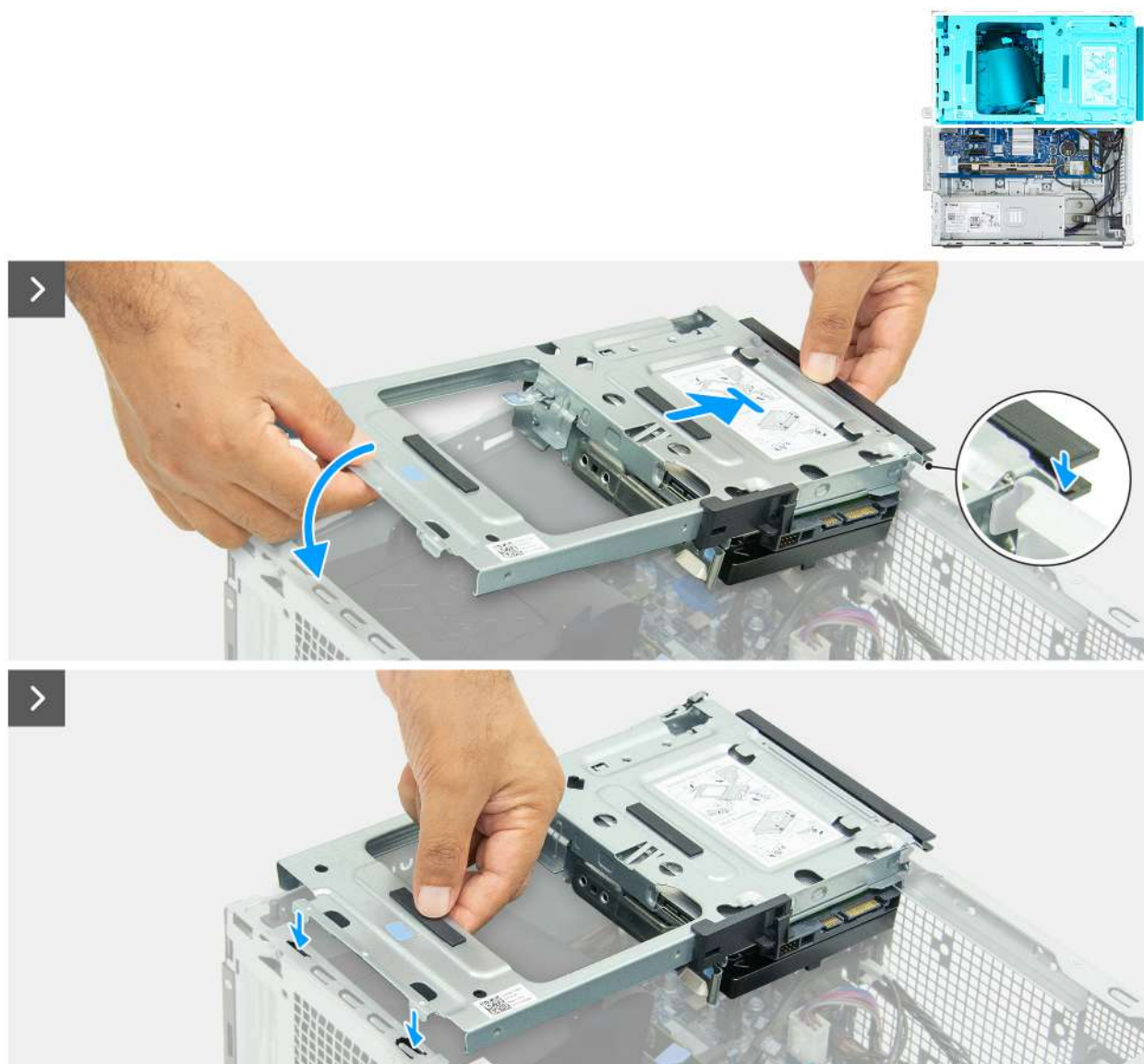
Rysunek 43. Instalowanie wnęki napędu
