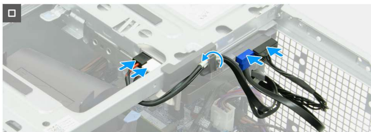
Rysunek 44. Instalowanie wnęki napędu
