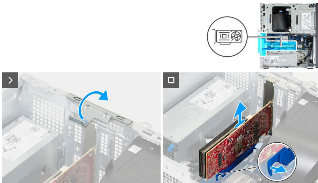
Rysunek 33. Wymontowywanie karty graficznej
