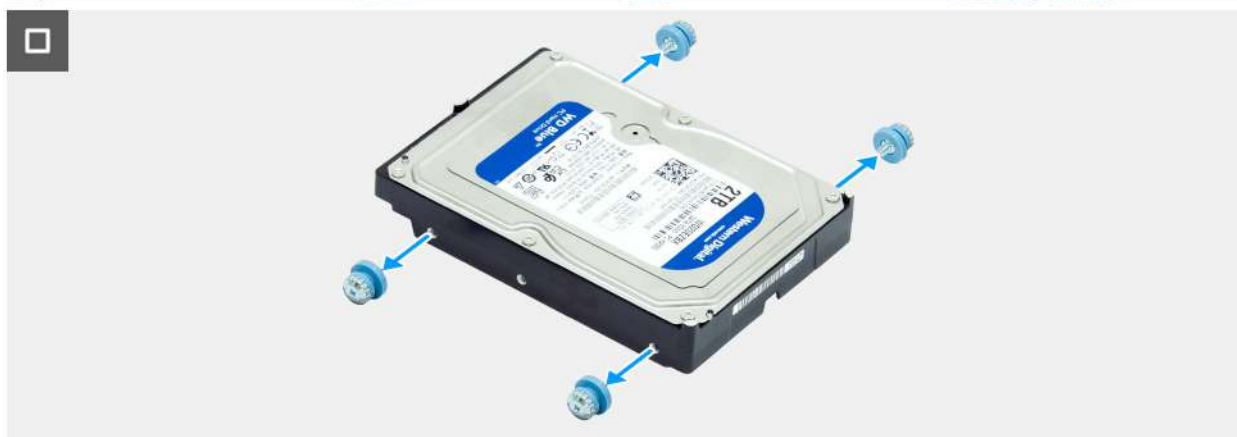
Rysunek 42. Wymontowywanie dysku twardego
