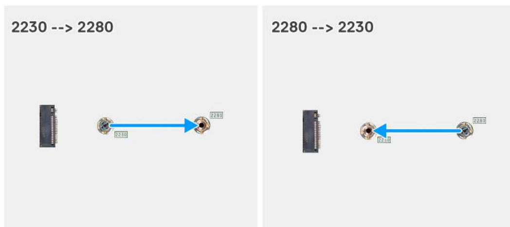
Rysunek 29. Przenoszenie uchwyty na śrubę w gnieździe SSD M.2 nr 0
