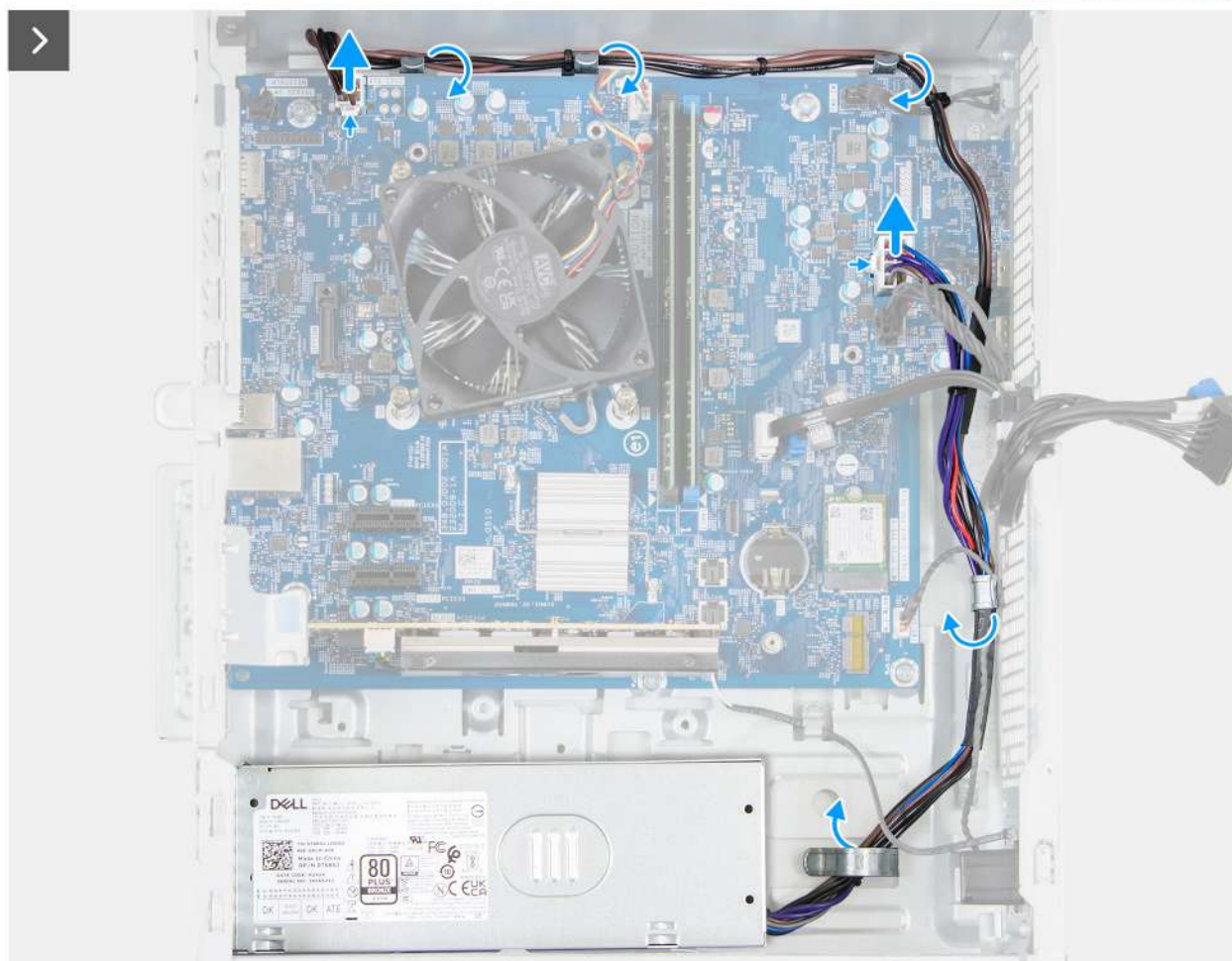
Rysunek 58. Wymontowywanie zasilacza
