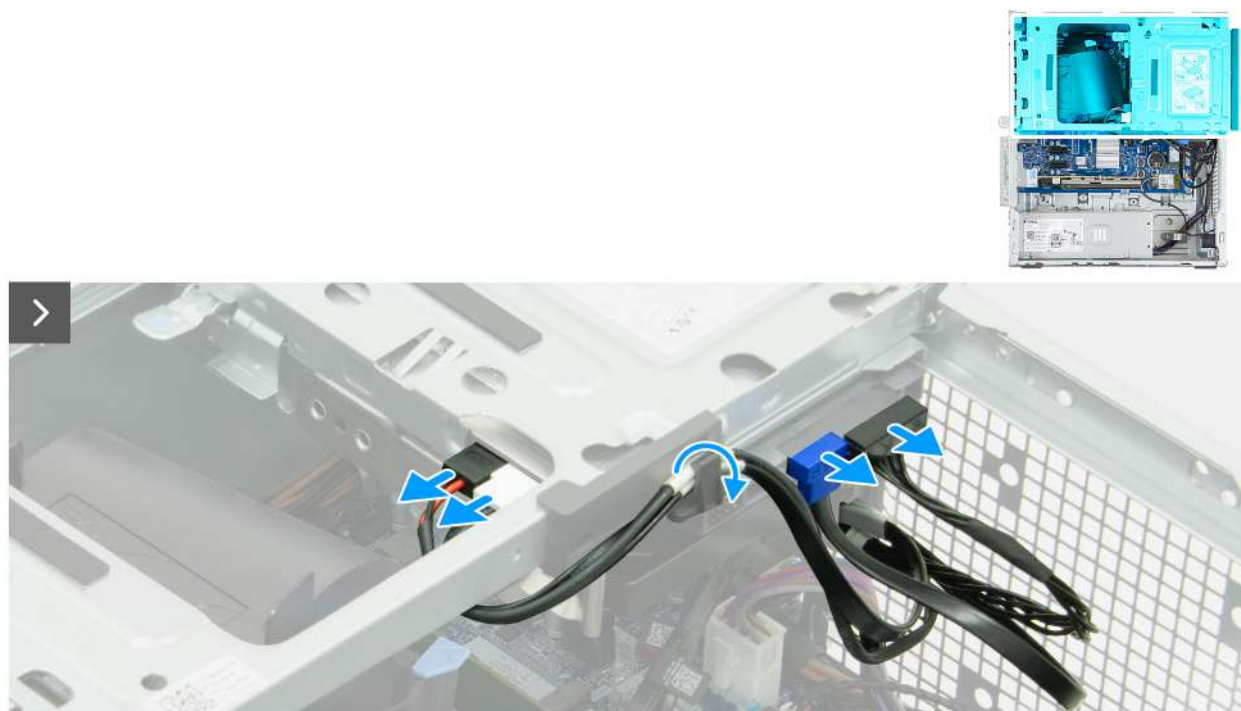
Rysunek 38. Wymontowywanie kieszeni napędu
