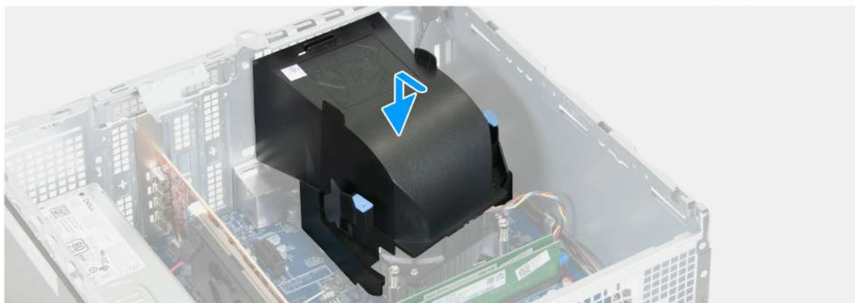
Rysunek 55. Ilustracja: instalowanie osłony wentylatora
