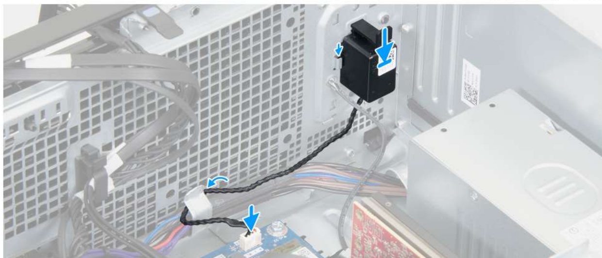
Rysunek 22. Instalowanie głośnika wewnętrznego
