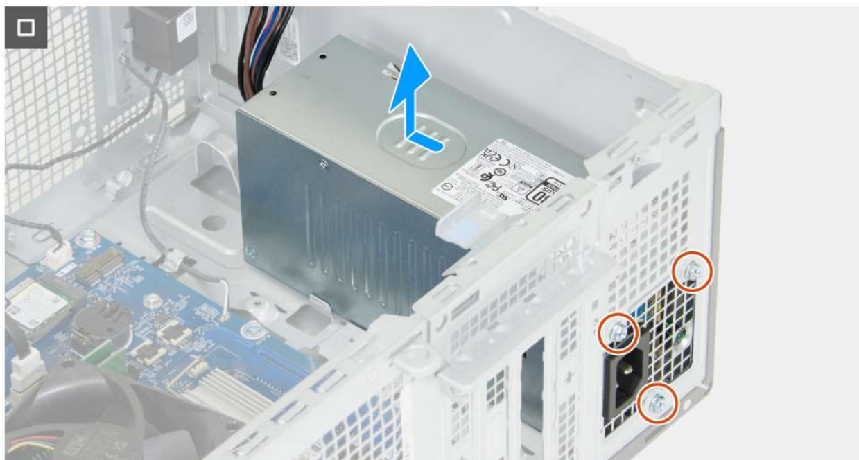
Rysunek 59. Wymontowywanie zasilacza
