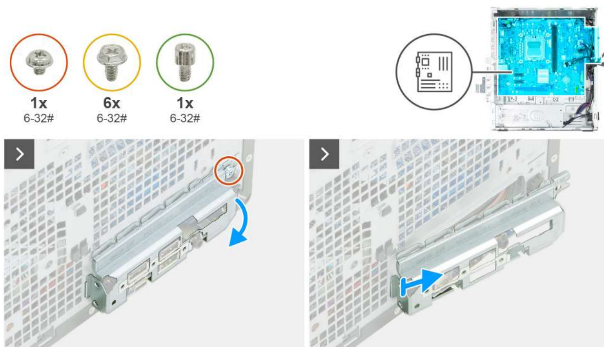
Rysunek 67. Wymontowywanie płyty głównej
