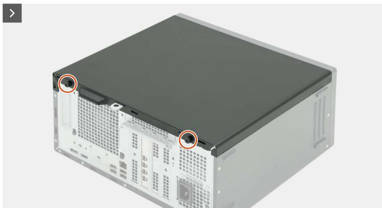
Rysunek 9. Wymontowywanie lewej pokrywy bocznej
