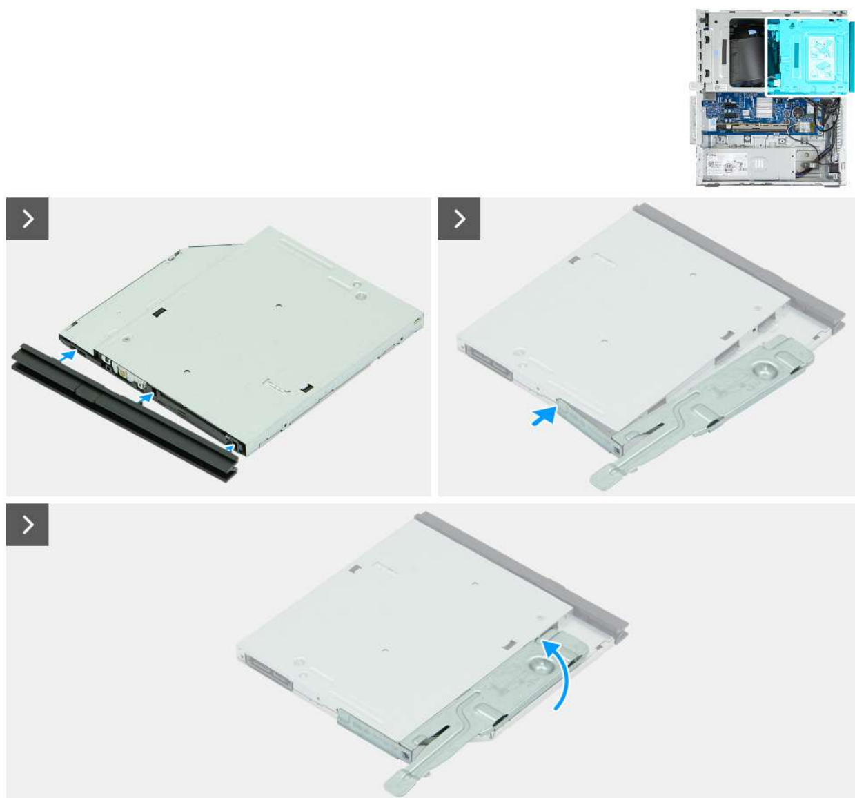
Rysunek 36. Instalowanie napędu optycznego
