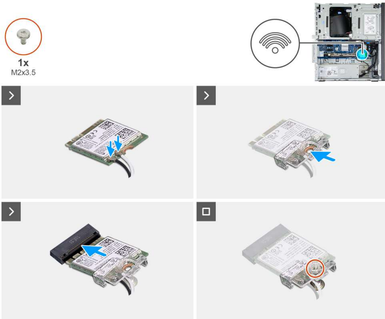
Rysunek 33. Instalowanie karty sieci bezprzewodowej
