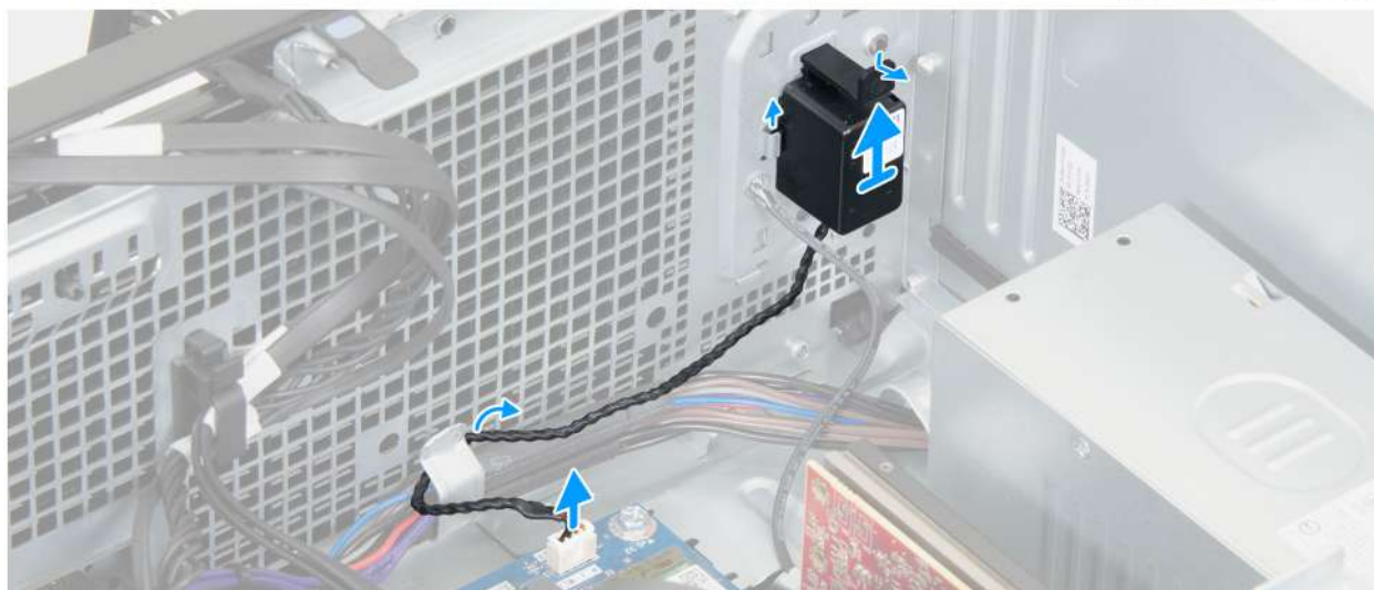
Rysunek 21. Wymontowywanie głośnika wewnętrznego
