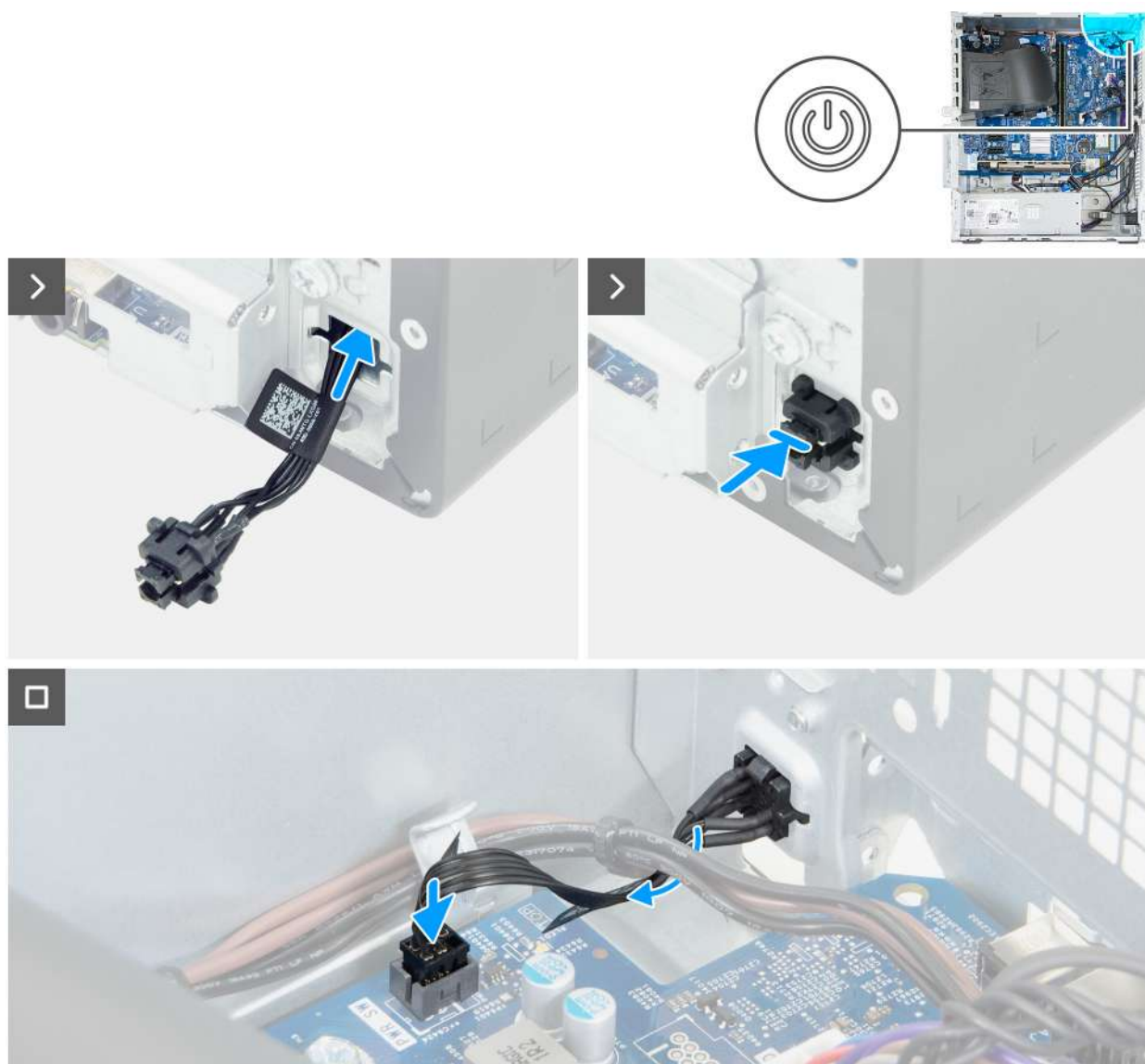
Rysunek 47. Instalowanie przycisku zasilania
