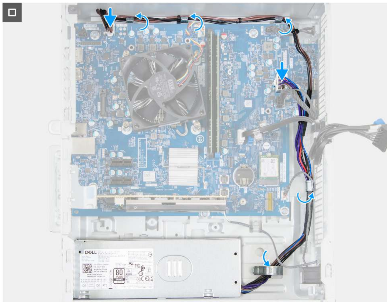
Rysunek 61. Instalowanie zasilacza
