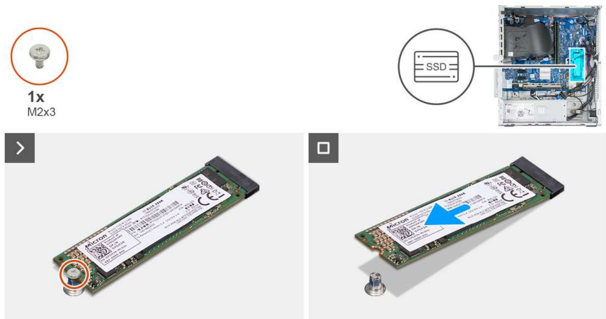
Rysunek 27. Wymontowywanie dysku SSD M.2 2280
