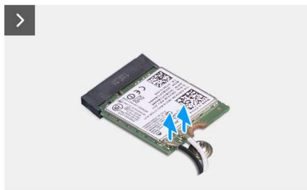
Rysunek 32. Wymontowywanie karty sieci bezprzewodowej
