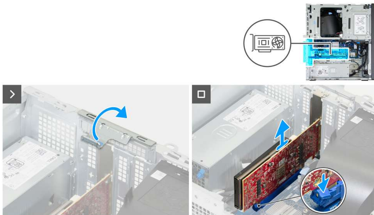
Rysunek 30. Wymontowywanie karty graficznej
