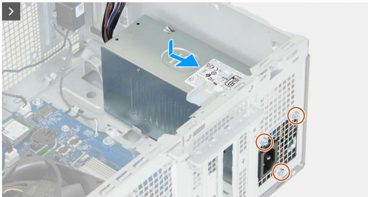
Rysunek 60. Instalowanie zasilacza
