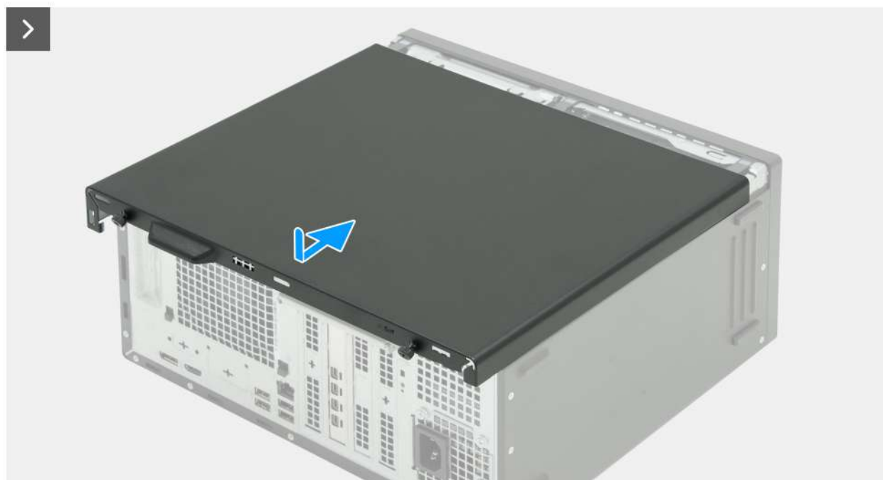
Rysunek 11. Instalowanie lewej pokrywy bocznej
