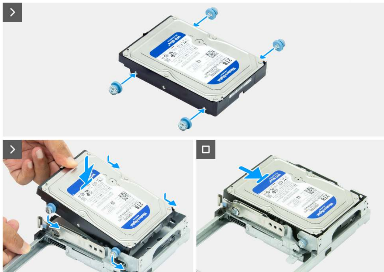
Rysunek 43. Instalowanie dysku twardego
