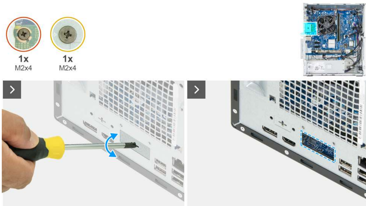
Rysunek 49. Instalowanie modułu portu opcjonalnego
