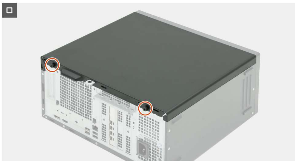
Rysunek 12. Instalowanie lewej pokrywy bocznej
