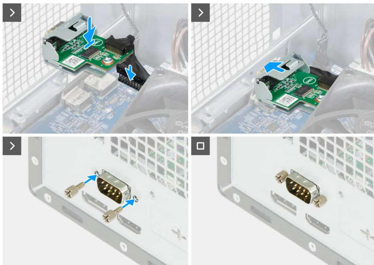
Rysunek 53. Instalowanie modułu portu szeregowego
