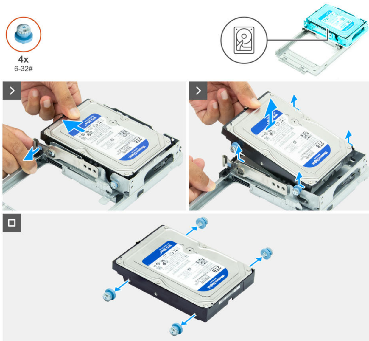
Rysunek 40. Wymontowywanie dysku twardego
