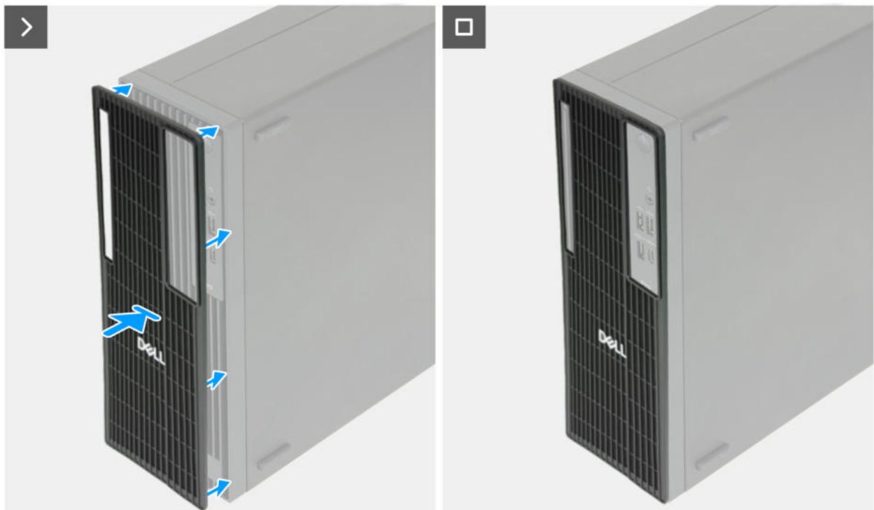
Rysunek 15. Instalowanie filtra przeciwpyłowego
