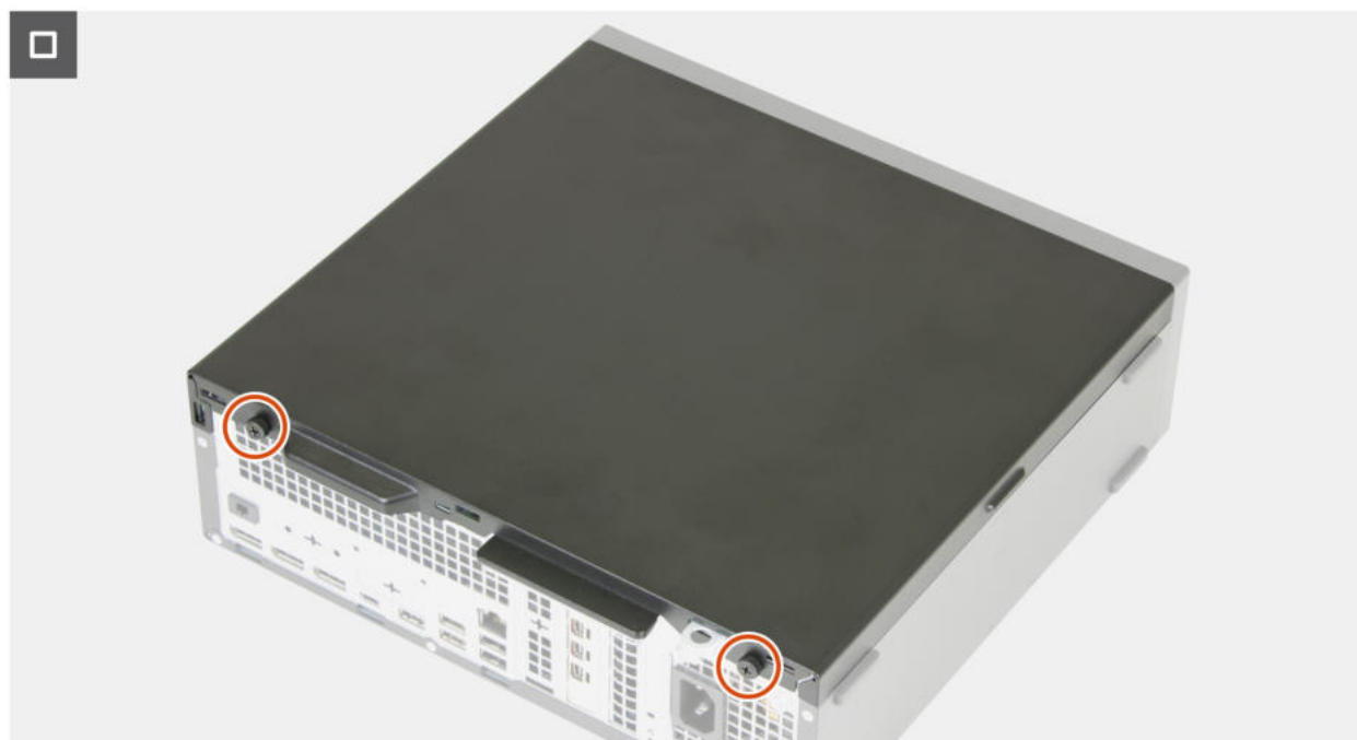
Rysunek 9. Instalowanie pokrywy bocznej
