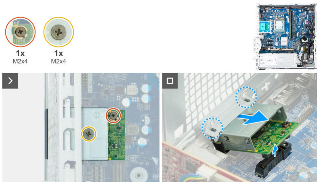
Rysunek 54. Wymontowywanie modułu z opcjonalnym portem
