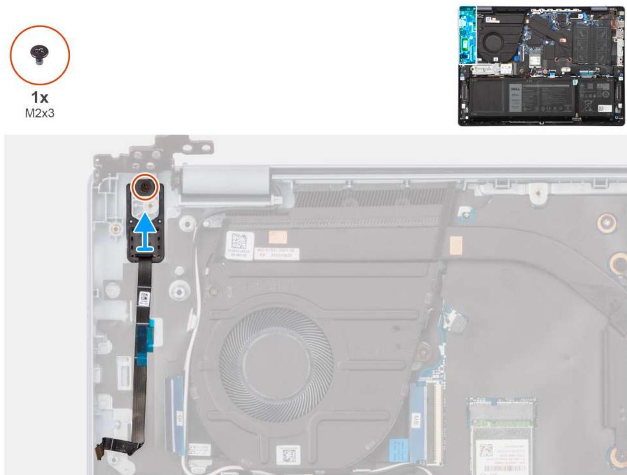
Rysunek 58. Wymontowywanie przycisku zasilania z czytnikiem linii papilarnych
