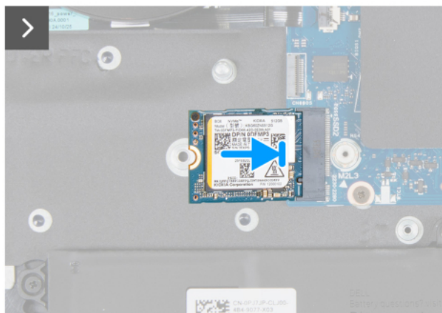
Rysunek 32. Wymontowywanie dysku SSD M.2 2230 z gniazda SSD2
