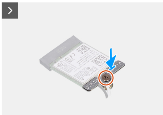
Rysunek 35. Instalowanie karty sieci bezprzewodowej
