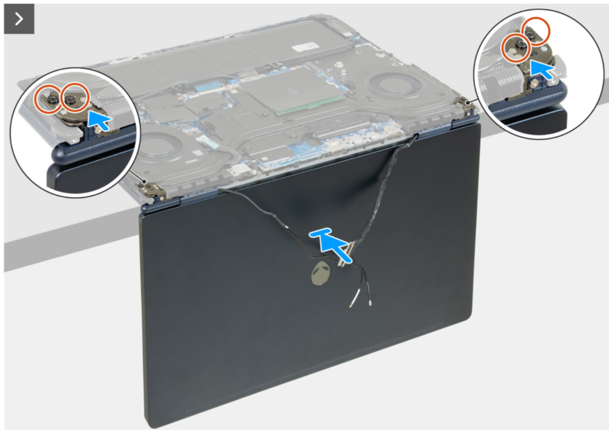
Rysunek 70. Instalowanie zestawu wyświetlacza
