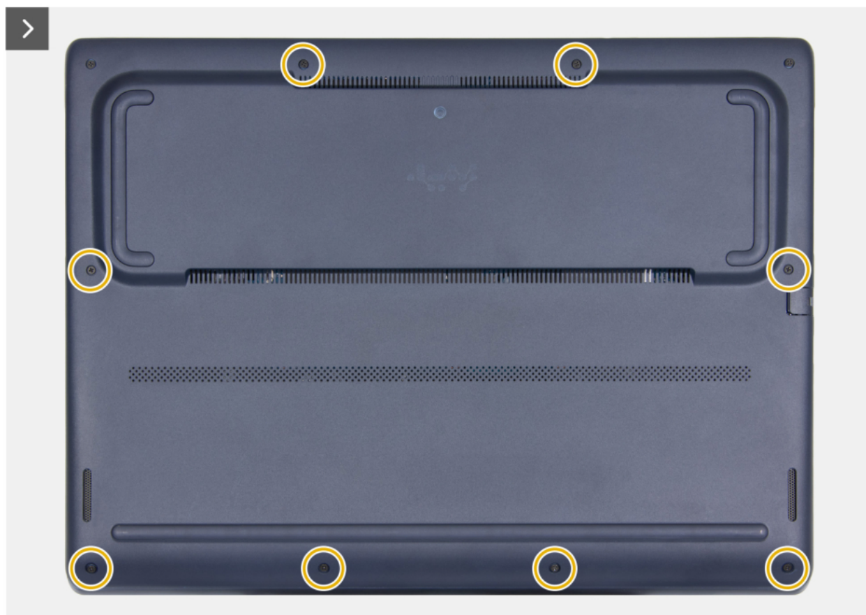
Rysunek 11. Wykręcanie ośmiu z pokrywy dolnej
