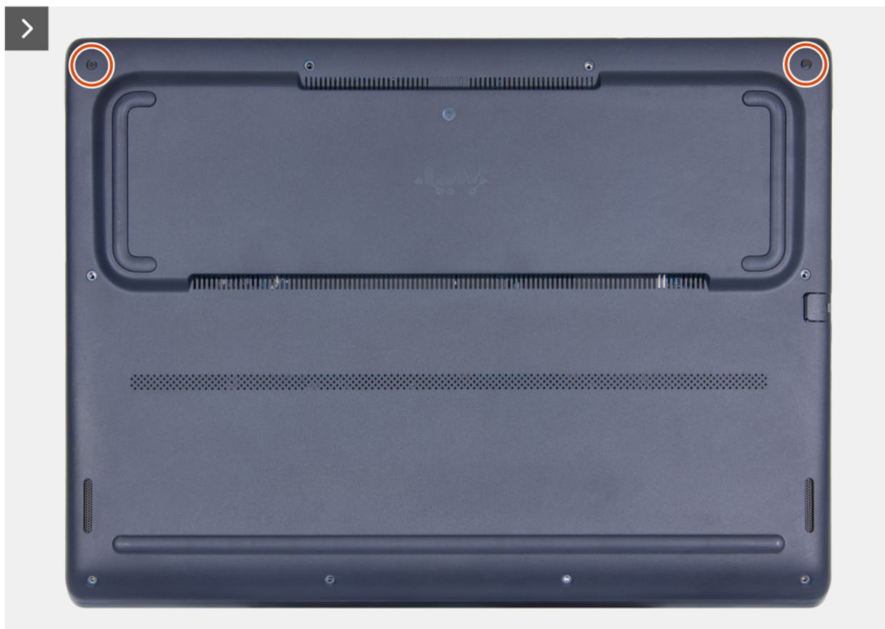
Rysunek 12. Luzowanie mocujących pokrywę dolną
