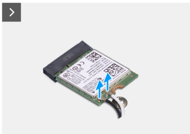
Rysunek 34. Wymontowywanie karty sieci bezprzewodowej
