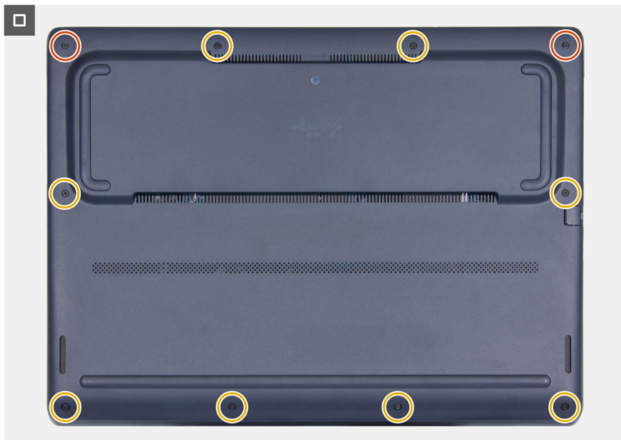
Rysunek 19. Instalowanie pokrywy dolnej
