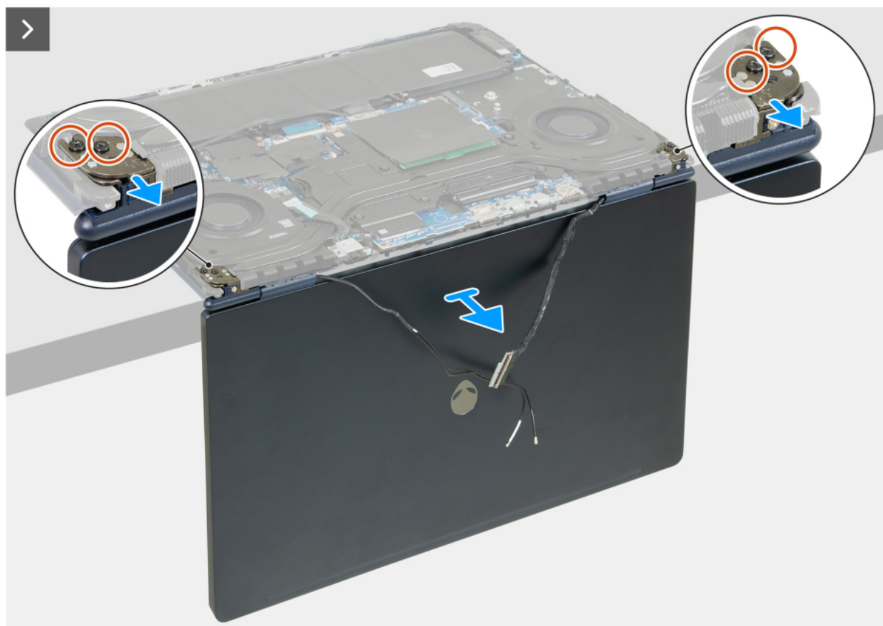
Rysunek 68. Wymontowywanie zestawu wyświetlacza
