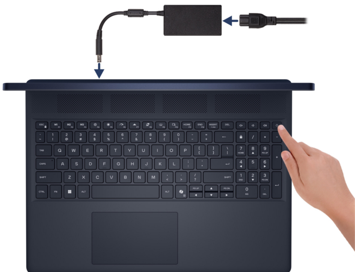
Rysunek 8. Podłącz zasilacz i naciśnij przycisk zasilania
