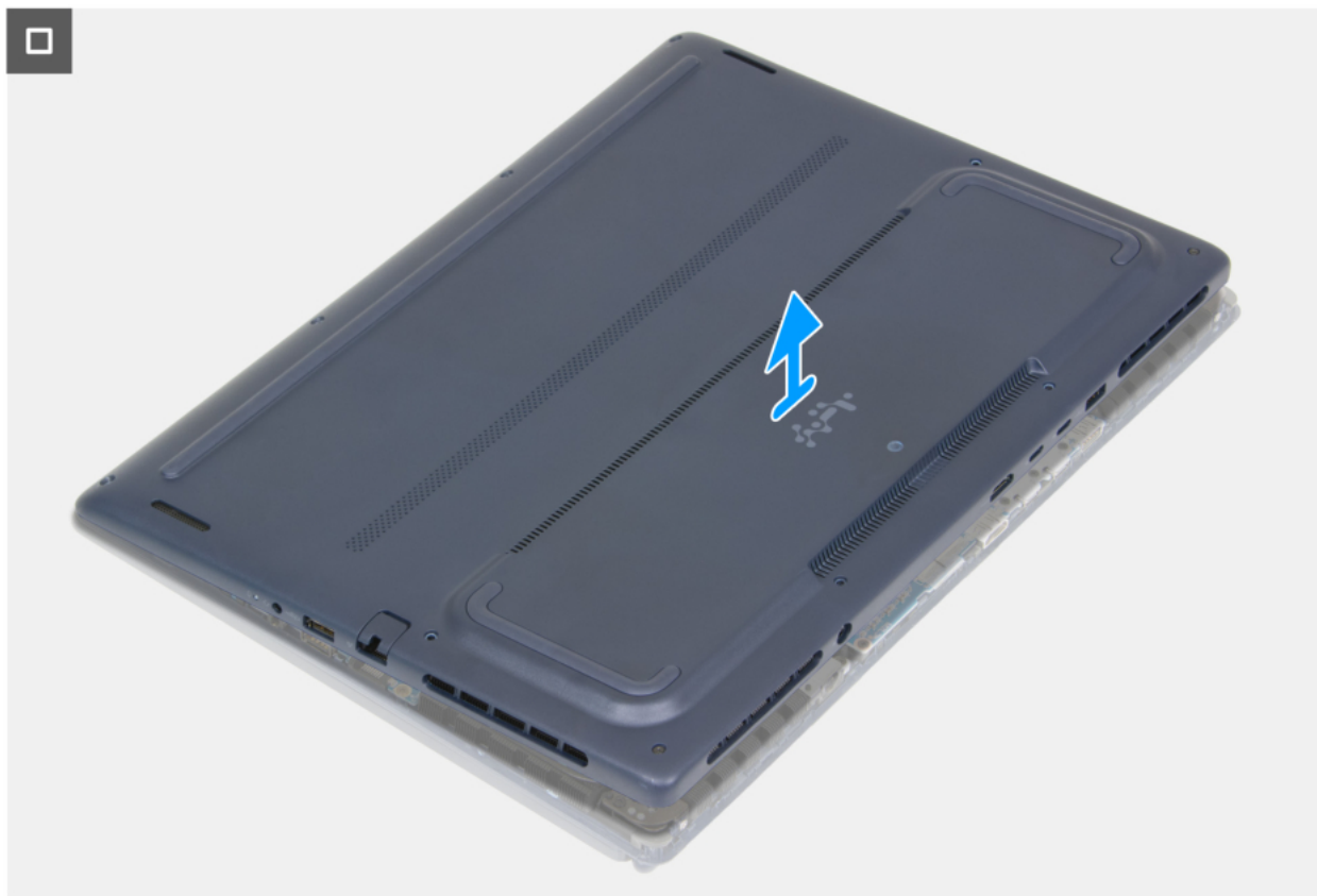
Rysunek 14. Wymontowywanie pokrywy dolnej
