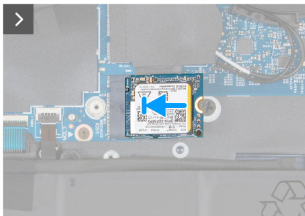
Rysunek 31. Instalacja dysku SSD M.2 2230 w gnieździe SSD1
