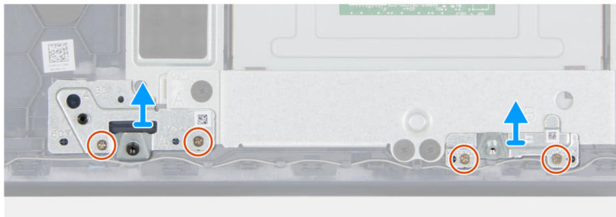
Rysunek 46. Wymontowywanie klamer baterii 6-ogniowej
