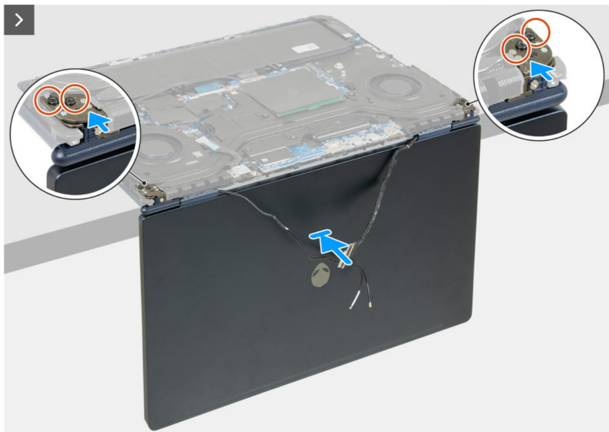
Rysunek 70. Instalowanie zestawu wyświetlacza
