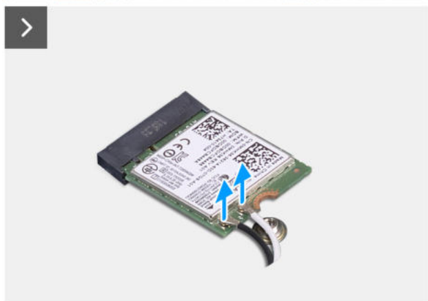
Rysunek 34. Wymontowywanie karty sieci bezprzewodowej
