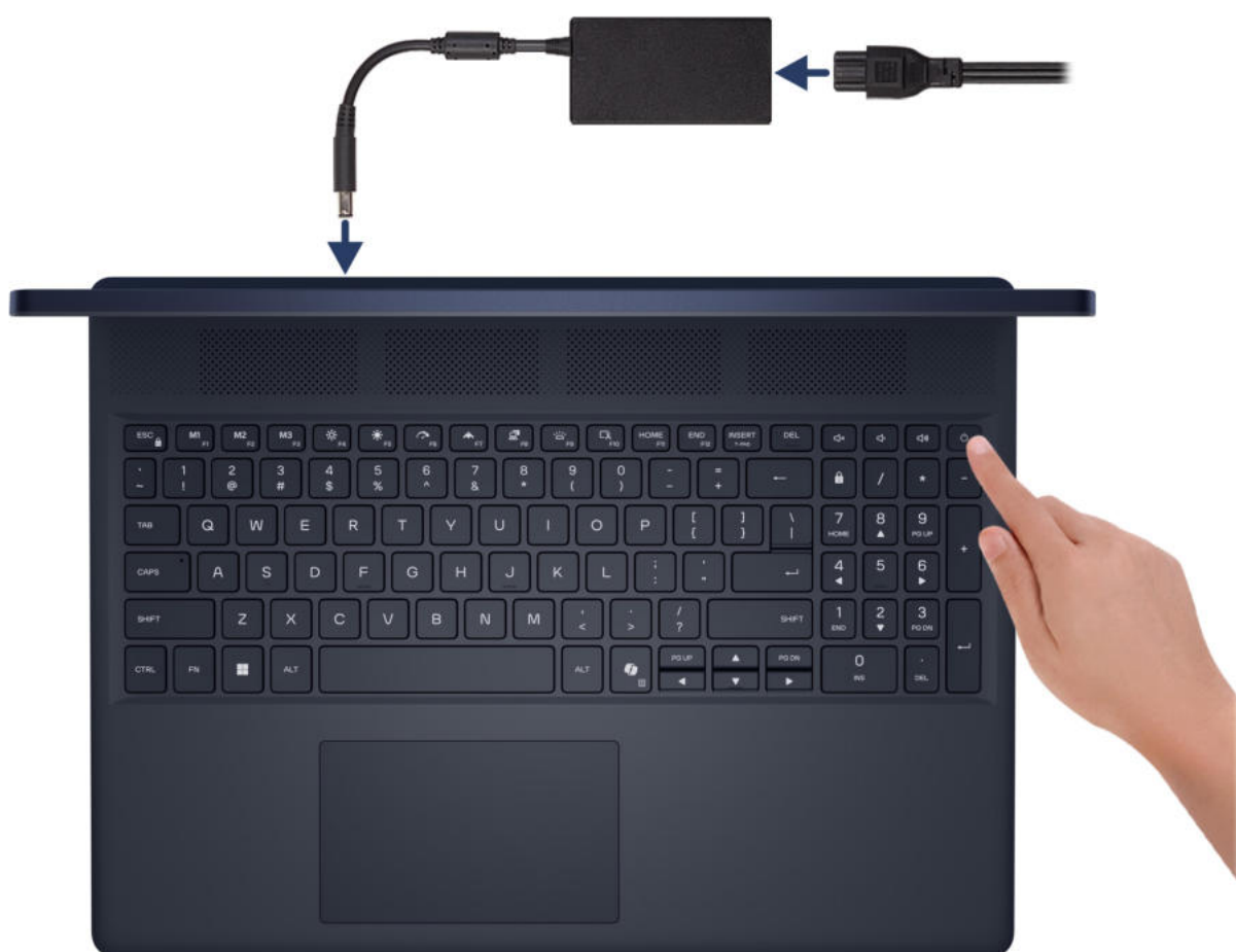
Rysunek 8. Podłącz zasilacz i naciśnij przycisk zasilania
