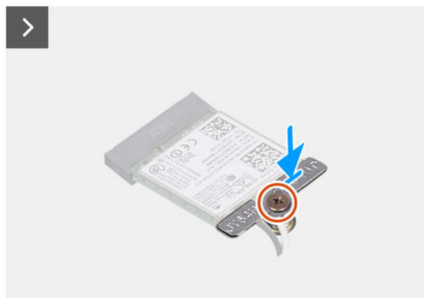
Rysunek 35. Instalowanie karty sieci bezprzewodowej
