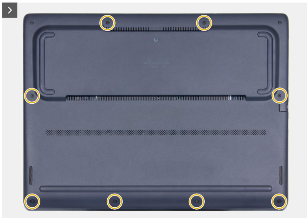
Rysunek 11. Wykręcanie ośmiu z pokrywy dolnej
