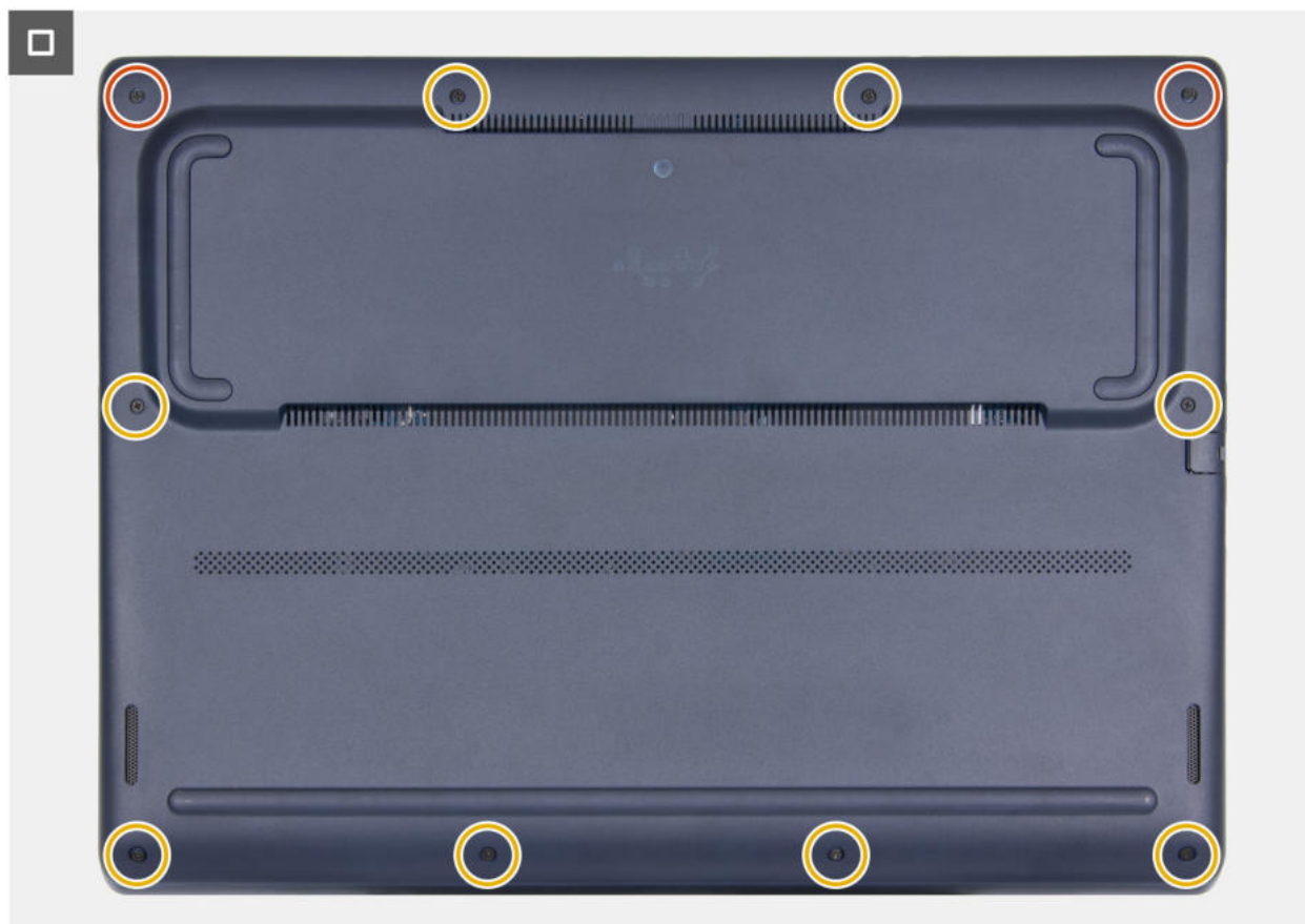
Rysunek 19. Instalowanie pokrywy dolnej
