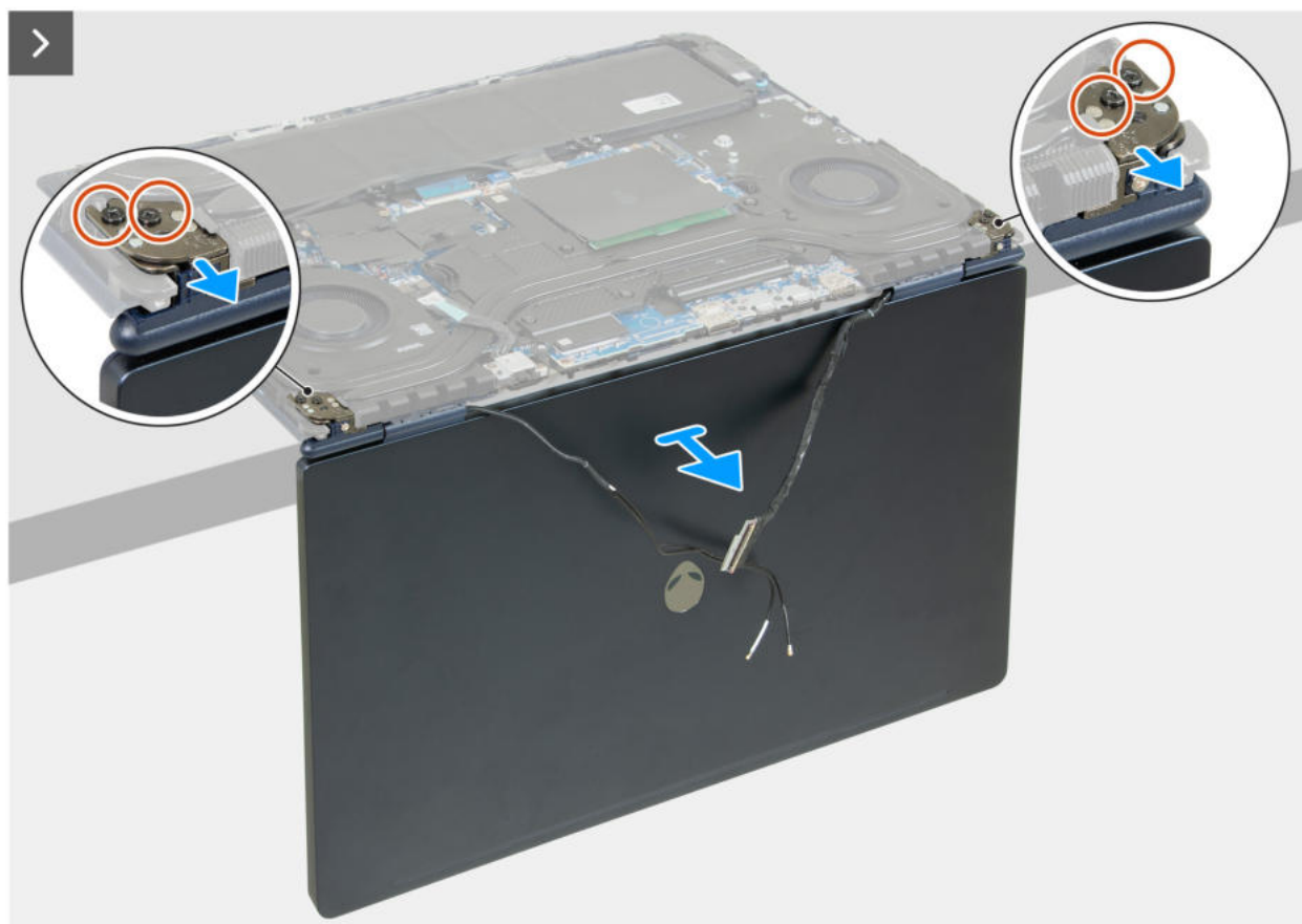
Rysunek 68. Wymontowywanie zestawu wyświetlacza
