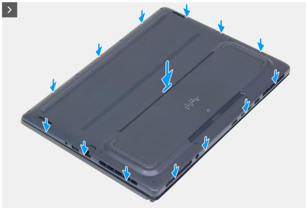
Rysunek 18. Instalowanie pokrywy dolnej
