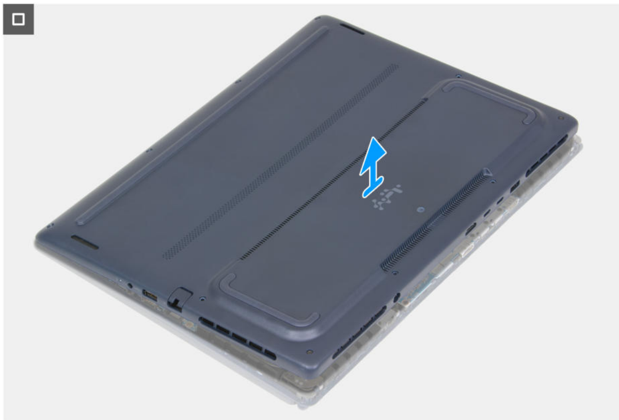
Rysunek 14. Wymontowywanie pokrywy dolnej
