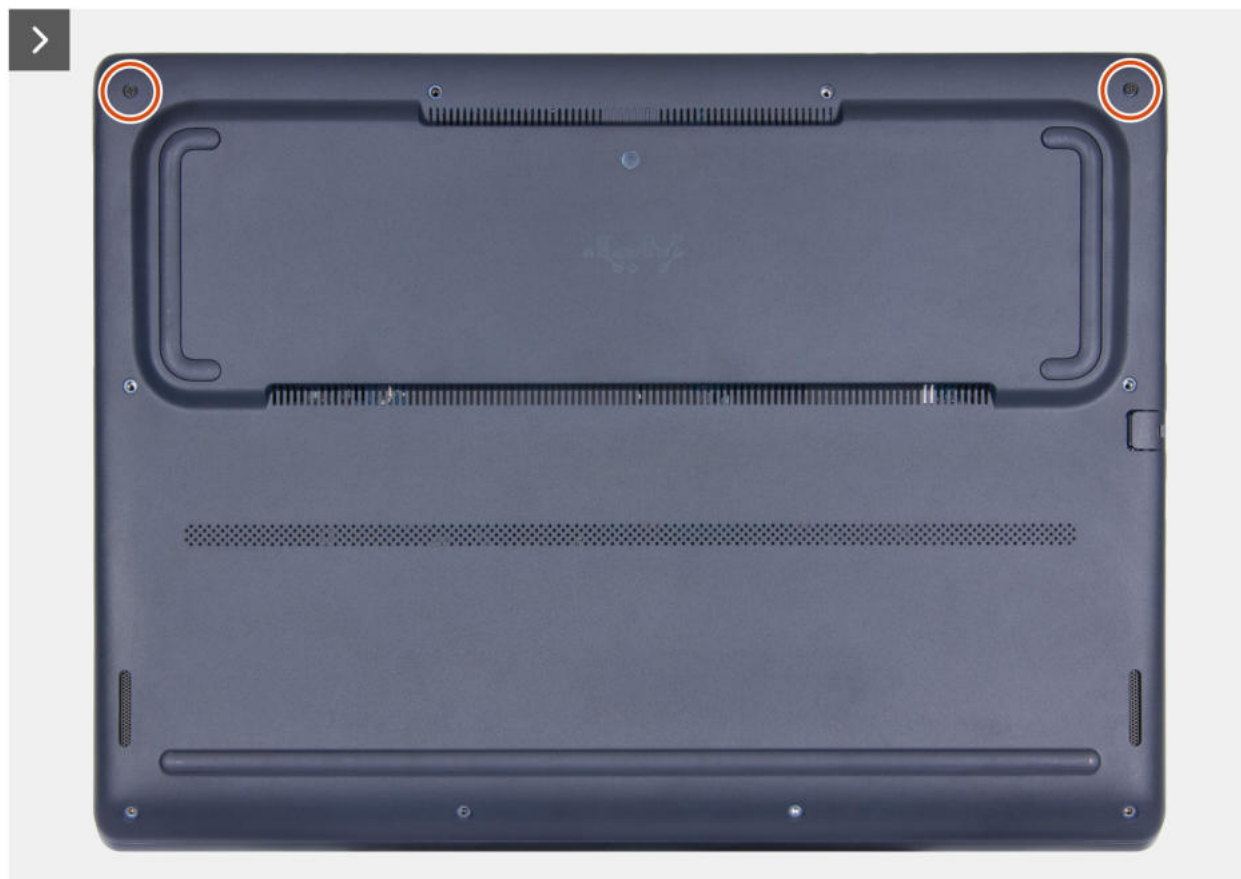
Rysunek 12. Luzowanie mocujących pokrywę dolną
