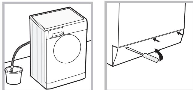
2. Stellen Sie sicher, dass der Wasserstand im Innern des Gerätes die Gerätetür nicht übersteigt, andernfalls lassen Sie das überschüssige Wasser, so wie auf der Abbildung veranschaulicht, durch den Ablaufschlauch in einen Eimer ablaufen.
