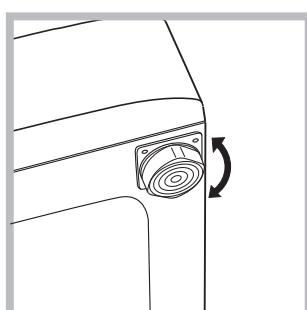
2. Sollte der Boden nicht perfekt eben sein, müssen die Unebenheiten durch An- bzw. Ausdrehen der vorderen Stellfüße ausgeglichen werden (siehe Abbildung), der auf der Arbeitsfläche zu ermittelnde Neigungswinkel darf 2°
