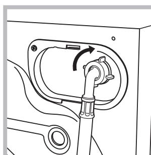
2. Podłączyć do urządzenia przewód doprowadzający wodę, przykręcając go do odpowiedniego przyłącza wody, znajdującego się w tylnej części pralki, z prawej strony u góry (patrz rysunek).
