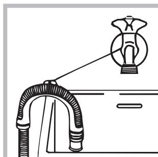
Oder hängen Sie den Ablaufschlauch in ein Becken oder eine Wanne ein; befestigen Sie ihn in diesem Falle mittels der Führung (beim Kundendienst erhältlich) an dem Wasserhahn (siehe Abbildung). Das freie Ablaufschlauchende darf nicht unter Wasser bleiben.
