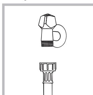
1. Podłącz przewód zasilający poprzez przykrecenie go do zaworu zimnej wody z końcówką gwintowaną (patrz rysunek): Przed podłączeniem spuszczać wodę do momentu, aż stanie się ona całkowicie przezroczysta.
