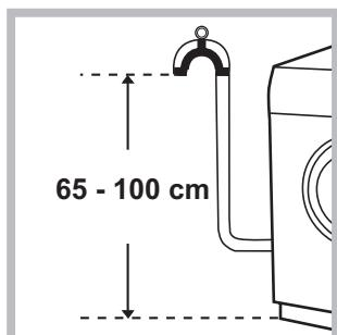
Schließen Sie den Ablaufschlauch, ohne ihn dabei zu knicken, an eine Ablaufleitung, oder an einen in der Wand, in einer Höhe von 65cm bis 100cm an.
