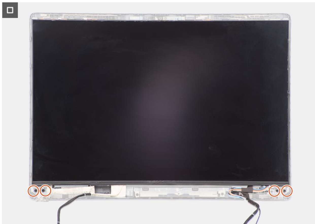
Rysunek 73. Instalowanie wyświetlacza
