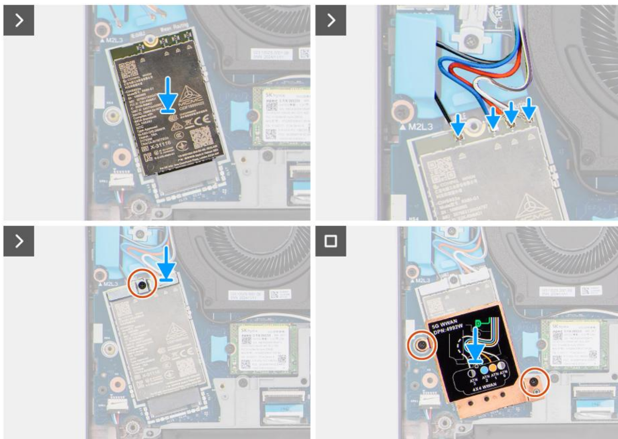
Rysunek 32. Instalowanie modułu złącza WWAN
