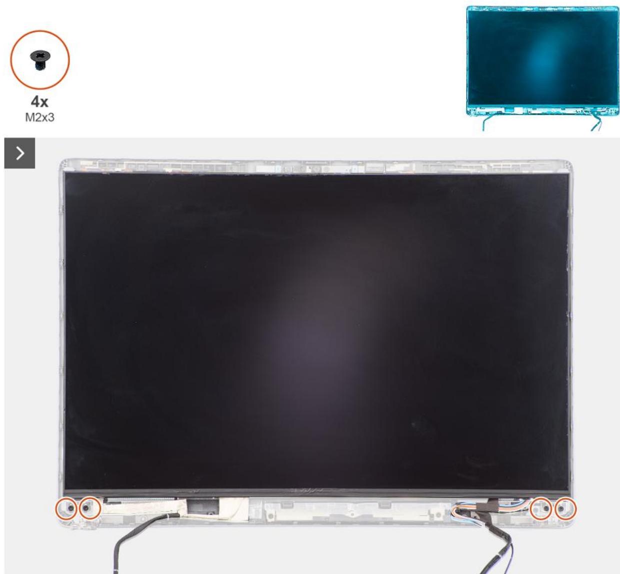
Rysunek 68. Wymontowywanie wyświetlacza
