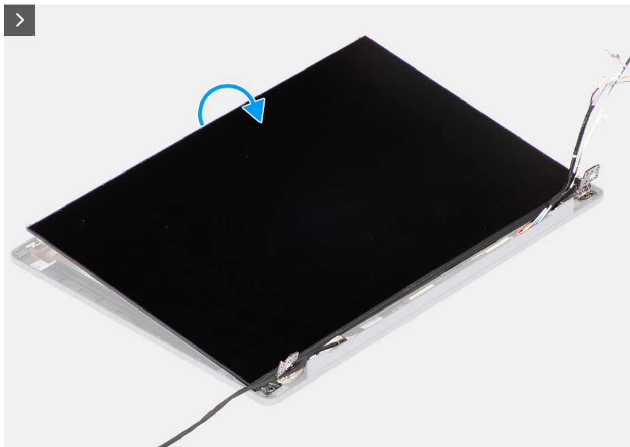
Rysunek 69. Wymontowywanie wyświetlacza
