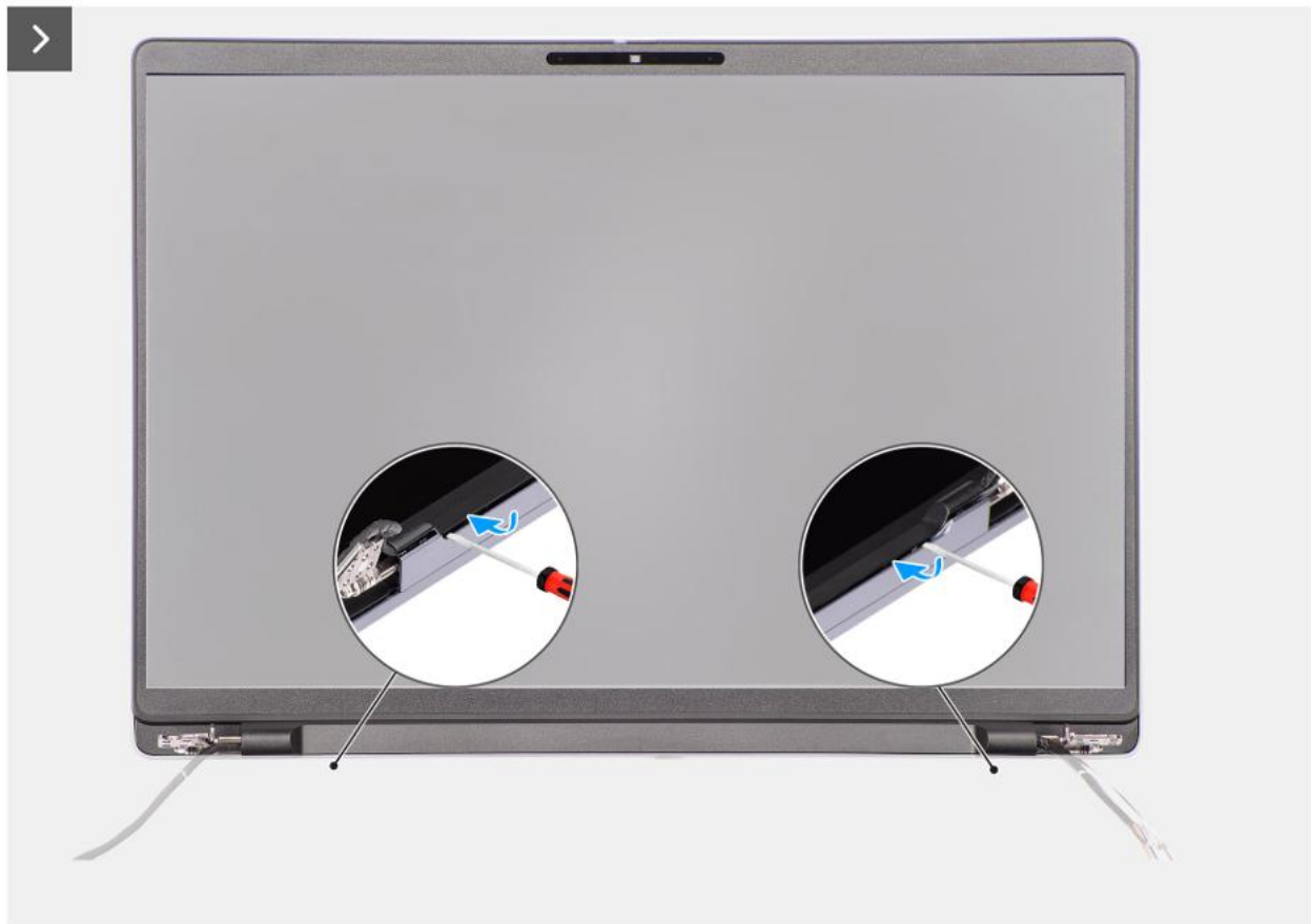
Rysunek 60. Wymontowywanie ramki wyświetlacza
