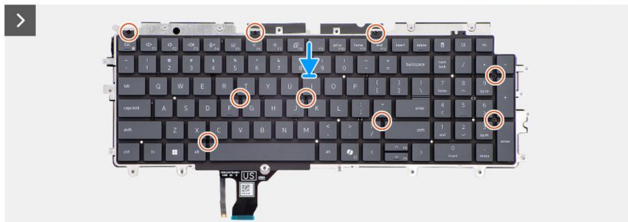
Rysunek 100. Instalowanie klawiatury
