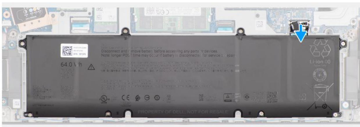
Rysunek 14. Wymontowywanie kabla baterii
