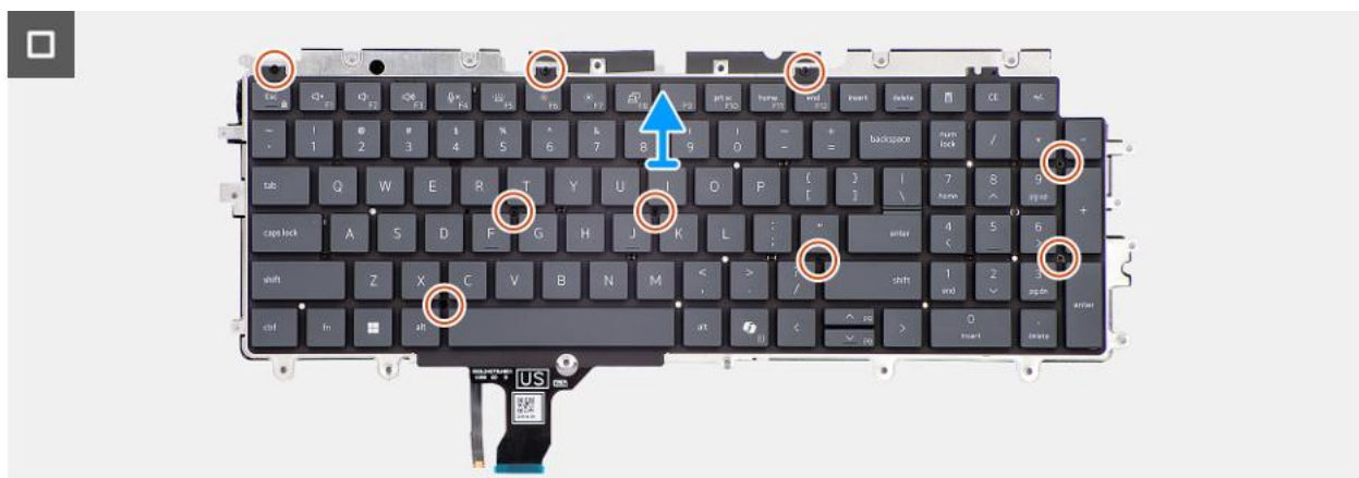
Rysunek 99. Wymontowywanie klawiatury
