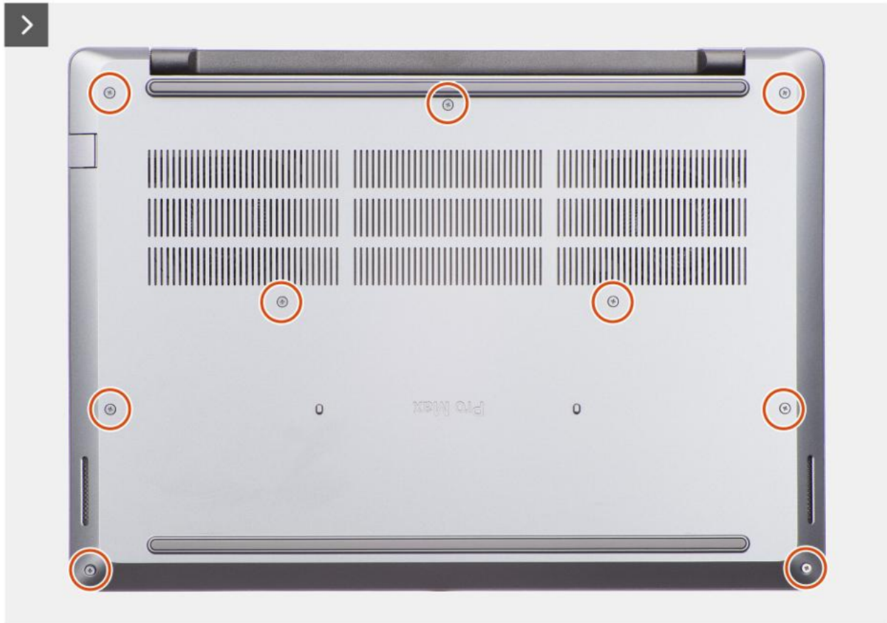
Rysunek 12. Wymontowywanie pokrywy dolnej
