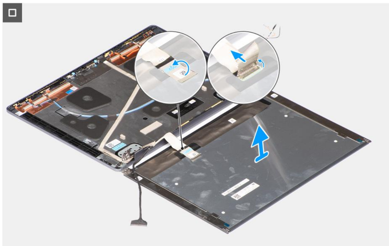
Rysunek 70. Wymontowywanie wyświetlacza
