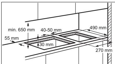
Jestliže instalujete několik varných desek o velikosti 30 cm vedle sebe do stejného výřezu, můžete si v našem autorizovaném servisním středisku zakoupit instalacní soupravu včetně bočního držáku a dalších těsnění. Pokyny potřebné k instalaci jsou uvedeny v balení soupravy.
