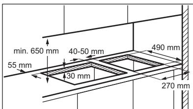
Jeżeli w tym samym wycięciu ma zostać zainstalowanych obok siebie kilka płyt (30-centymetrowych), dodatkowe uszczelki i zestaw montażowy zawierający boczny wspornik można nabyć w autoryzowanym punkcie serwisowym. Odpowiednią instrukcję montażu dołączono do zestawu.
