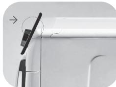
Pokud neznáte pozici NFC antény, krouživými pohyby lehce pohybujte chytrým telefonem nad logem One Touch dokud aplikace nepotvrdí připojení. Aby byl přenos dat úspěšný, je nutné **UDRŽOVAT CHYTRÝ TELEFON V BLÍZKOSTI OVLÁDACÍHO PANELU BĚHEM CELÉHO NĚKOLIKAVTEŘINOVÉHO PŘIPOJENÍ**. Následně Vás bude zařízení informovat o správném výsledku operace a oznámí Vám, že je možné přesunout se s chytrým telefonem kamkoliv.
