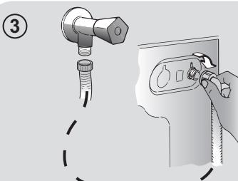
**HOT&COLD (εικ. 4):** πρόβλεψη για σύνδεση τόσο με το δίκτυο ζεστού όσο και με το δίκτυο κρύου νερού για μεγαλύτερη εξοικονόμηση ενέργειας. Συνδέστε τη γκρι σωλήνα στη βρύση του κρύου νερού και την κόκκινη σωλήνα στην βρύση του ζεστού νερού. Η συσκευή μπορεί να συνδεθεί και αποκλειστικά μόνο στη βρύση κρύου νερού ή μόνο στη βρύση ζεστού, σε αυτή την περίπτωση η έναρξη κάποιων προγραμμάτων θα καθυστερήσει για μερικά λεπτά.
