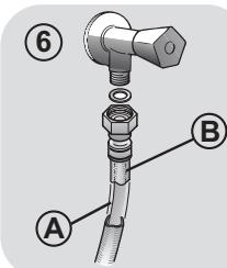
● **AQUAPROTECT - PRZEWÓD WODY Z ZABEZPIECZENIEM (rys. 6):** W przypadku wycieku wody z głównej rury wewnętrznej "A" jego przezroczysta osłona zewnętrzna "B" będzie wypełniona wodą, co pozwoli na ukończenie bieżącego prania. Po zakończeniu cyklu wymienić przewód kontaktując się z Centrum Serwisu Technicznego.
