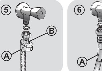
● **AQUAPROTECT - PRÍVODNÁ HADICA S OCHRANOU (obr. 6):** Ak voda preteče z hlavnej internej hadice "A", transparentný izolačný plášť "B" udrží vodu na dokončenie pracího cyklu. Na konci cyklu kontaktujte autorizované servisné stredisko pre výmenu prívodnej hadice.
