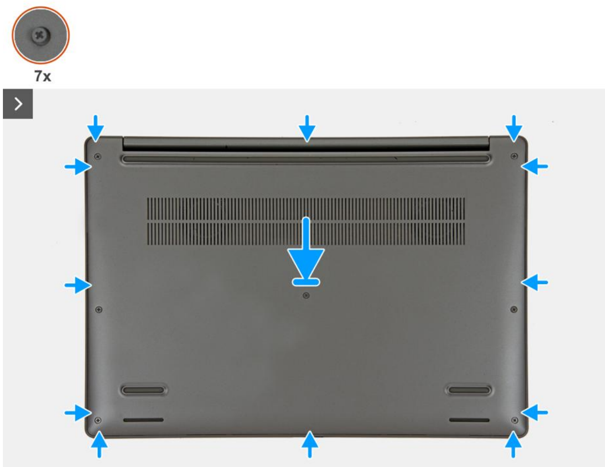
Rysunek 20. Instalowanie pokrywy dolnej
