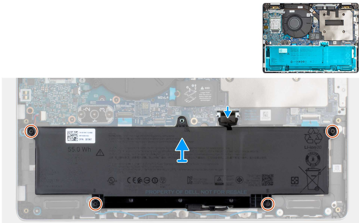
Rysunek 18. Podłączanie kabla baterii
