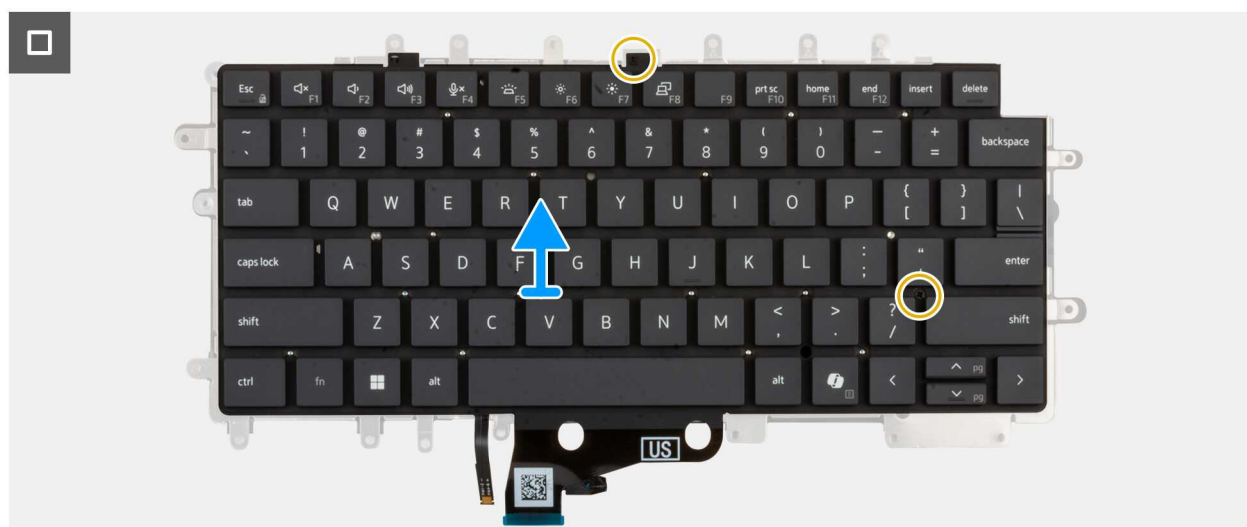
Rysunek 54. Wymontowywanie klawiatury
