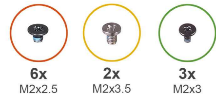
Rysunek 42. Instalowanie płyty głównej
