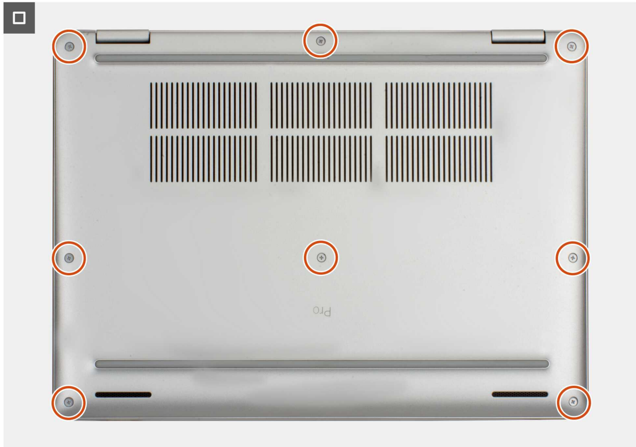
Rysunek 20. Instalowanie pokrywy dolnej
