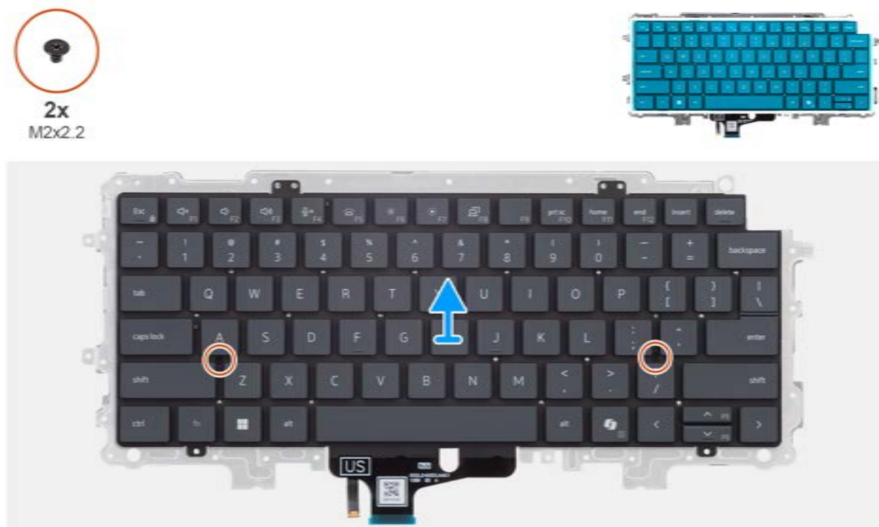
Rysunek 56. Wymontowywanie płyty nośnej klawiatury
