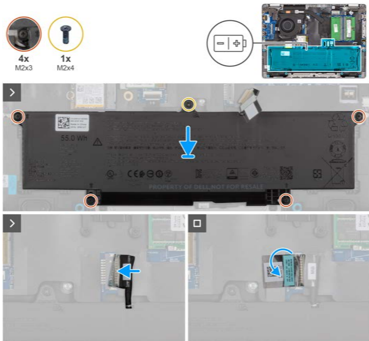
Rysunek 18. Instalowanie baterii
