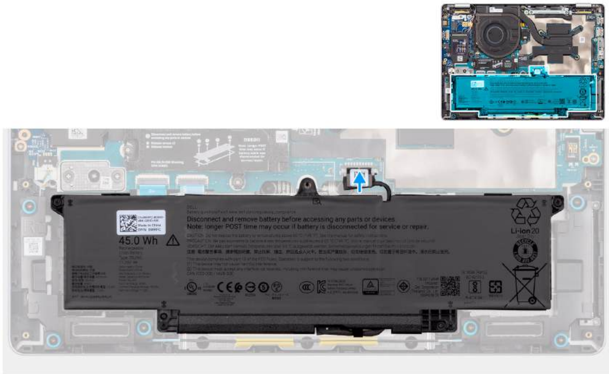
Rysunek 20. Podłączanie kabla baterii
