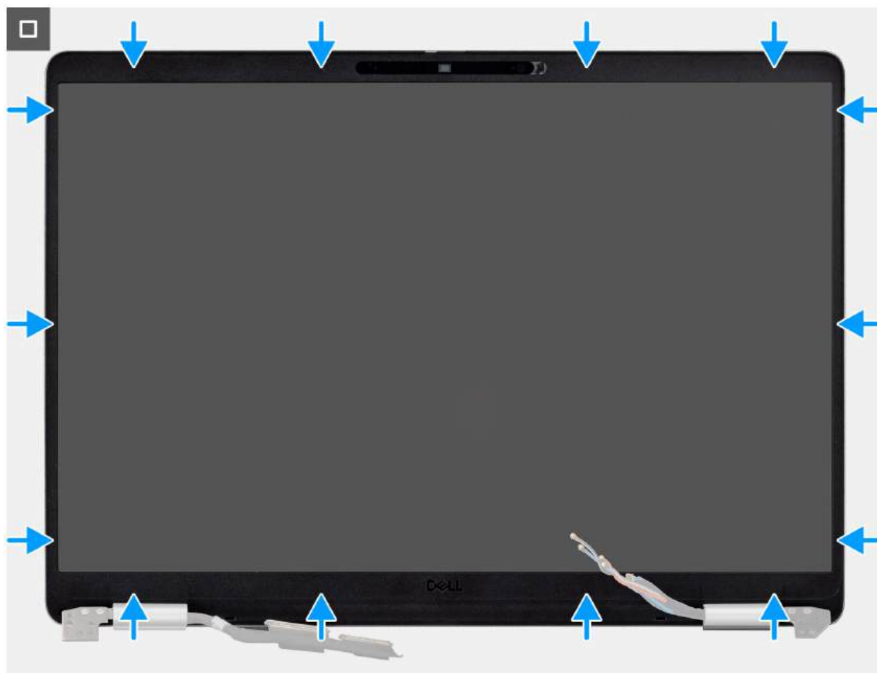
Rysunek 71. Instalowanie ramki wyświetlacza
