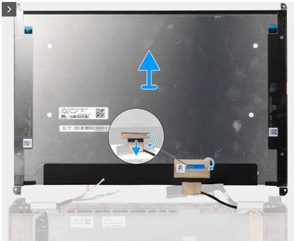
Rysunek 73. Wymontowywanie wyświetlacza
