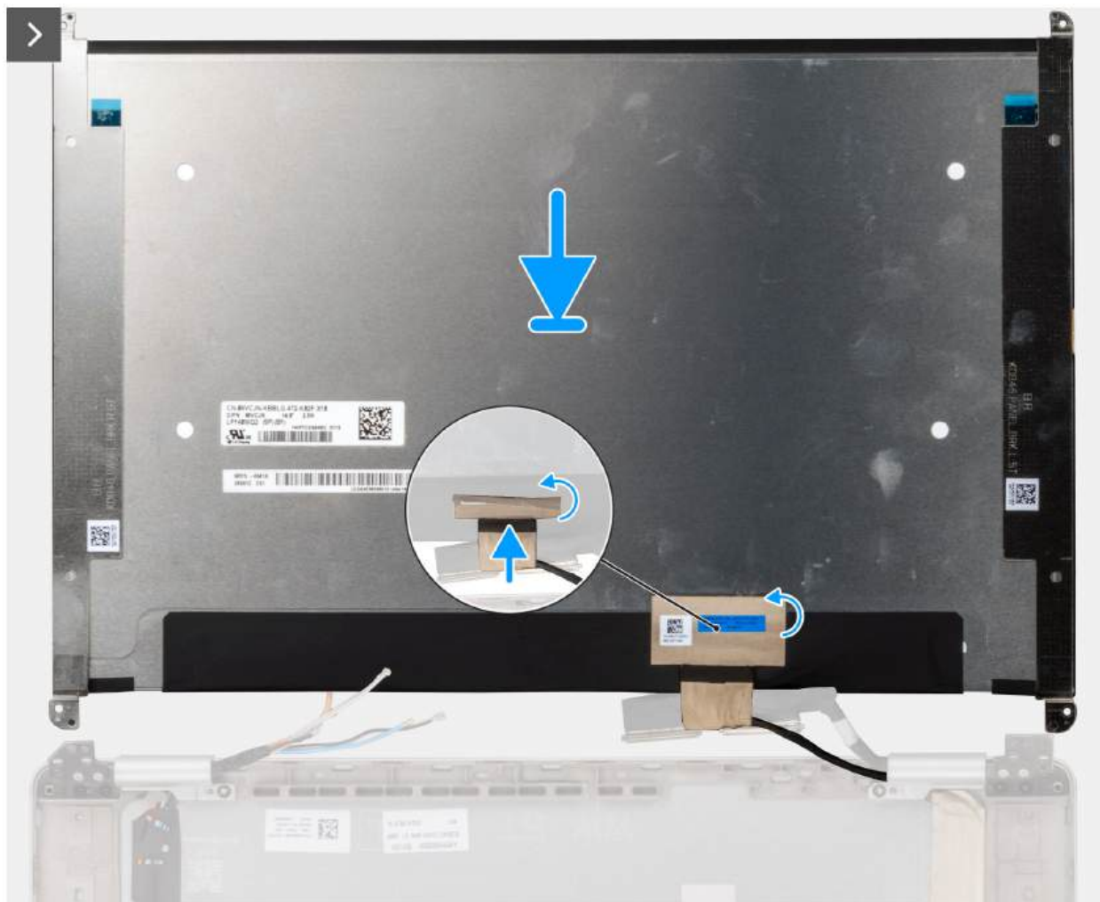
Rysunek 75. Instalowanie wyświetlacza
