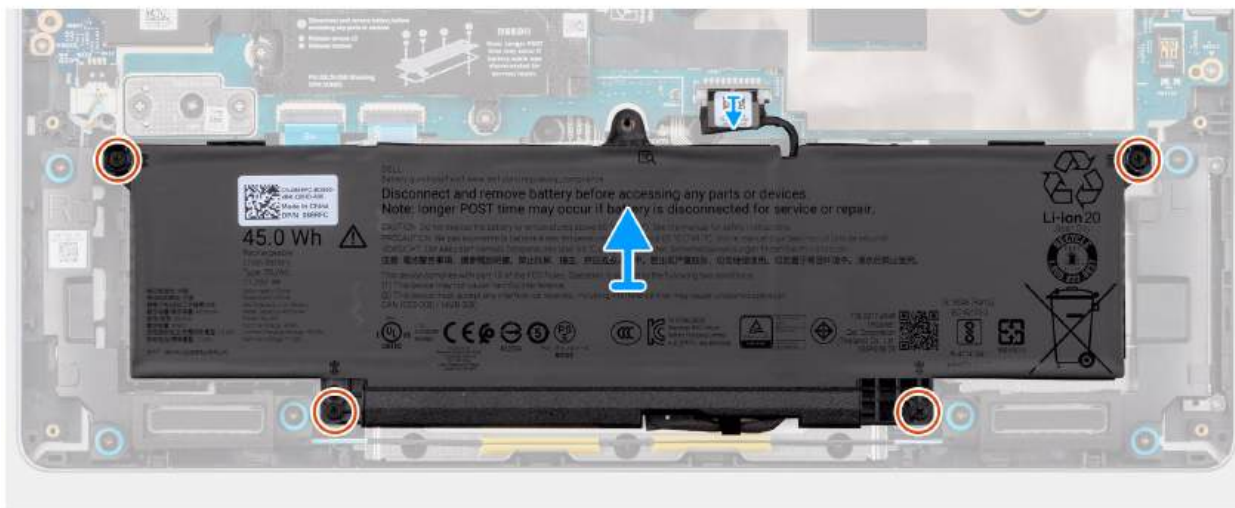
Rysunek 23. Wymontowywanie baterii
