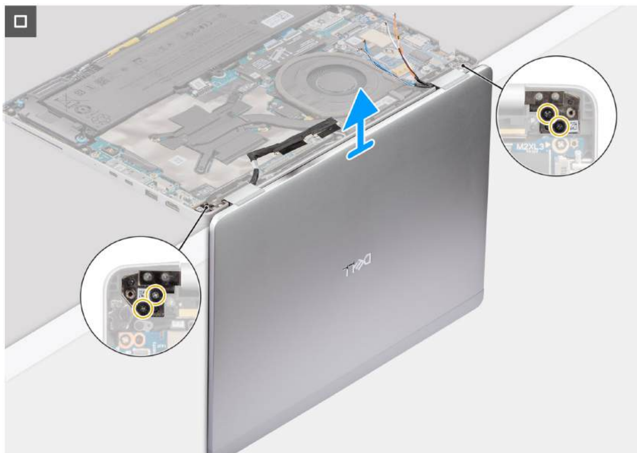
Rysunek 62. Wymontowywanie zestawu wyświetlacza
