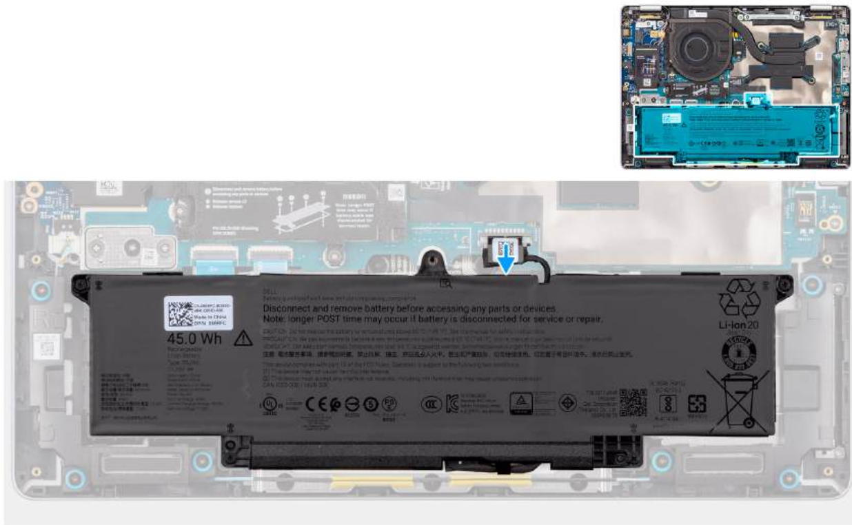
Rysunek 19. Odłączenie kabla baterii
