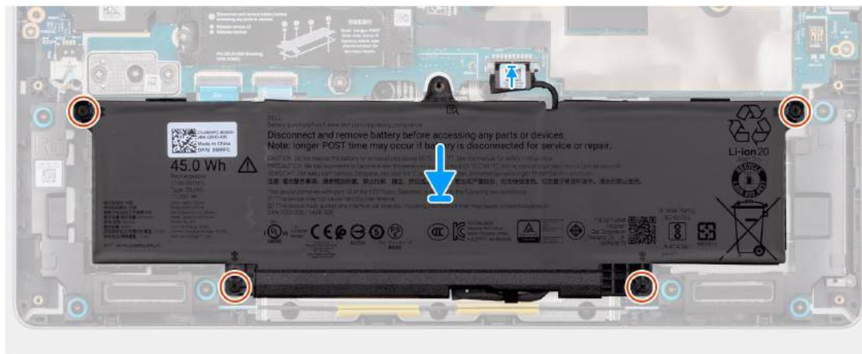
Rysunek 24. Instalowanie baterii
