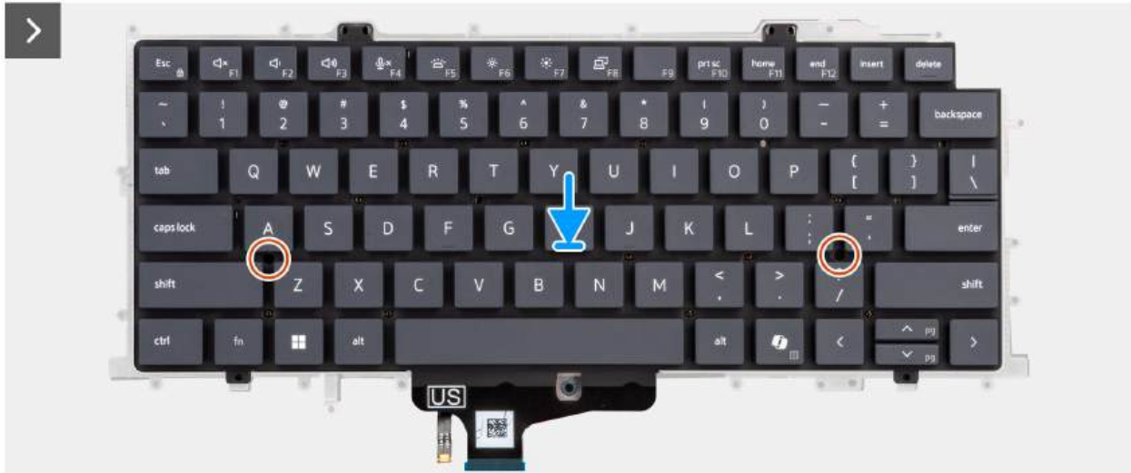
Rysunek 99. Instalowanie klawiatury
