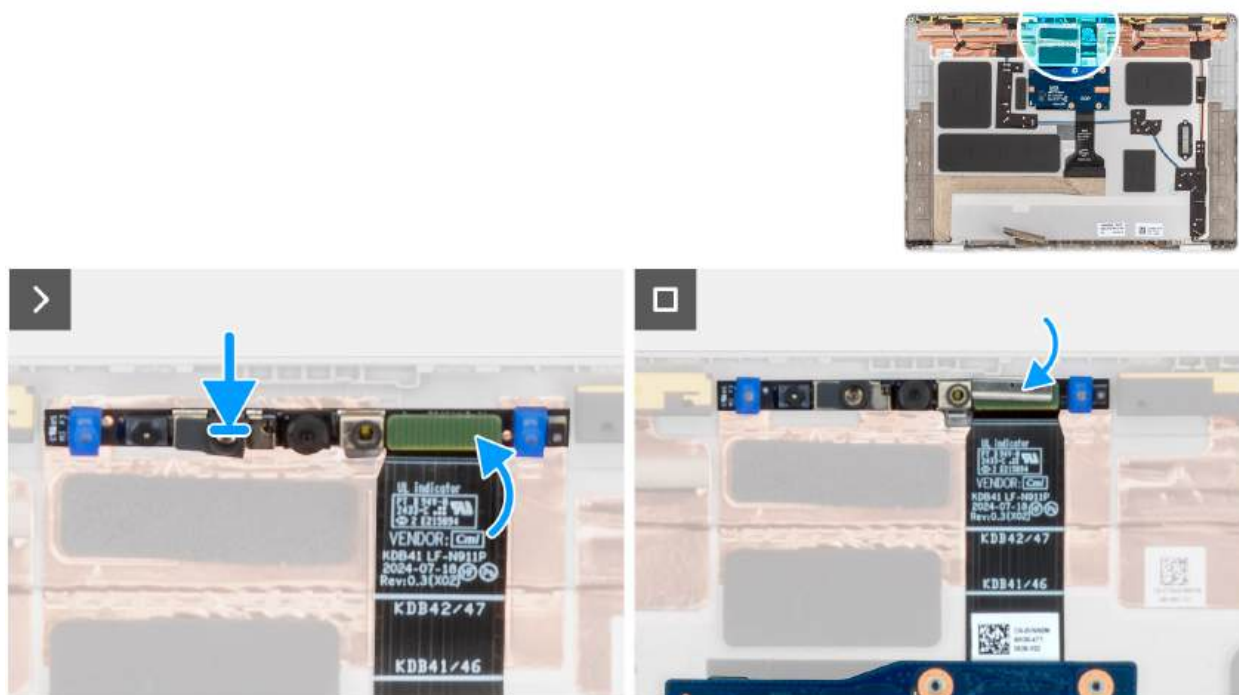
Rysunek 84. Instalowanie kamery MIPI
