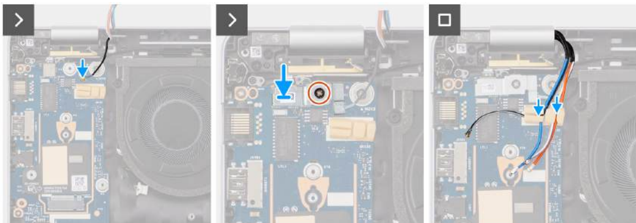
Rysunek 54. Instalowanie modułów anten sieci WLAN
