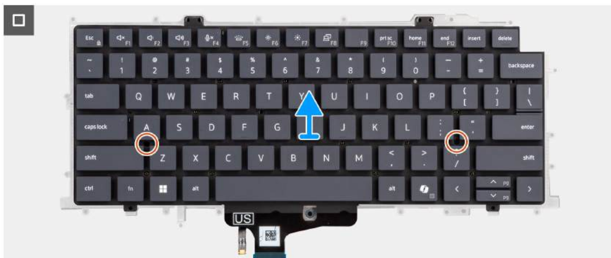
Rysunek 98. Wymontowywanie klawiatury
