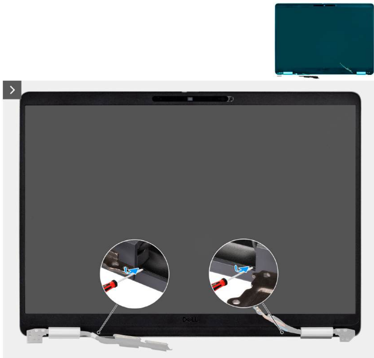
Rysunek 65. Podważanie plastikowej ramki
