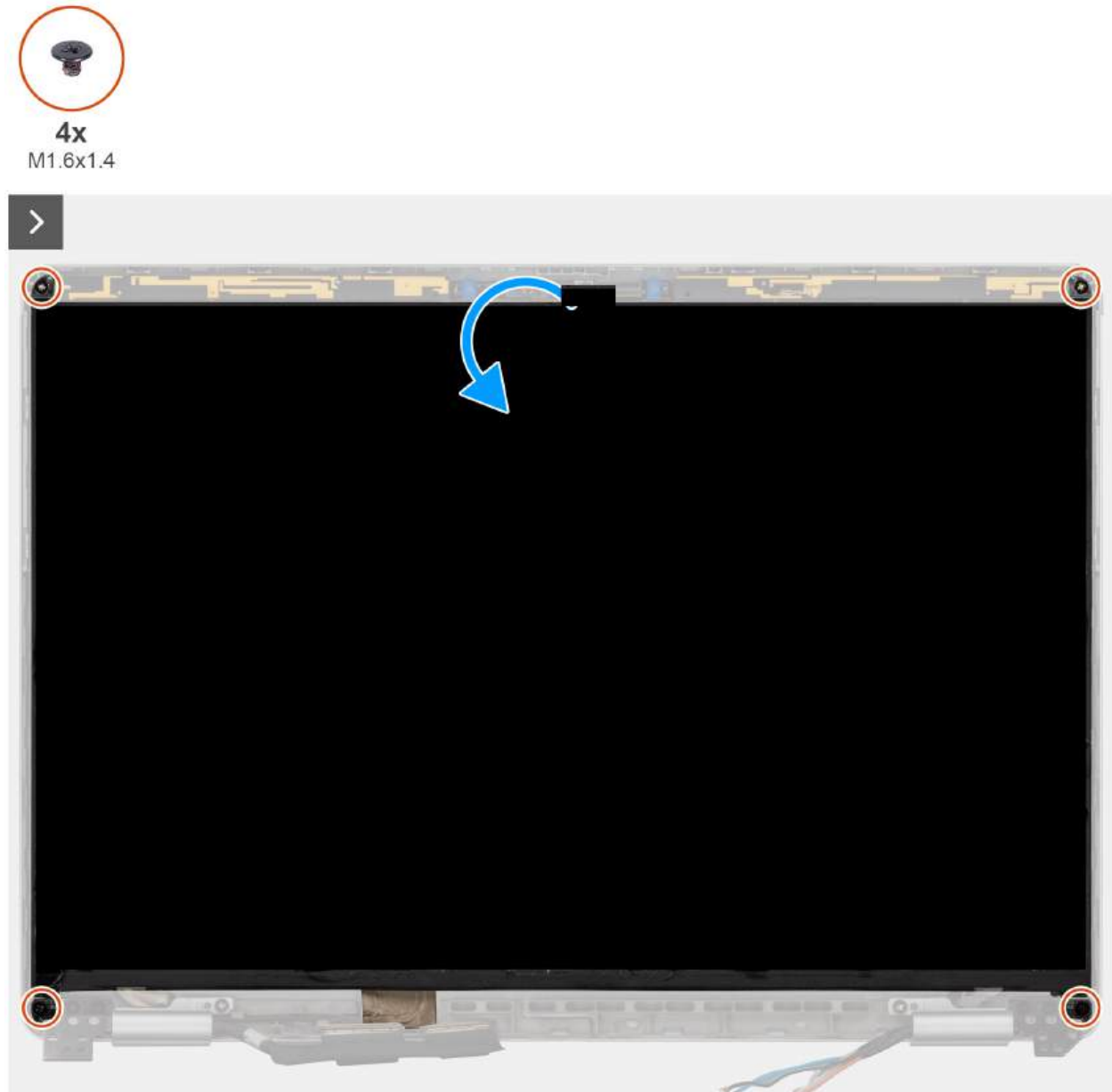
Rysunek 72. Wymontowywanie wyświetlacza
