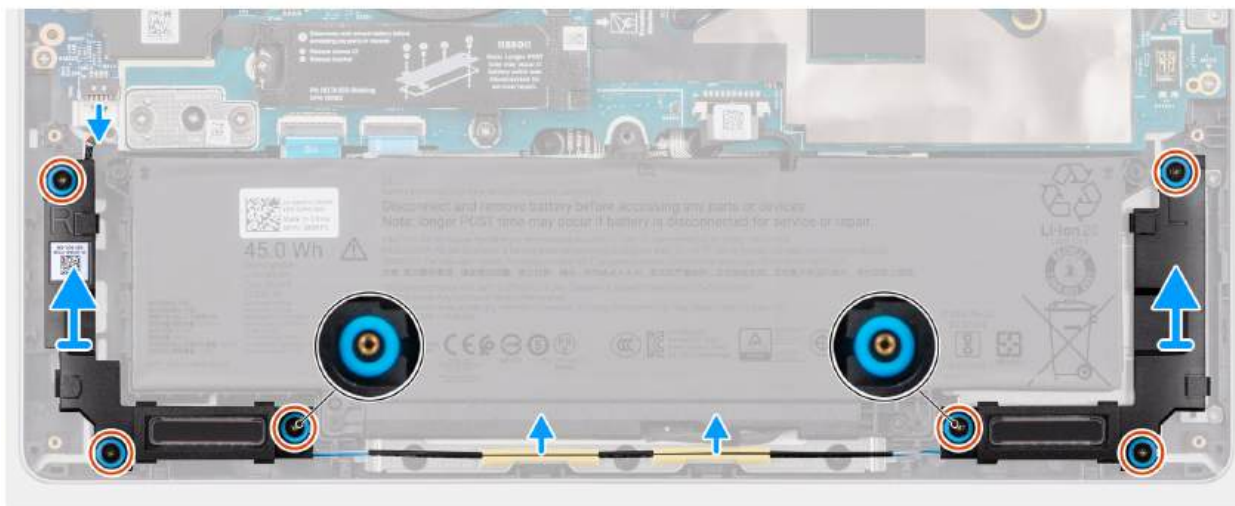
Rysunek 35. Wymontowywanie głośników
