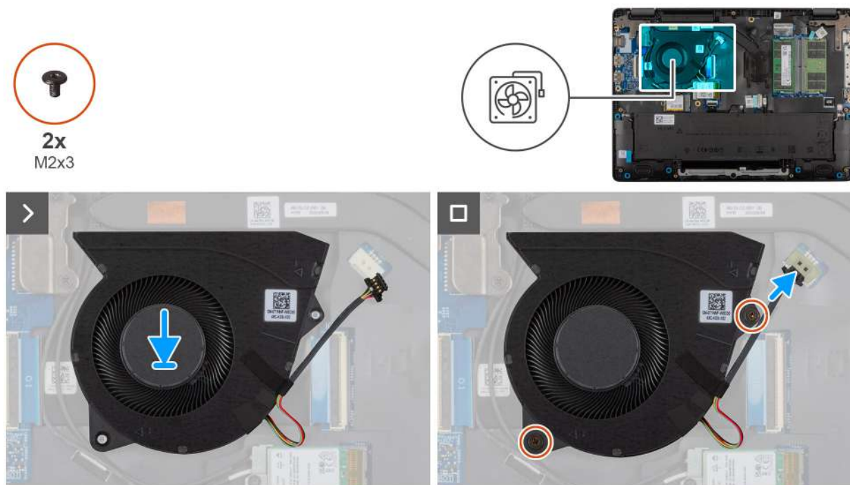
Rysunek 34. Instalowanie wentylatora
