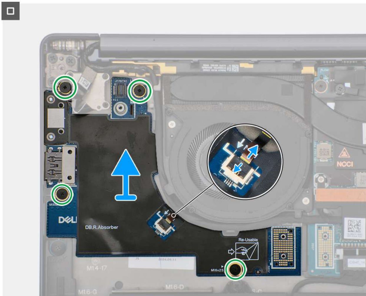
Rysunek 45. Wymowanie prawej płyty we/wy (bez anten WWAN)
