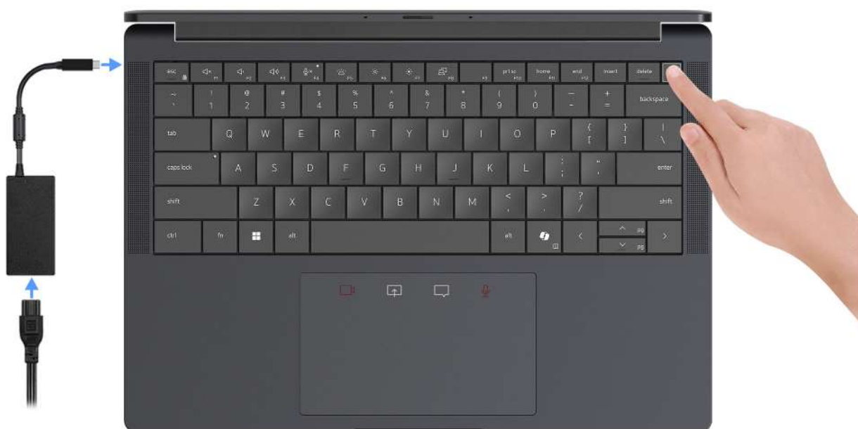
Rysunek 8. Podłącz zasilacz i naciśnij przycisk zasilania.
