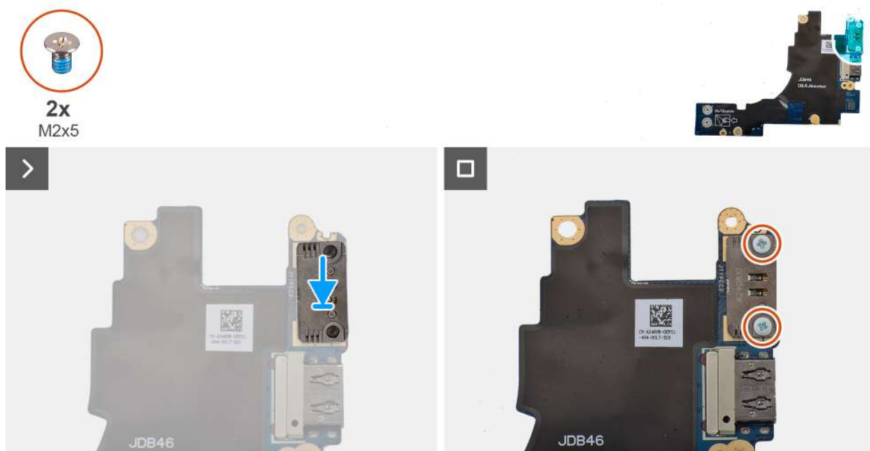
Rysunek 57. Instalowanie lewego modułu USB typu C
