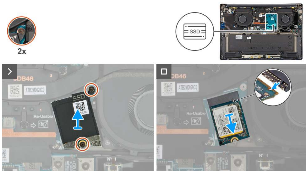
Rysunek 26. Wymontowywanie dysku SSD
