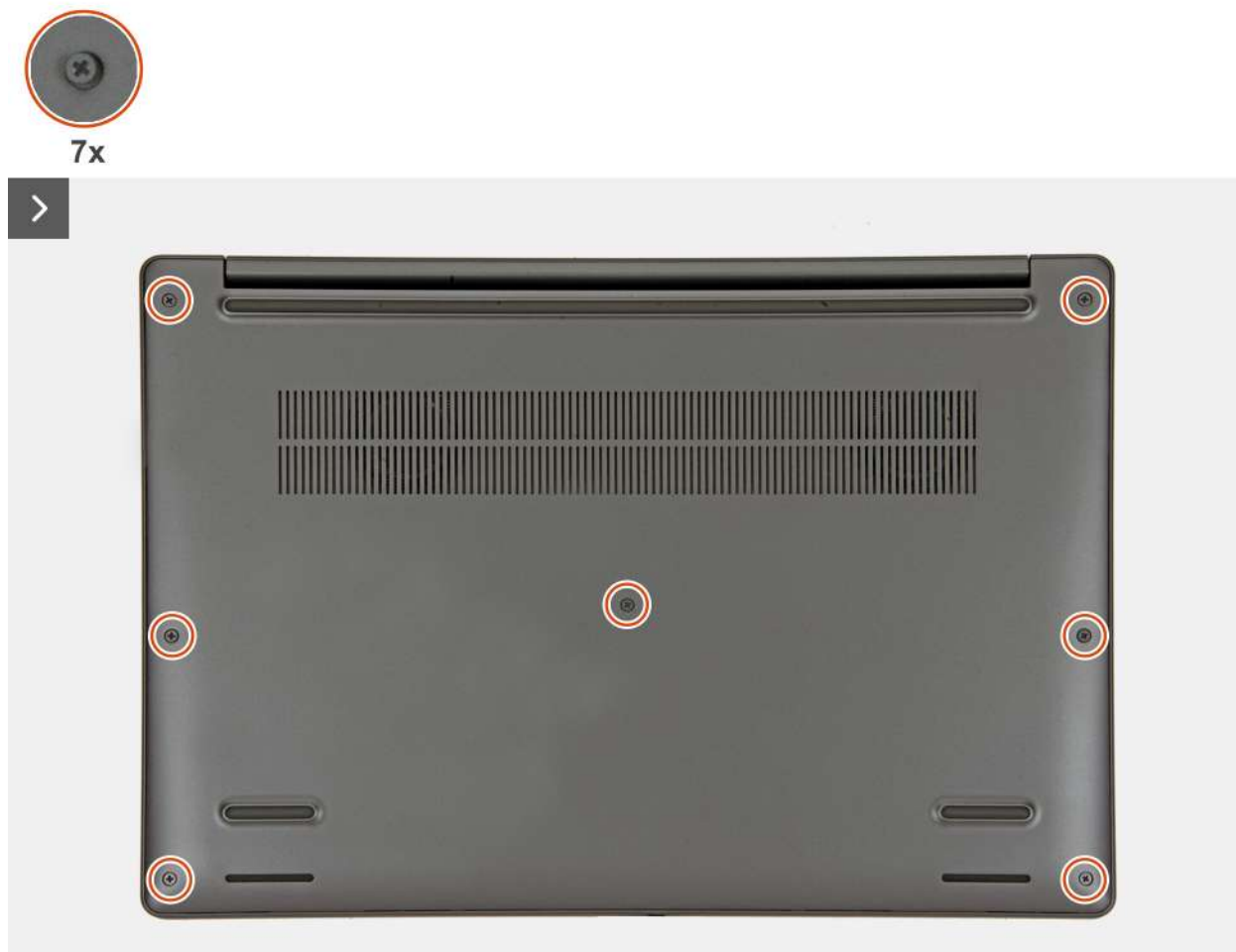
Rysunek 16. Luzowanie śrub mocujących
