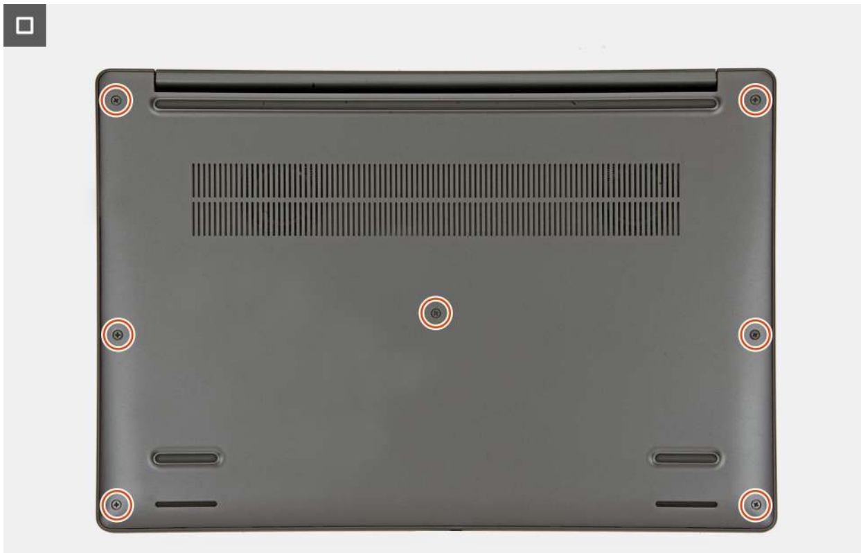
Rysunek 21. Dokręcanie śrub mocujących
