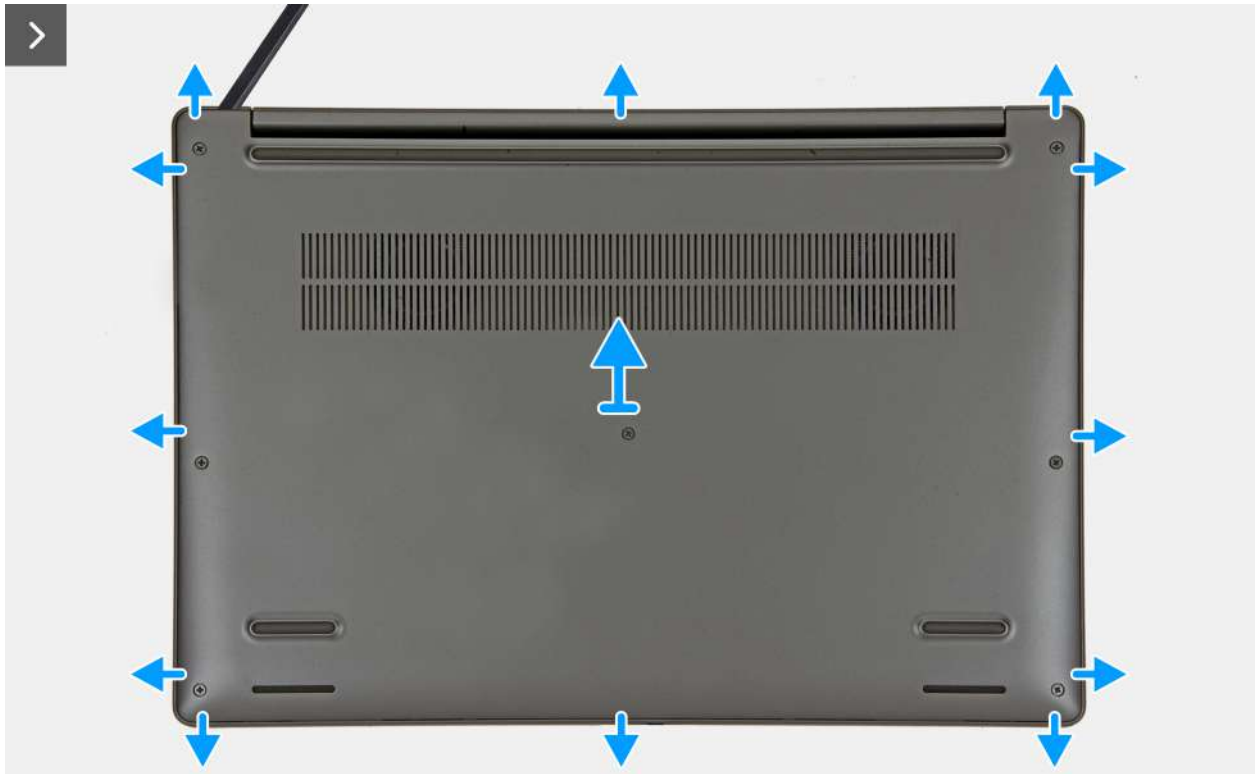
Rysunek 17. Wymontowywanie pokrywy dolnej
