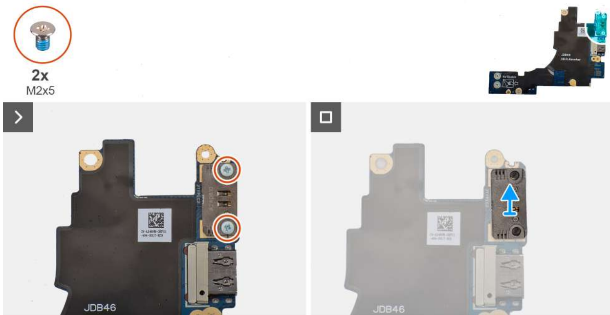
Rysunek 56. Wyjmowanie lewego modułu USB typu C
