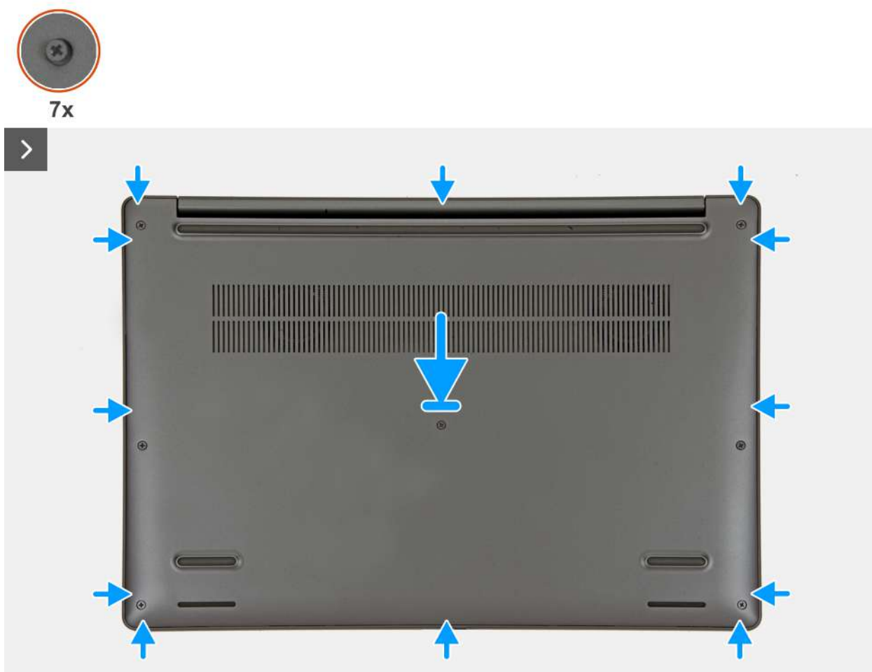
Rysunek 20. Instalowanie pokrywy dolnej
