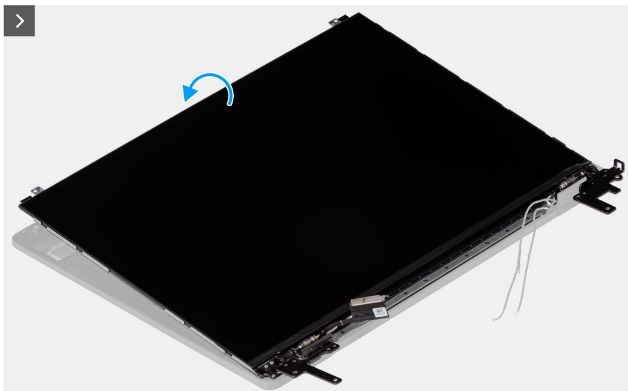
Rysunek 111. Instalowanie zestawu panelu wyświetlacza
