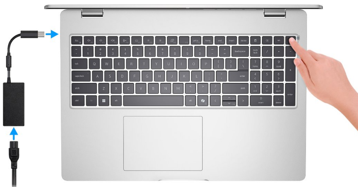
Rysunek 7. Podłącz zasilacz i naciśnij przycisk zasilania.
