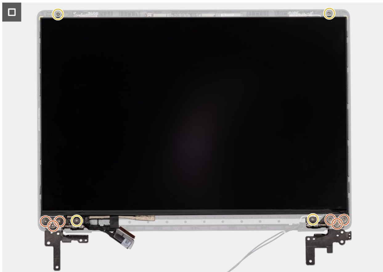
Rysunek 112. Instalowanie zestawu panelu wyświetlacza
