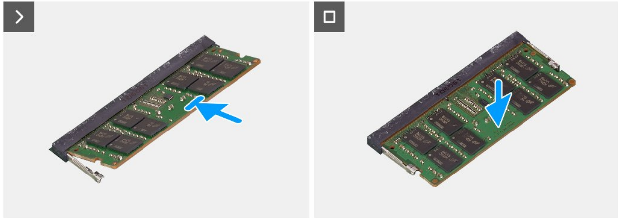
Rysunek 22. Instalowanie modułu pamięci
