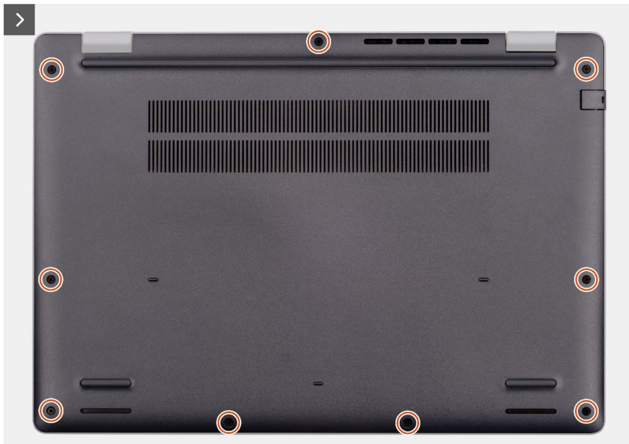
Rysunek 11. Wymontowywanie pokrywy dolnej
