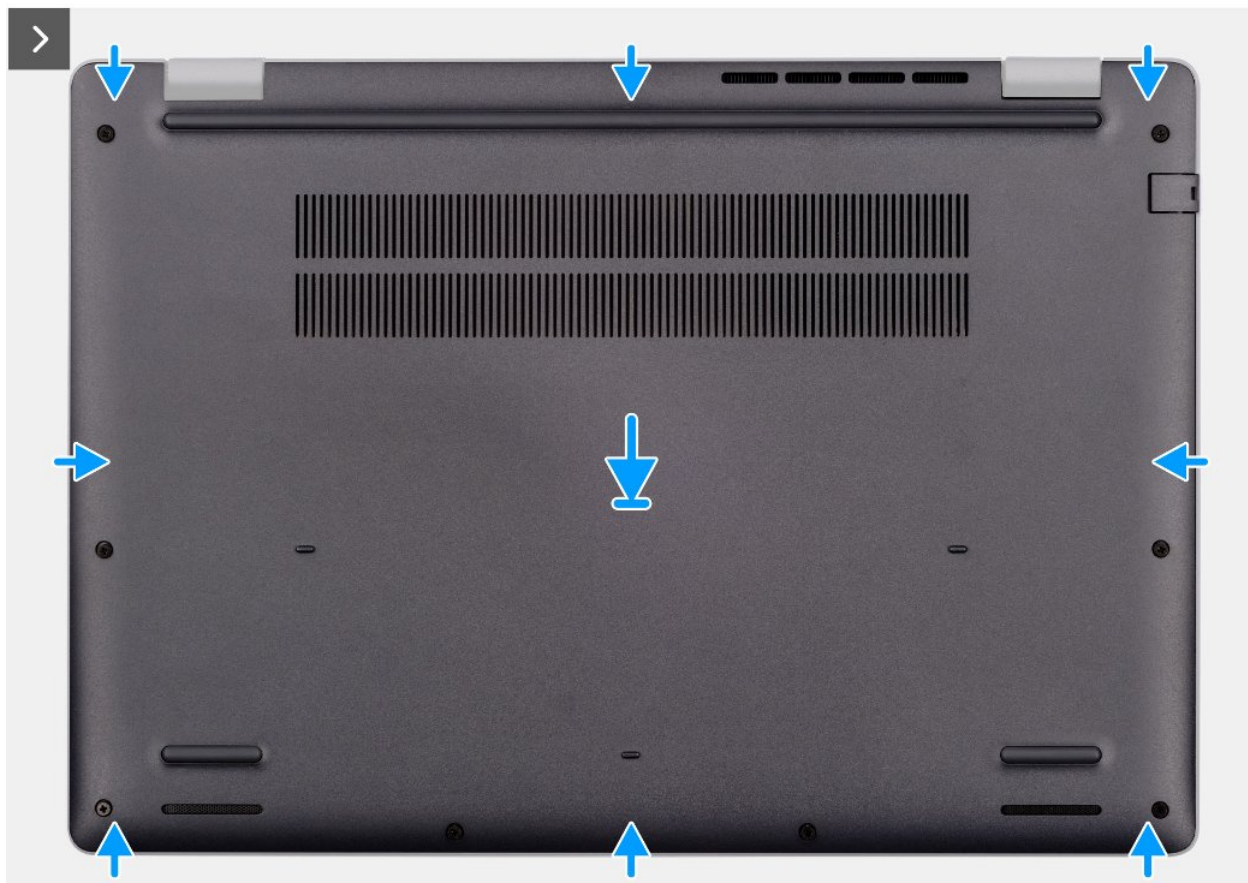
Rysunek 15. Instalowanie pokrywy dolnej
