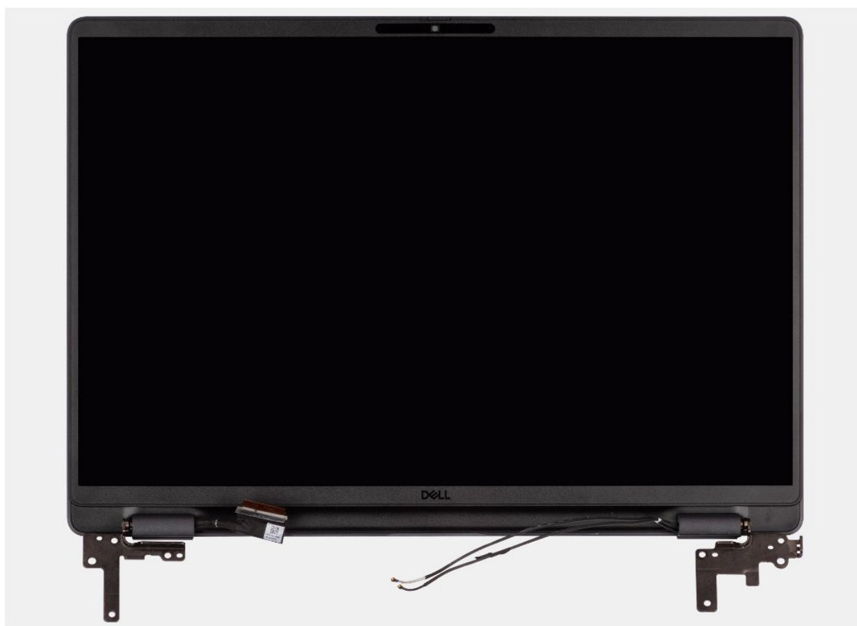
Rysunek 95. Wymontowywanie zestawu wyświetlacza
