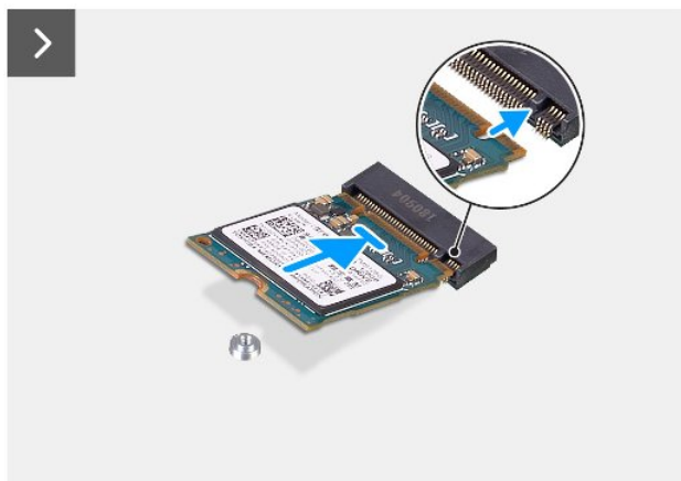
Rysunek 24. Instalowanie karty sieci SSD
