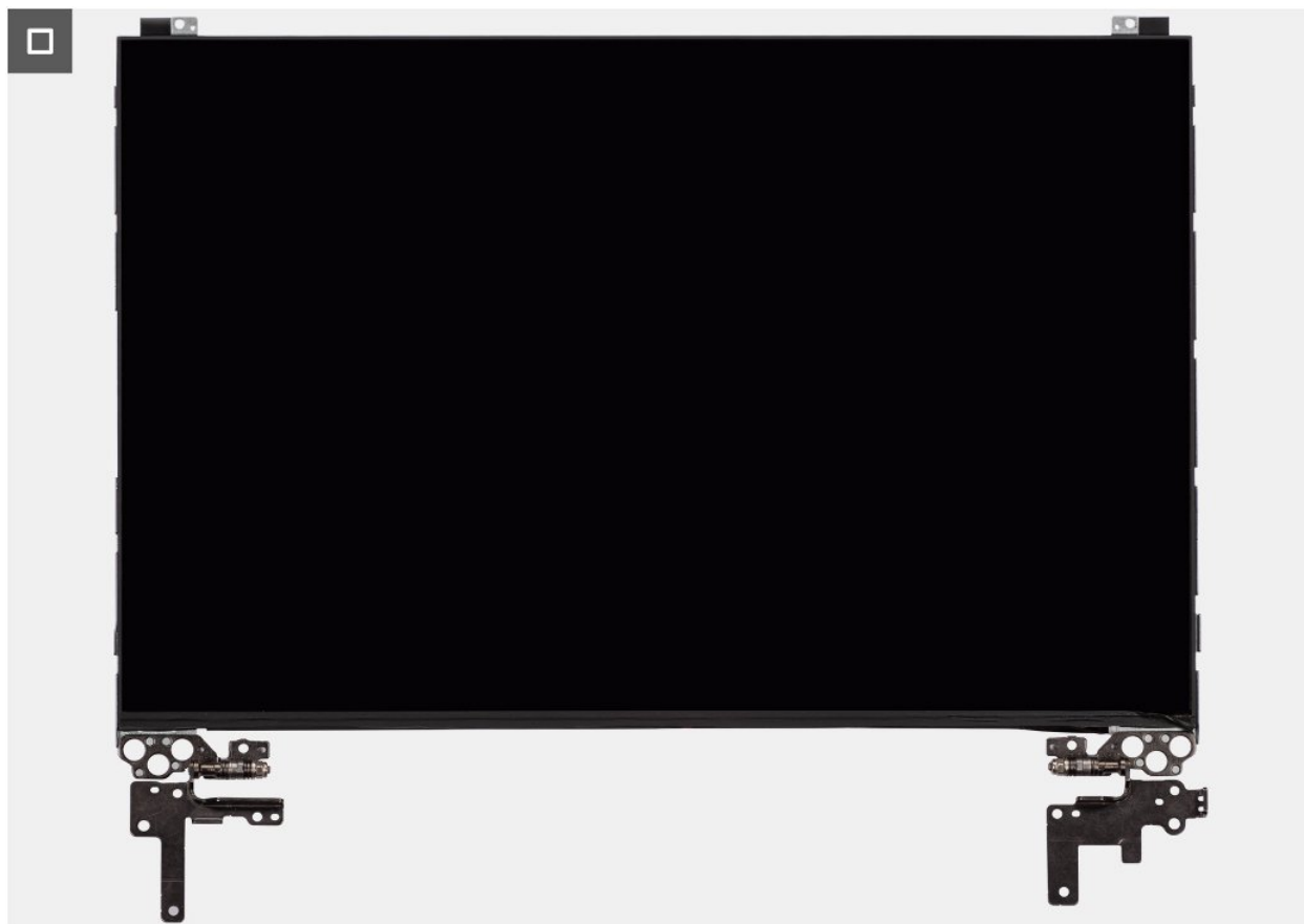
Rysunek 108. Wymontowywanie zestawu panelu wyświetlacza
