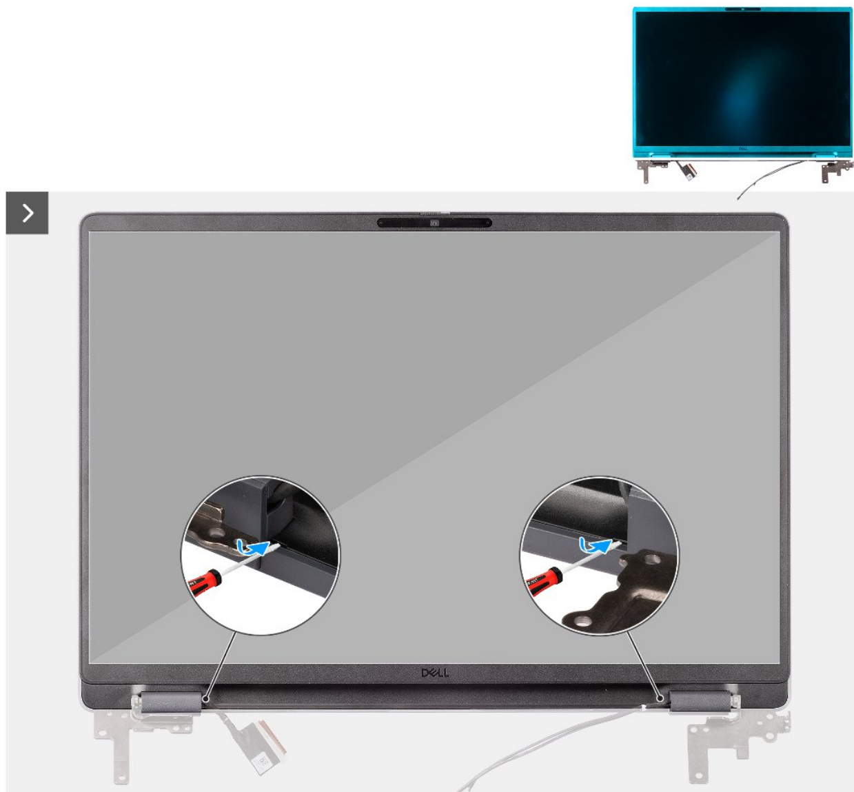
Rysunek 98. Wymontowywanie ramki wyświetlacza
