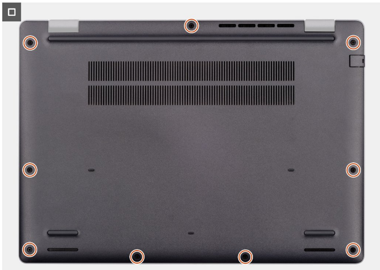
Rysunek 16. Instalowanie pokrywy dolnej
