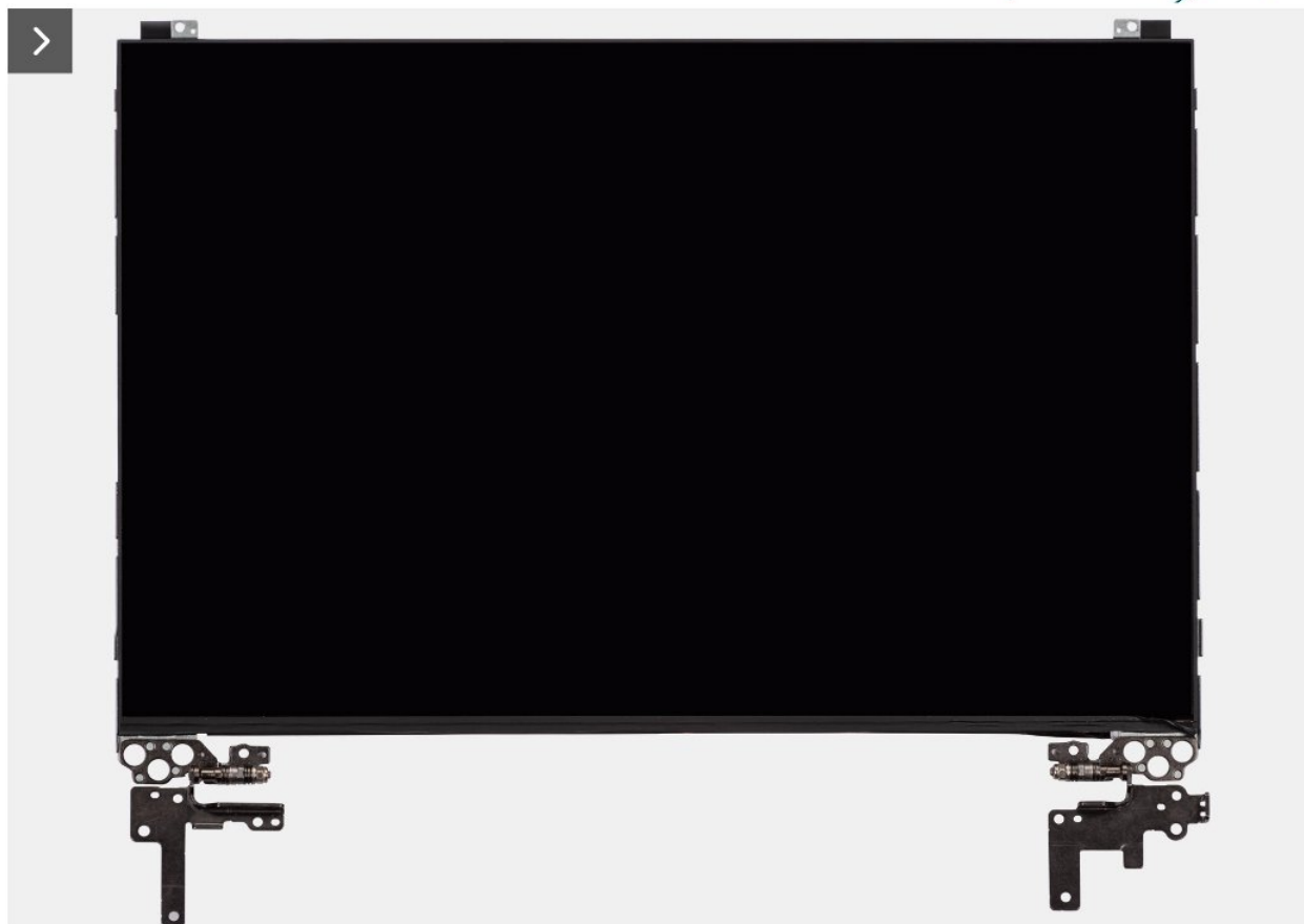
Rysunek 109. Instalowanie zestawu panelu wyświetlacza
