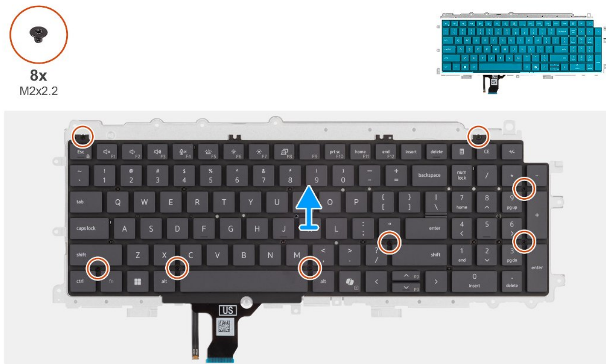
Rysunek 85. Wymontowywanie płyty nośnej klawiatury
