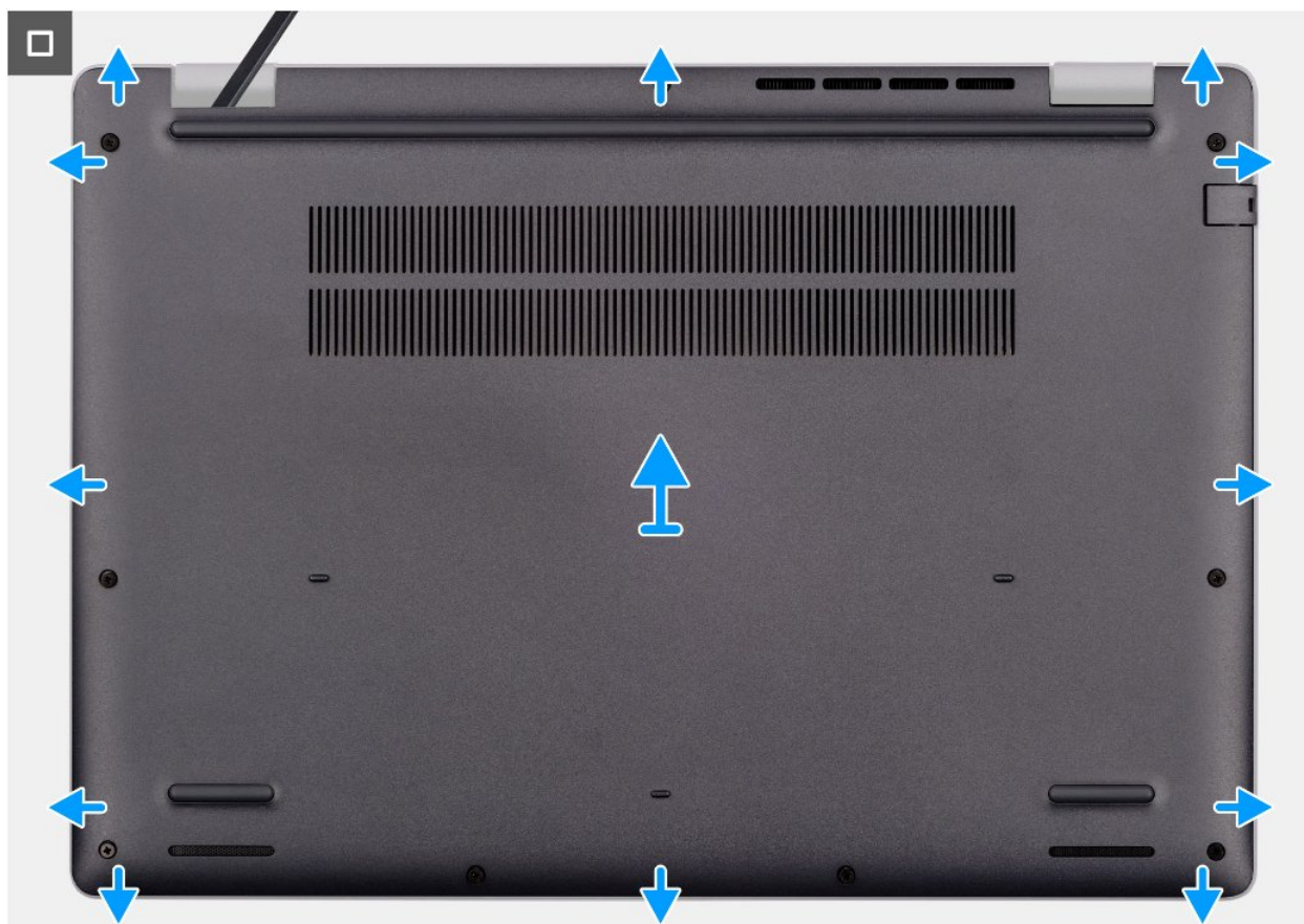
Rysunek 12. Wymontowywanie pokrywy dolnej
