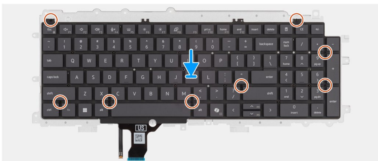
Rysunek 88. Instalowanie płyty nośnej klawiatury
