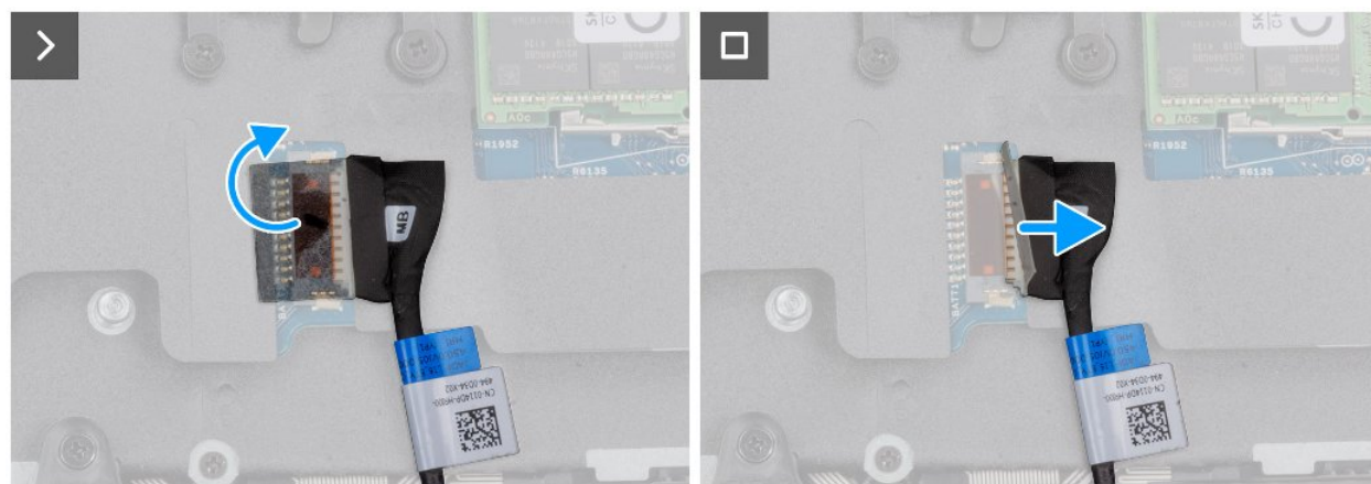
Rysunek 13. Odłączanie kabla baterii
