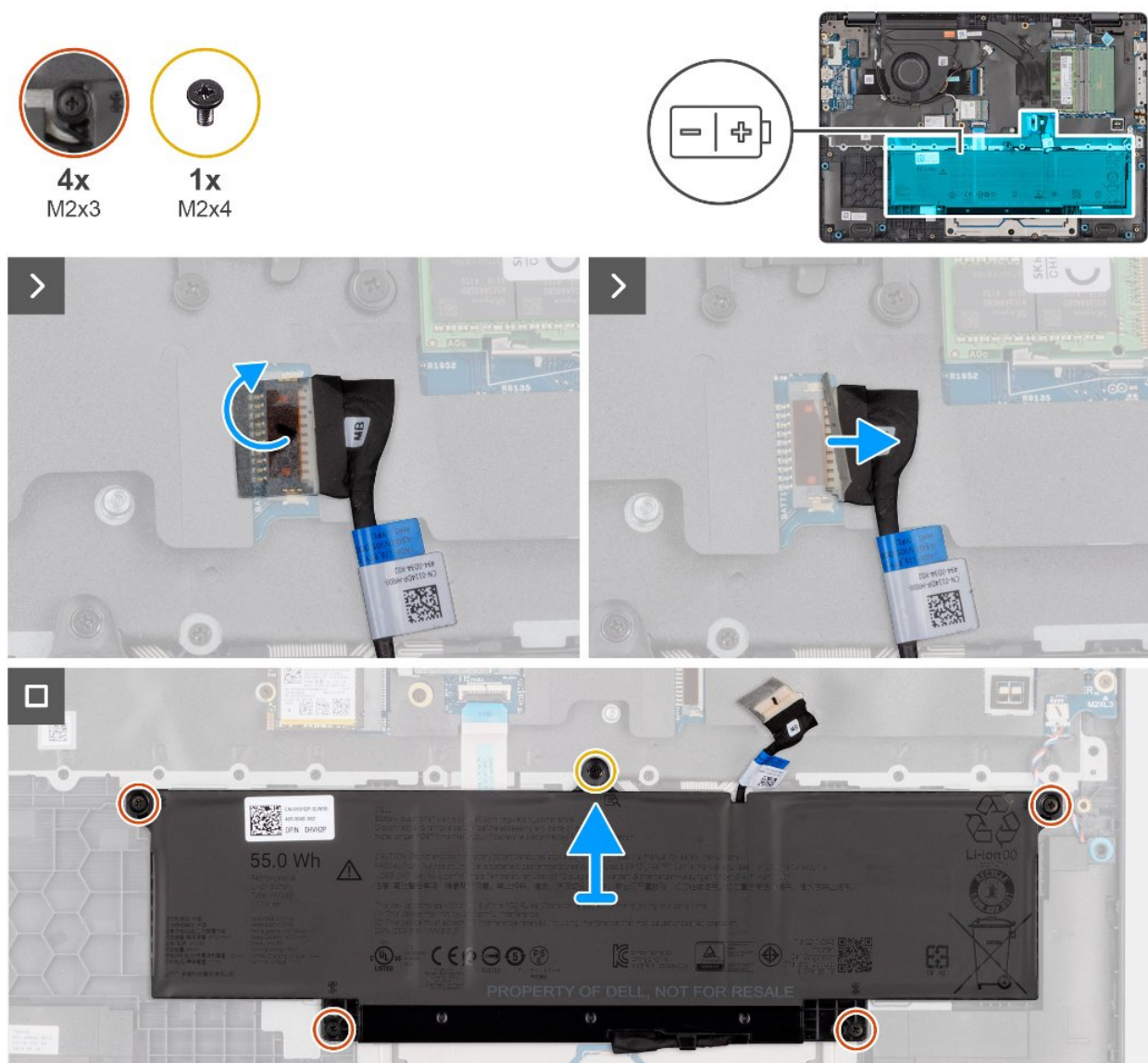
Rysunek 17. Wymontowywanie baterii
