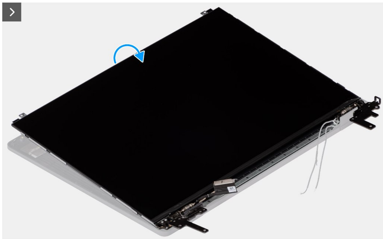
Rysunek 106. Wymontowywanie zestawu panelu wyświetlacza
