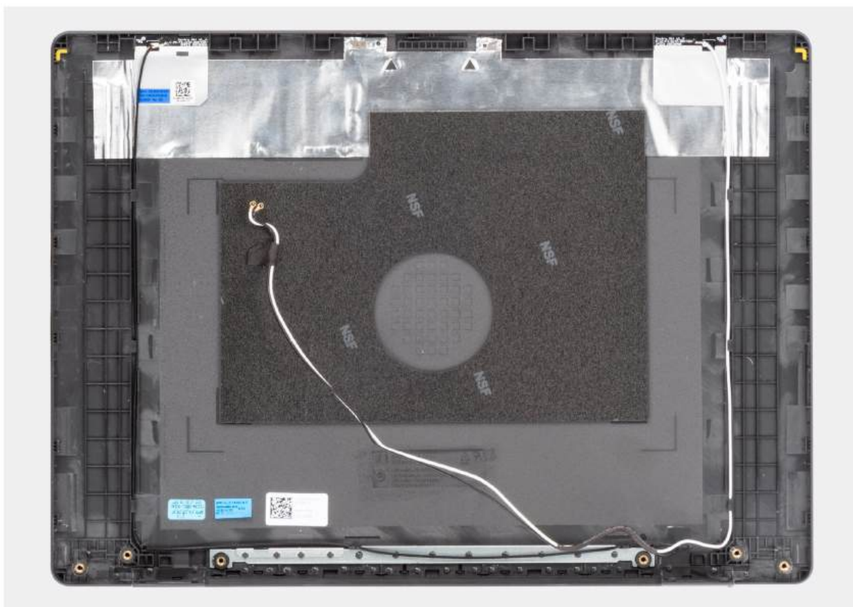
Rysunek 90. Zestaw pokrywy wyświetlacza i anteny
