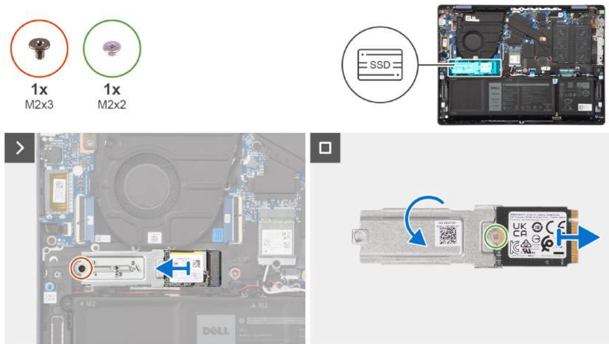
Rysunek 34. Wymontowywanie dysku SSD
