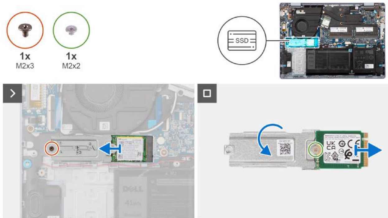
Rysunek 32. Wymontowywanie dysku SSD
