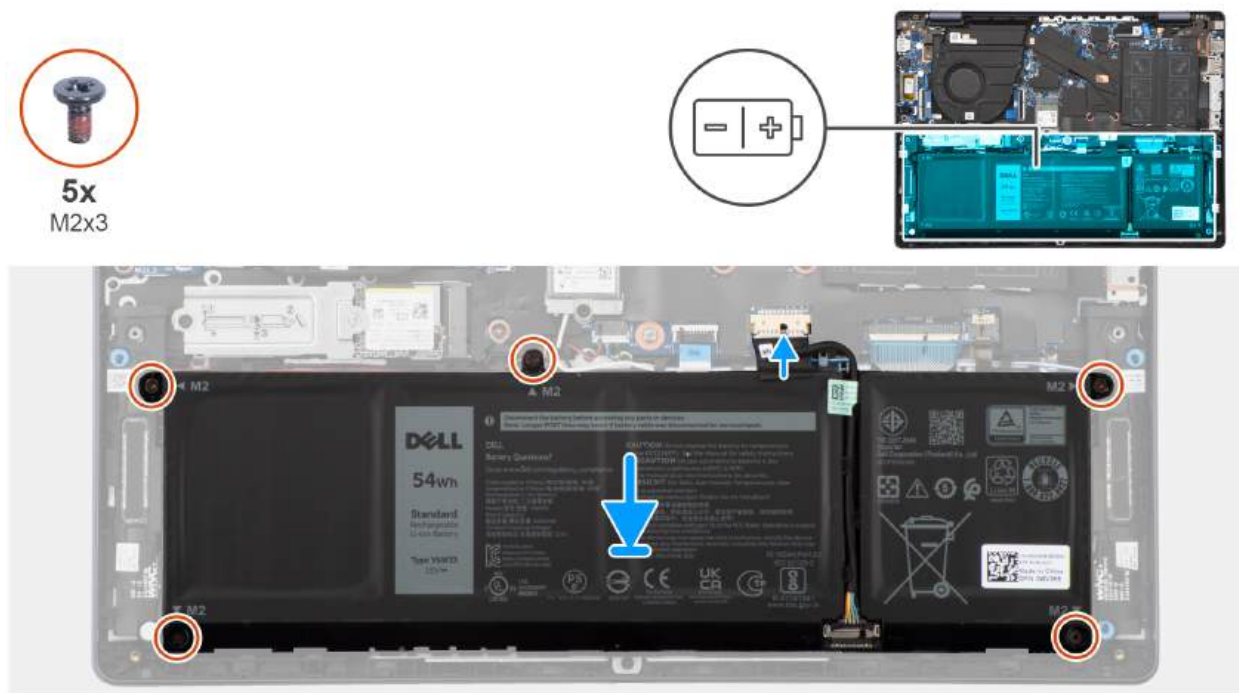
Rysunek 25. Instalowanie baterii
