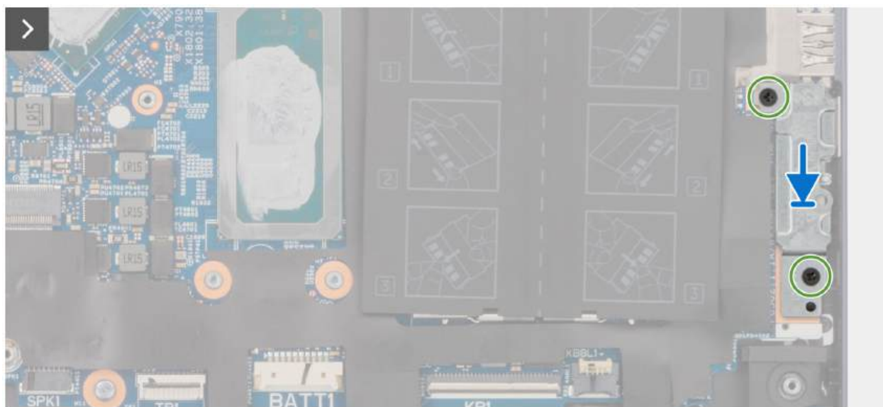
Rysunek 106. Instalowanie klamry portu USB Type-C
