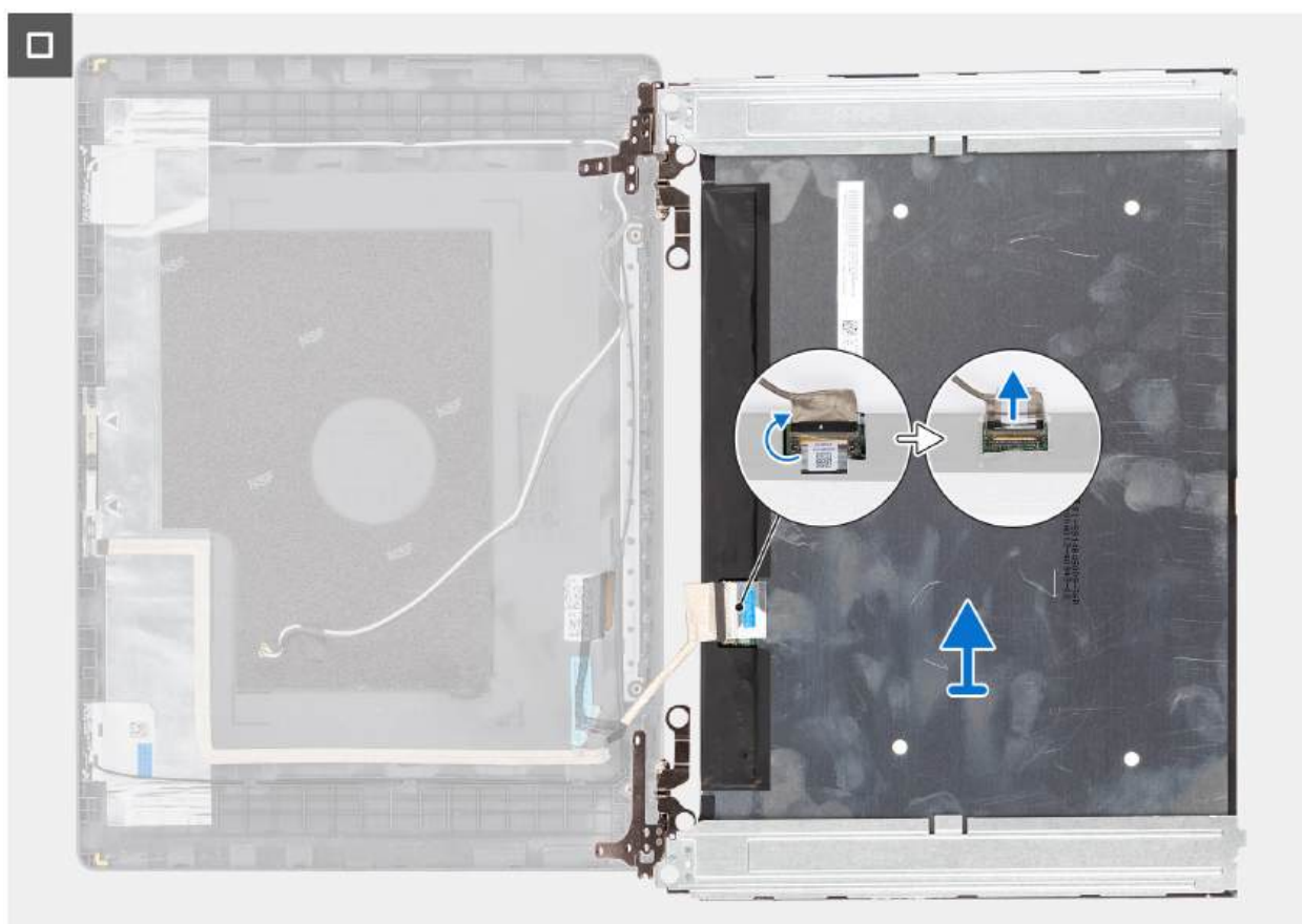
Rysunek 79. Wymontowywanie wyświetlacza
