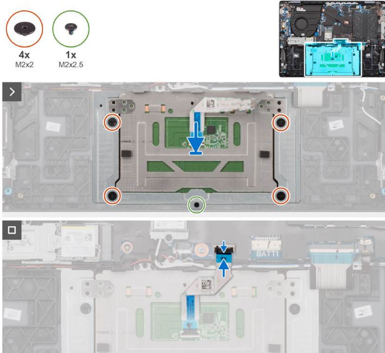
Rysunek 61. Instalowanie touchpada
