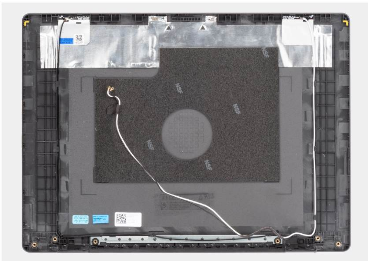
Rysunek 89. Zestaw pokrywy wyświetlacza i anteny
