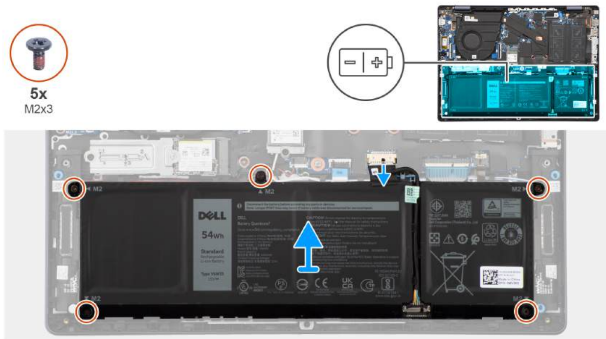
Rysunek 24. Wymontowywanie akumulatorów
