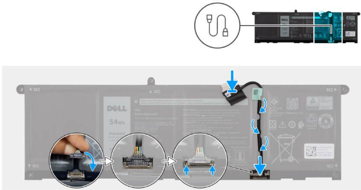
Rysunek 27. Podłączanie kabla baterii
