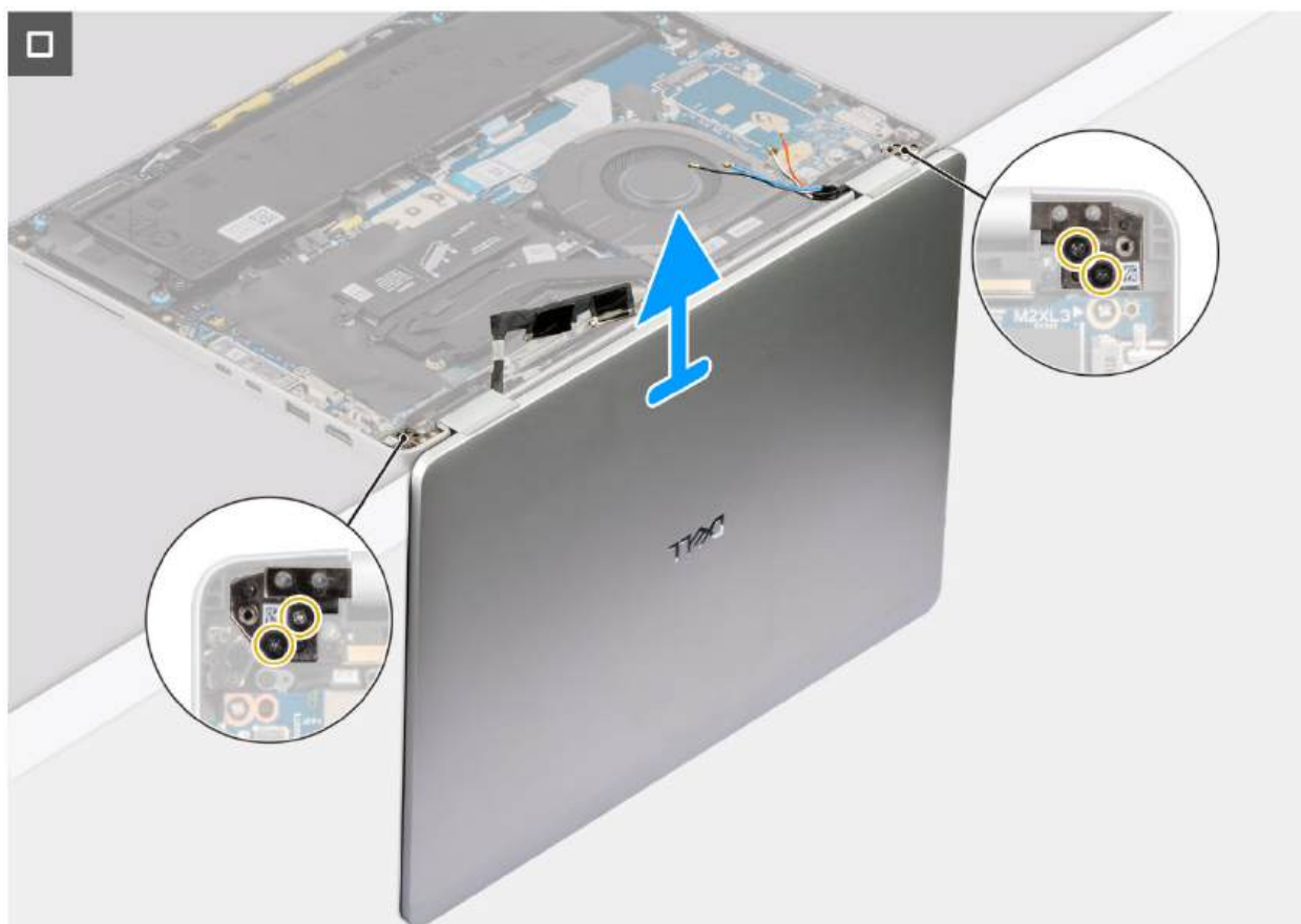
Rysunek 58. Wymontowywanie zestawu wyświetlacza
