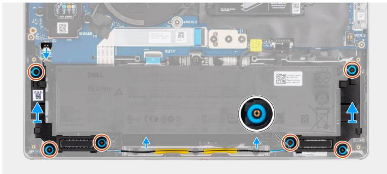
Rysunek 37. Wymontowywanie głośników
