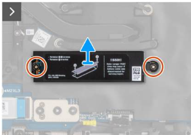
Rysunek 35. Wymontowywanie dysku SSD M.2 2280
