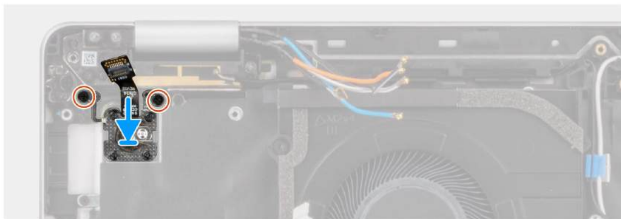
Rysunek 56. Instalowanie przycisku zasilania z opcjonalnym czytnikiem linii papilarnych
