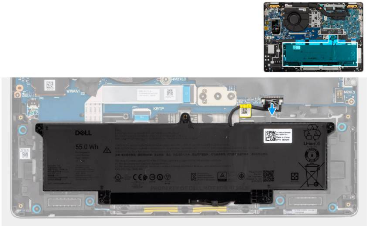
Rysunek 24. Odłączanie kabla baterii
