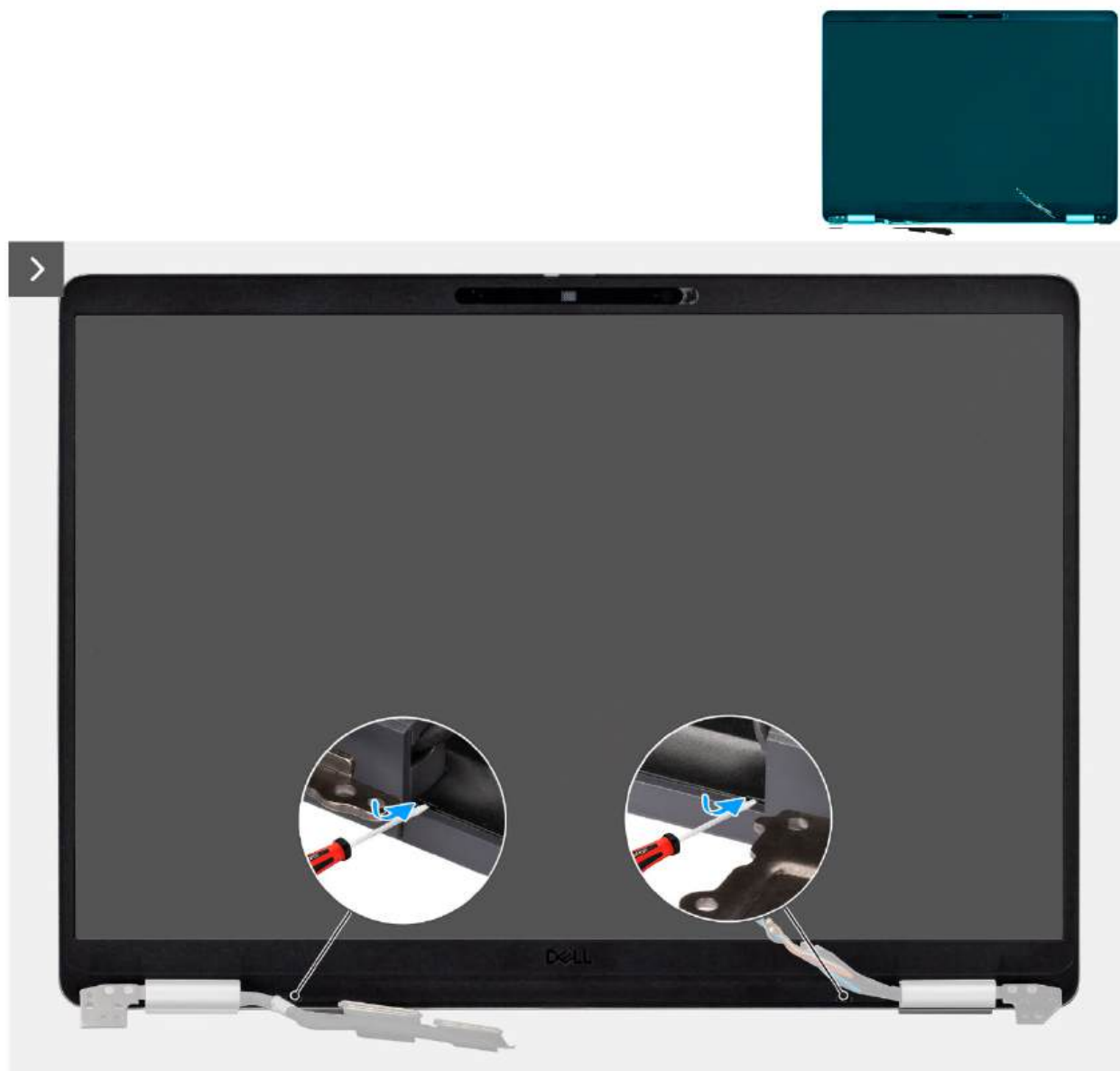
Rysunek 61. Wymontowywanie ramki wyświetlacza
