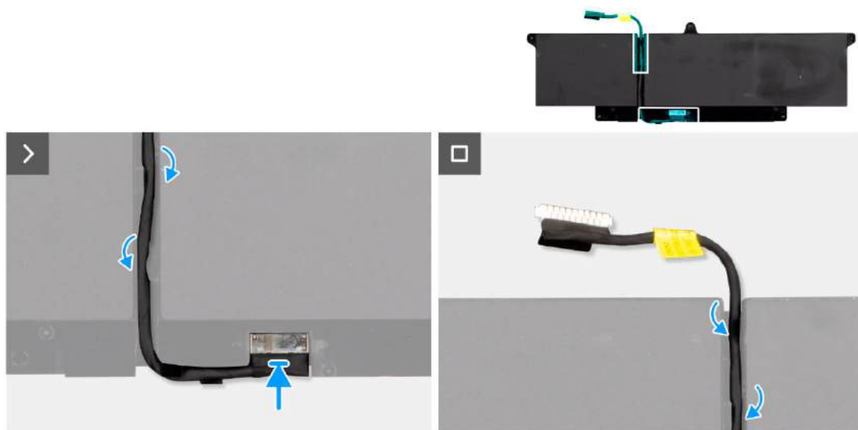
Rysunek 30. Instalowanie kabla baterii
