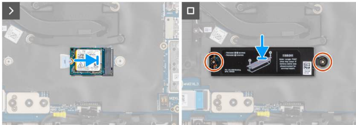
Rysunek 34. Instalowanie dysku SSD M.2 2230
