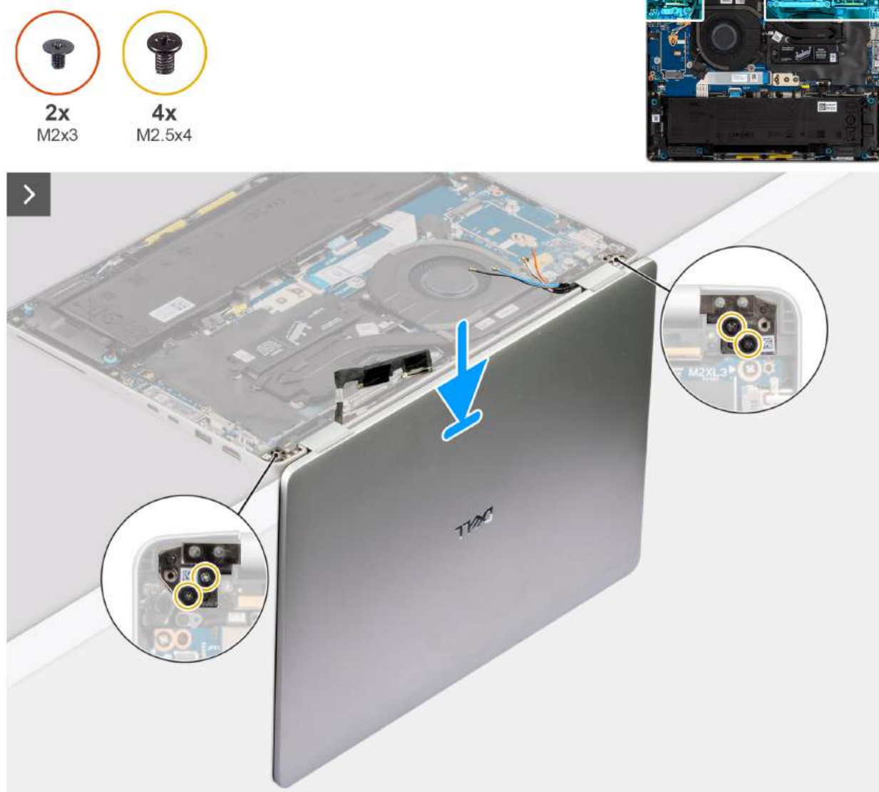
Rysunek 59. Instalowanie zestawu wyświetlacza
