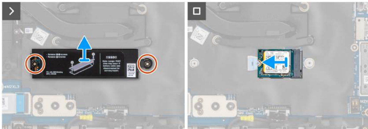
Rysunek 33. Wymontowywanie dysku SSD M.2 2230
