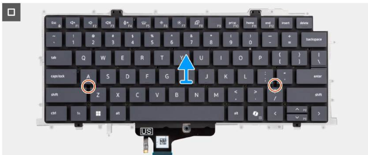
Rysunek 82. Wymontowywanie klawiatury
