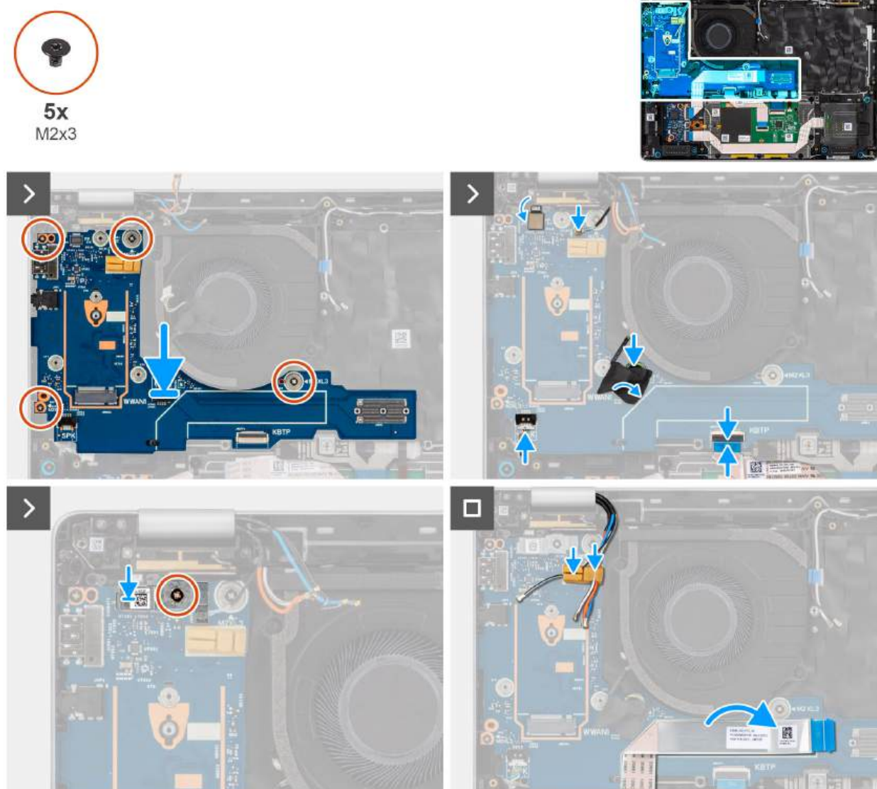
Rysunek 54. Instalowanie płyty we/wy
