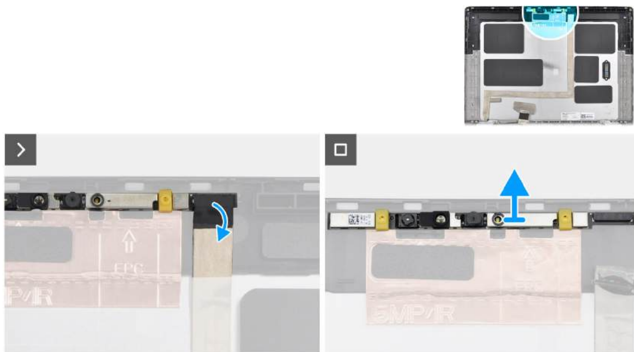
Rysunek 75. Wymontowywanie kamery RGB/IR
