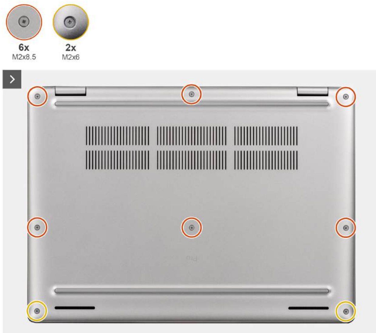
Rysunek 22. Wymontowywanie pokrywy dolnej
