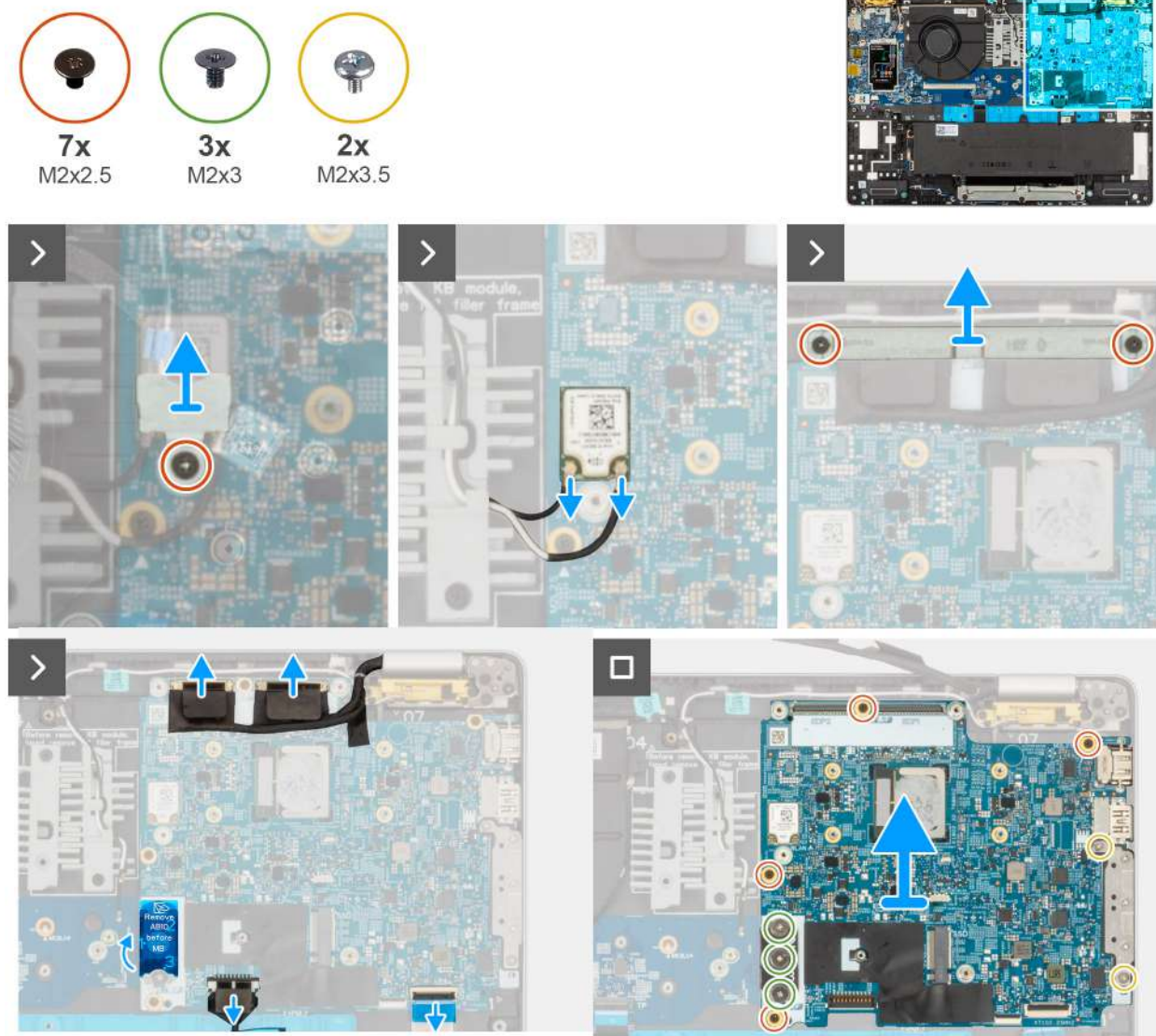
Rysunek 48. Wymontowywanie płyty głównej
