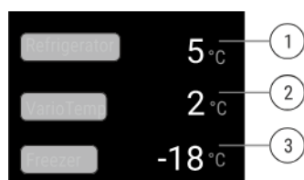
Fig. 7 Wskaźnik statusu pokazuje temperaturę rzeczywistą.
