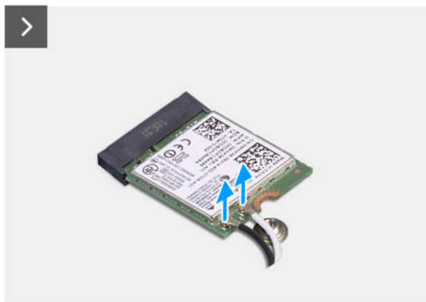
Rysunek 27. Wymontowywanie karty sieci bezprzewodowej
