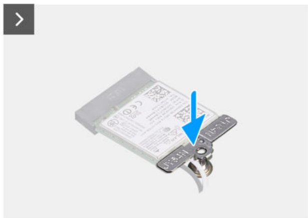
Rysunek 28. Instalowanie karty sieci bezprzewodowej
