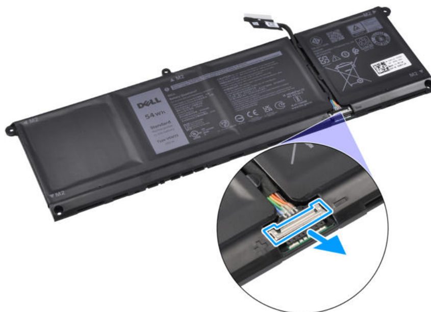
Rysunek 20. Odłączanie złącza kabla baterii
