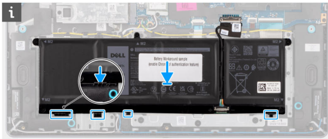
Rysunek 18. Instalowanie baterii — wkładanie wypustek do zaczipów
