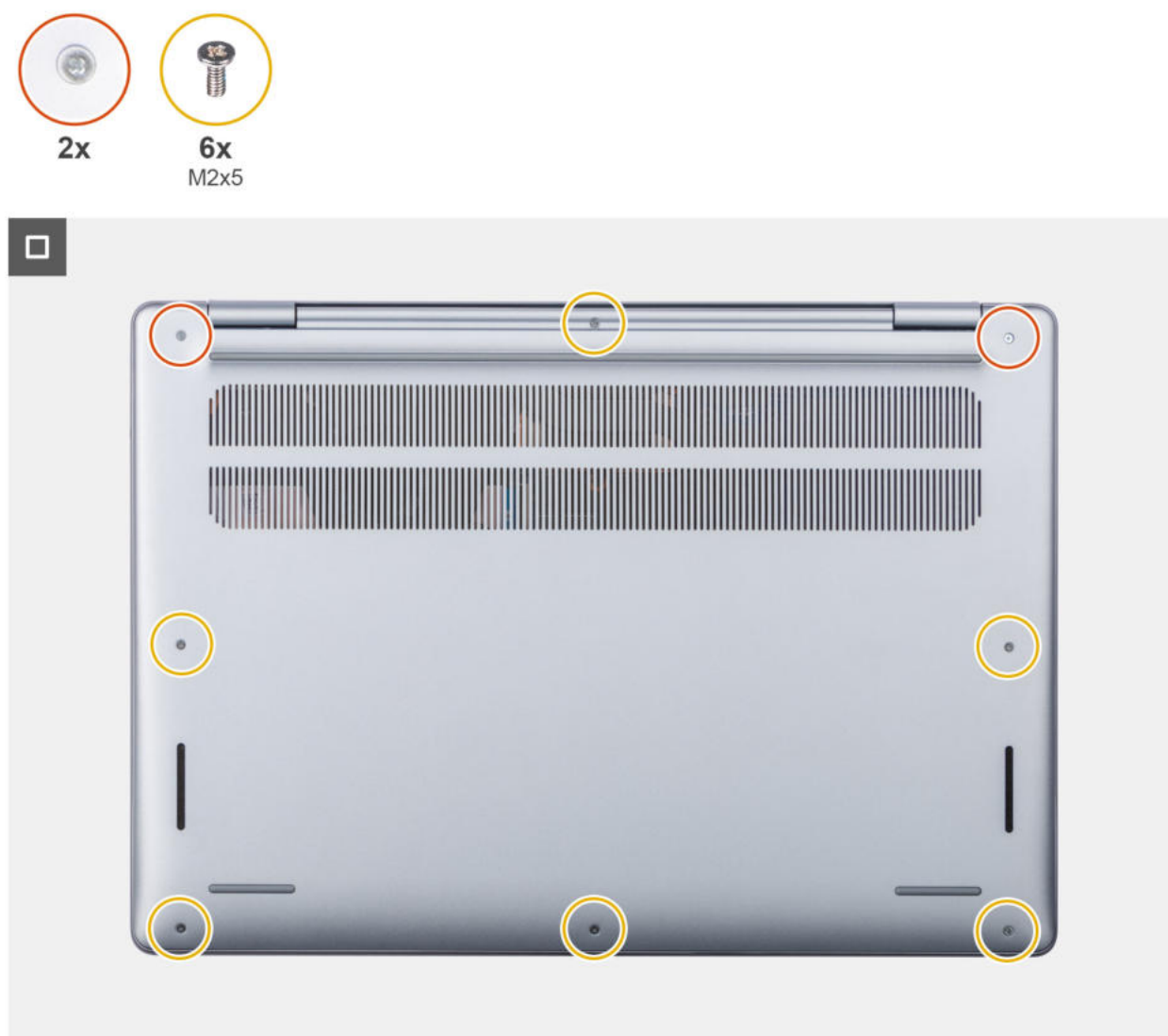
Rysunek 15. Instalowanie pokrywy dolnej
