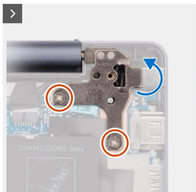
Rysunek 50. Wymontowywanie gniazda zasilacza
