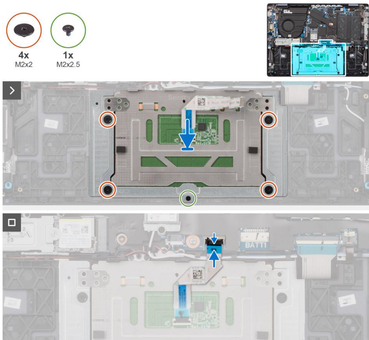
Rysunek 63. Instalowanie touchpada
