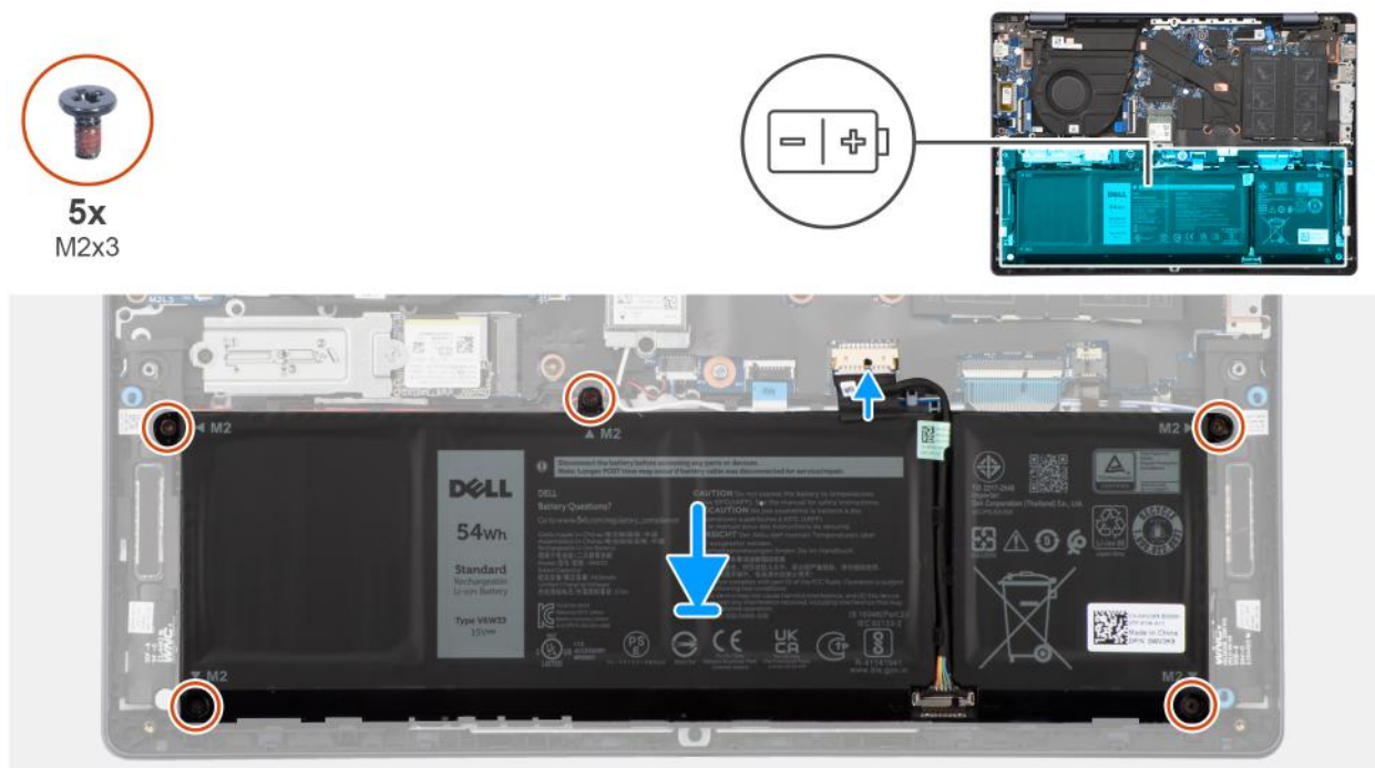
Rysunek 25. Instalowanie baterii
