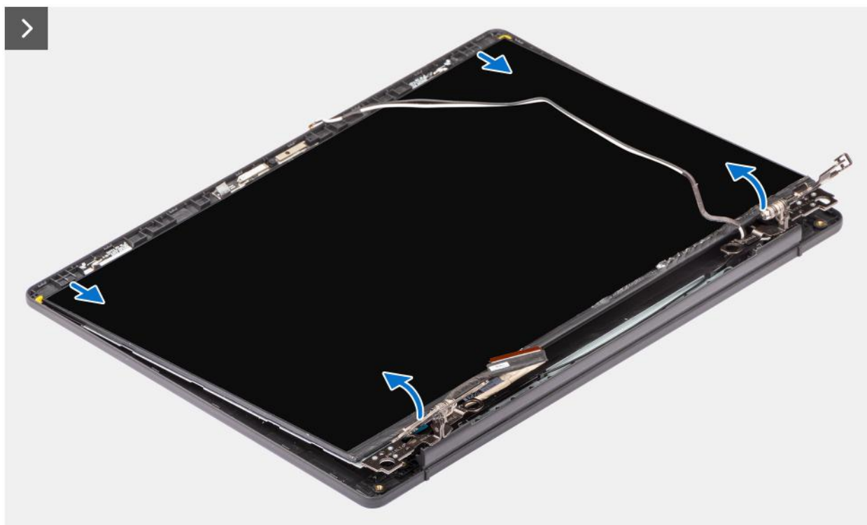
Rysunek 80. Wymontowywanie wyświetlacza
