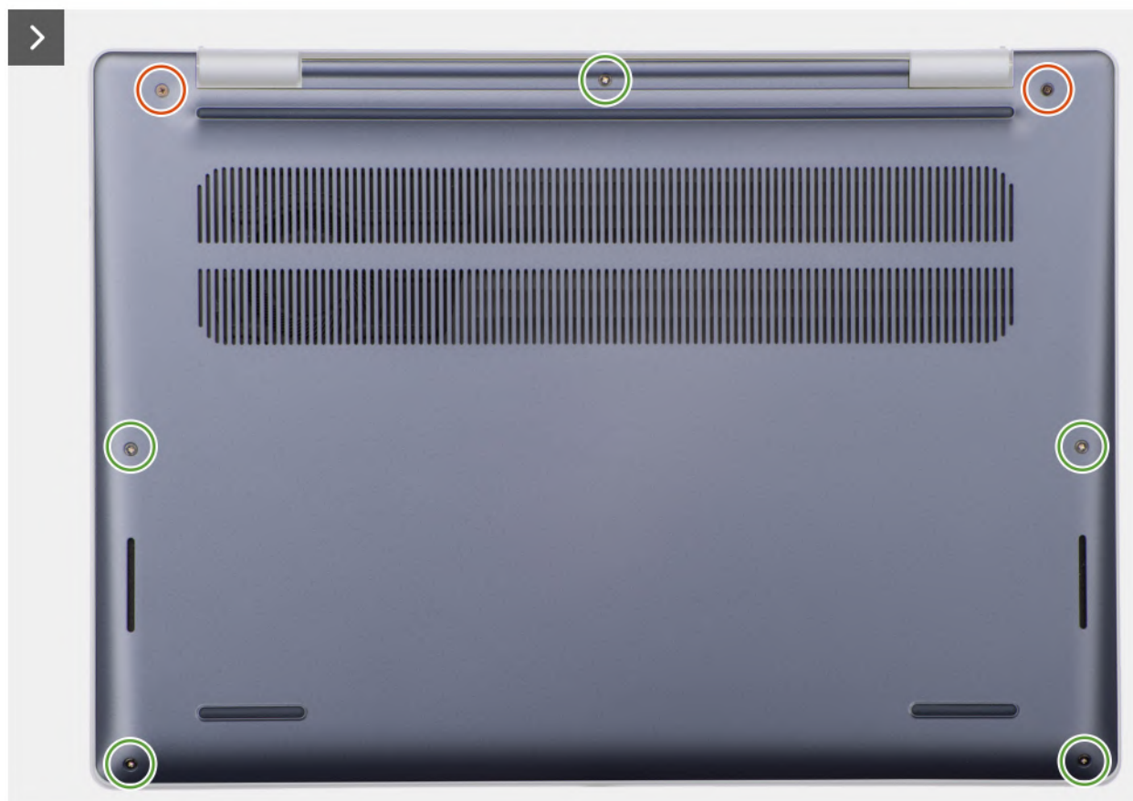
Rysunek 16. Wymontowywanie pokrywy dolnej
