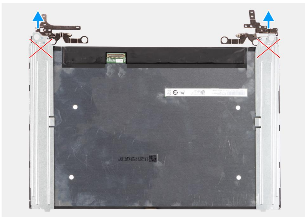
Rysunek 82. Wymontowywanie wyświetlacza
