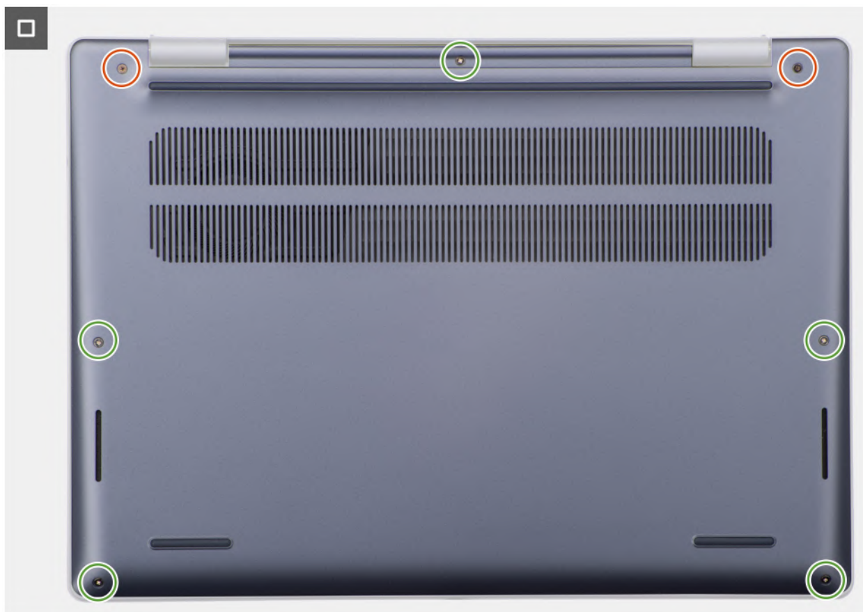
Rysunek 19. Instalowanie pokrywy dolnej
