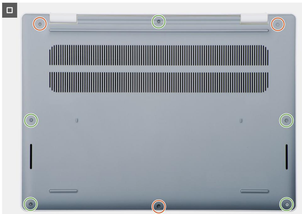
Rysunek 15. Instalowanie pokrywy dolnej
