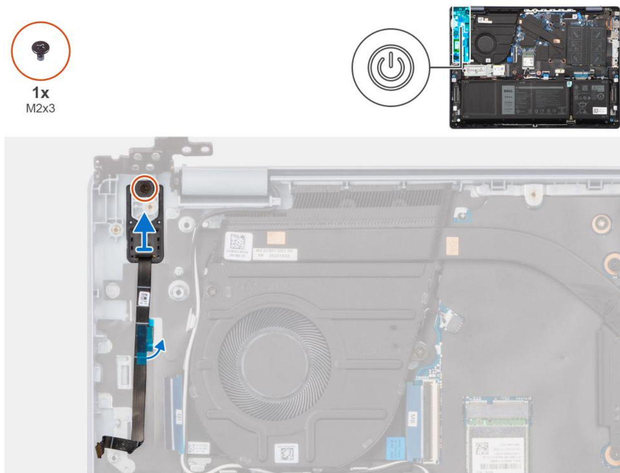
Rysunek 58. Wymontowywanie przycisku zasilania z czytnikiem linii papilarnych
