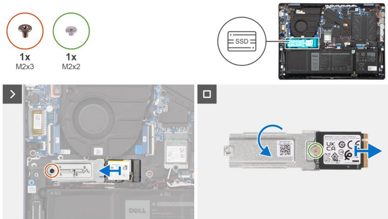
Rysunek 34. Wymontowywanie dysku SSD
