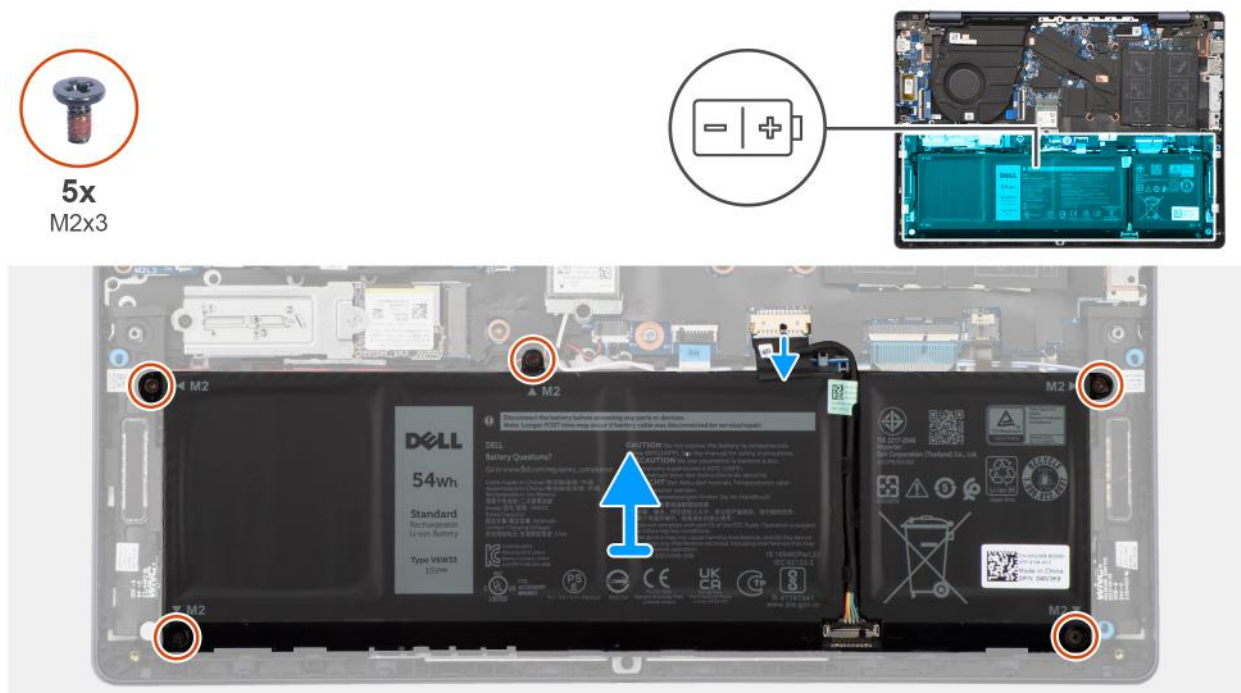
Rysunek 24. Wymontowywanie akumulatorów
