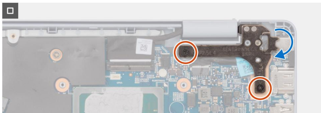
Rysunek 101. Wkręcanie śrub zawiasów
