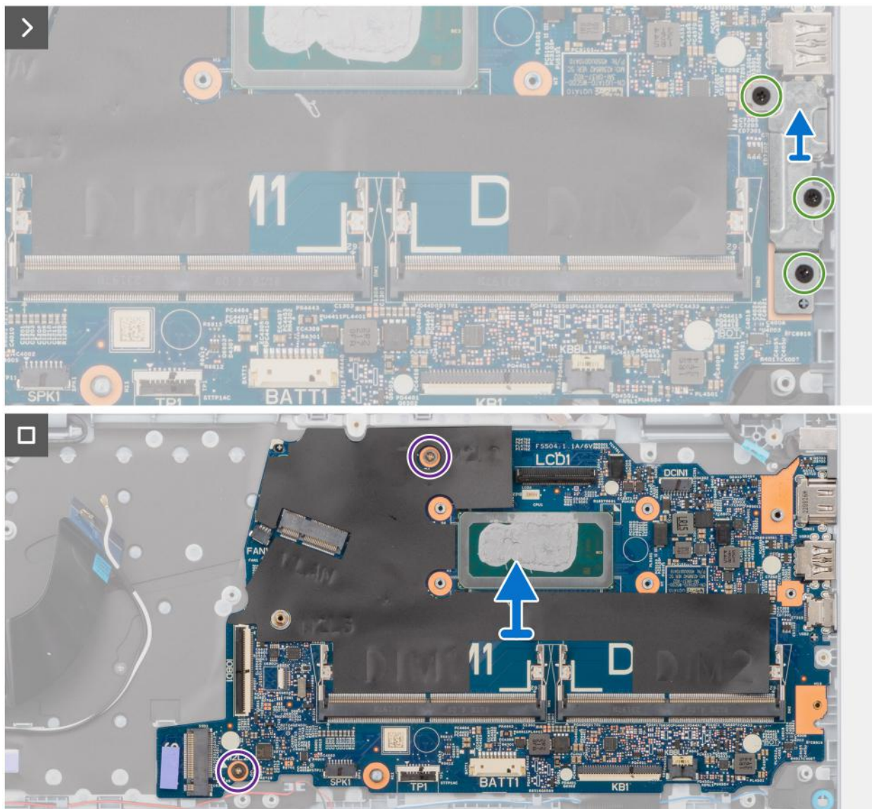
Rysunek 96. Wymontowywanie płyty głównej
