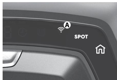
**3. Kad iestatīšana pabeigta,** pagrieziet robotu normālajā pozīcijā. WiFi simbols (A) iedegsies, norādot, ka robots ir pieslēgts pie jūsu mājas tīkla.
