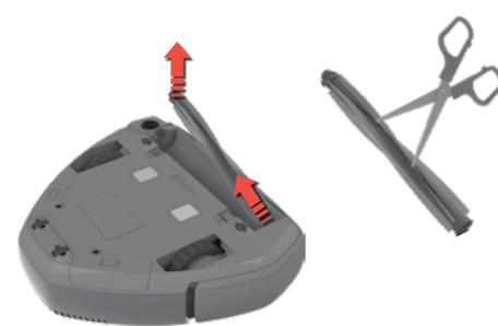
**2. Tõmmake harjarull välja ning puhastage hari ja laagrid.** Eemaldage külge jäänud niidid ja karvad, lõigates nad kääridega lahti. Tagasiasetamine toimub vastupidises järjekorras. Harjarulli saab tagasi panna. (Ref: **ERK2**)
