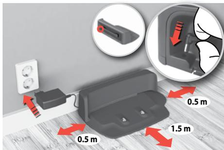
**1. Stellen Sie die Ladestation** auf den Boden an eine Wand. Schließen Sie den Netzstecker auf der Rückseite der Ladestation an. Stecken Sie den Netzstecker in die Netzsteckdose. Wickeln Sie herausragendes Kabel auf der Rückseite der Ladestation auf. Vergewissern Sie sich, dass der Abstand der Ladestation an den Seiten 0,5 m und nach vorne 1,5 m beträgt. **Wi-Fi-Modell:** Stellen Sie die Ladestation in der Nähe des WiFi-Routers auf.
