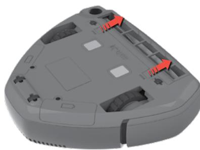
1. Drücken Sie die beiden Riegel und schieben Sie den Deckel nach vorne, um die Abdeckung der Bürstenrolle abzunehmen.
