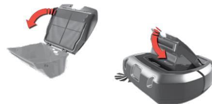
3. Kun säiliö on tyhjennetty, sulje kansi ja aseta se takaisin paikoilleen. Aseta pölysäiliö robottiin.
