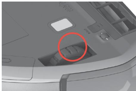
1. Verhædderte Haare oder Ähnliches von den Haupträdern entfernen, so dass sie sich frei drehen können.
