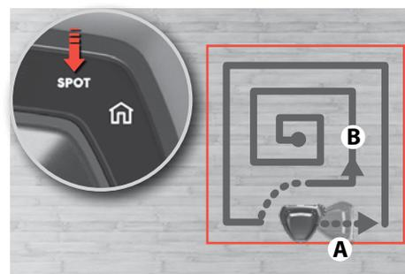
**SPOT Reinigung (kleine Bereiche, ca 1 m<sup>2</sup>):** Stellen Sie den Roboter in die Richtung des zu reinigenden Bereichs und drücken Sie die SPOT-Taste. Der Roboter wird diesen Bereich zweimal reinigen.
