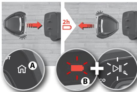
Sollte eine Aufladung während des Reinigungsvorgangs erforderlich sein, wird die Home-Taste (A) leuchtet auf. Die Akku- und Start/Pause-Taste (B) blinkt und zeigt an, dass der Roboter aufgeladen wird und die Reinigung an der Stelle fortsetzt, an der aufgehört wurde. Der Roboter wird bis zu 90 % geladen, damit die Reinigung schneller fortgesetzt werden kann. Die volle Aufladezeit beträgt ca. 2 Stunden.
