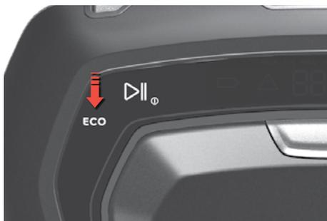
**ECO-toiminto:** Kevyempi puhdistus painamalla ECO-painiketta. Virrankulutus vähenee, käyttöaika pidentyy ja äänitaso alenee. Robotti pysyy ECO-tilassa, kunnes painiketta painetaan uudelleen.
