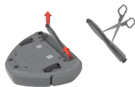
2. Nehmen Sie die Bürstenrolle heraus und reinigen Sie Bürste und die Lager Fäden u. ä. mithilfe einer Schere entfernen. Der Einbau erfolgt in umgekehrter Reihenfolge. Die Bürstenrolle kann ausgewechselt werden. (Ref: ERK2)
