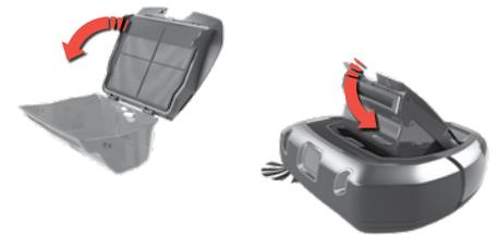
**3. Ka tvertne ir izņemta, aizveriet vāku un novietojiet to atpakaļ**
