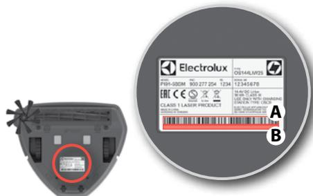
**2. Während der Installation werden Sie von der App aufgefordert, den Roboter umzudrehen**, um das WiFi-Modul zu aktivieren und den Strichcode mit der Seriennummer (A) zu scannen oder ihn manuell einzugeben (B). Folgen Sie anschließend den Anweisungen der App. **Anmerkung:** Bevor Sie den Roboter umdrehen, vergewissern Sie sich, dass das Gerät für mind. eine Minute eingeschaltet ist.
