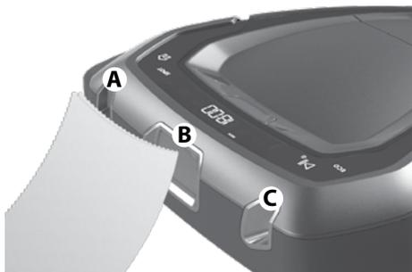
Das 3D Vision System arbeitet fehlerfrei, wenn die Sichtfenster (A,B,C) frei von Verunreinigungen und Kratzern sind. Reinigen Sie die Front mit einem trockenen, weichen Tuch von leichtem Staub. Ist sie stark verschmutzt, können Sie zur Reinigung ein mildes Reinigungsmittel verwenden.
