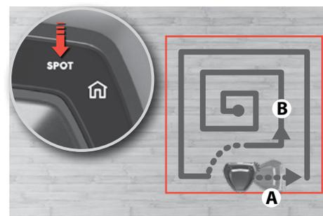
**Kohtpuhastus (väike piirkond, ~1 m<sup>2</sup>):** Asetage robot näoga puhastatava koha suunas ja vajutage nuppu SPOT. Robot puhastab piirkonda kaks korda.
