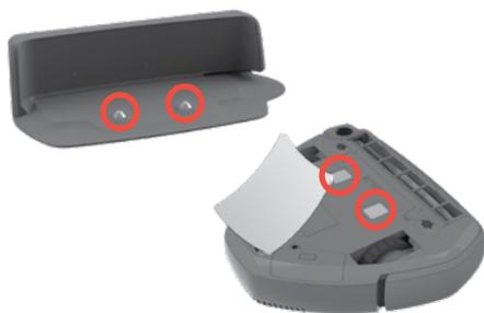
**Puhastage kuiva lapiga regulaarselt laadimisalusel ja masinal olevaid laadimiskontakte.**
