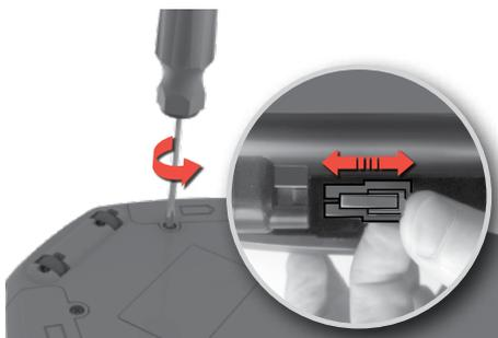
**1. Akkukotelot sijaitsevat robotin alapuolella.** Irrota akkukoteloiden kannet ruuvimeisselillä (PH2). Vaihda akut ja asenna akkukotelon kannet takaisin paikoilleen.
