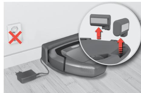
**3. Lagerung (nicht angeschlossen):** Sollte der Roboter ohne Aufladung gelagert werden, nehmen Sie die Akkus heraus und bewahren Sie sie getrennt auf. (Laden Sie die Akkus auf, bevor Sie sie herausnehmen).
