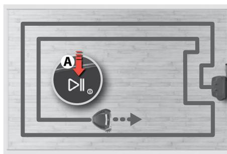
**1. Zum Reinigen die Taste Start/Pause (A) drücken.** Die Reinigung wird einige Sekunden nach dem Einschaltvorgang beginnen. Der Roboter fängt mit der Reinigung entlang von Wänden an und arbeitet sich in die Zimmermitte vor. **Anmerkung:** Drücken Sie kurz die Taste „Start/Pause“ (A), um die Reinigung zu unterbrechen oder halten Sie sie gedrückt, um die Reinigung zu beenden.
