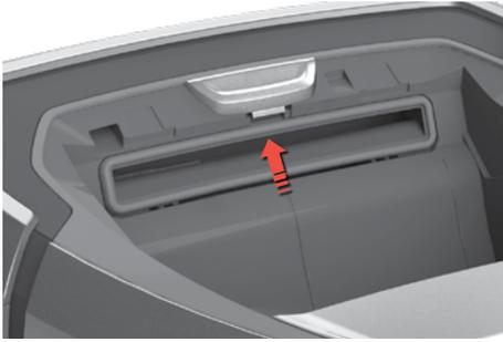
**Töm dammbehållaren.** Ta bort smuts som sitter i luftkanalen. Sätt tillbaka dammbehållaren.
