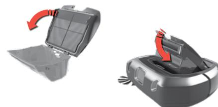
3. Efter tömning av behållaren, stäng luckan och sätt tillbaka den.
