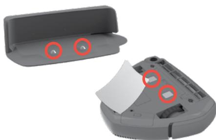
**Lietojiet mīkstu drānu,** lai regulāri tīrītu uzlādēšanas savienotājus, kas atrodas uz uzlādēšanas pamatnes un zem mašīnas.
