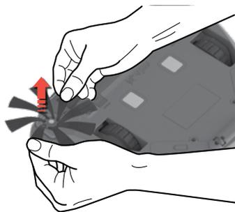
Ziehen Sie die Seitenbürste zum Entfernen heraus. Reinigen Sie die Seitenbürste. Die Seitenbürste wieder in die Halterung einsetzen. Die Seitenbürste kann ausgewechselt werden (Ref: ERK2 / EBSB2)
