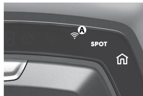
**3. Kui seadistamine on valmis, pöörake robot tagasi oma õigesse asendisse. Roboti WiFi-sümbol (A) süttib, näidates, et robot on kodu WiFi-võrku ühendatud.**
