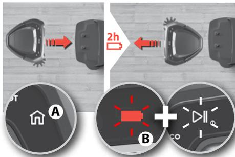
**Ja robotu tīrīšanas laikā nepieciešams uzlādēt,** iedegsies sākuma taustiņš, un robots atgriezīsies uz uzlādēšanas pamatnes. Iedegas sākuma taustiņš (A). Akumulators un atskaņošanas/ paizes taustiņš (B) mirgo, norādot, ka robots tiek uzlādēts un atsāks darbu no tās vietas, kur tas tika pārtraukts.
