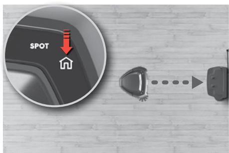
**Pārtrauciet tīrīt un nosūtiet robotu uz uzlādēšanas pamatni:** piespiediet sākuma taustiņu. Ja robots netiek iedarbināts no uzlādēšanas pamatnes, tas atgriezīsies sākuma pozīcijā.
