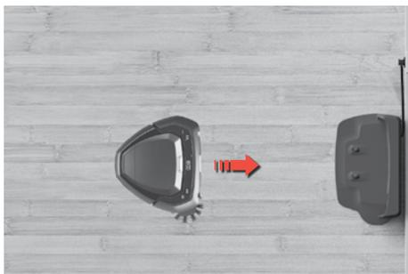
**Imuroinnin jälkeen**, robotti palaa automaattisesti takaisin lataustelakkaan.
