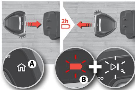
Om robotdammsugaren behöver laddas under städning tänds hemknappen (A) och roboten återvänder till laddarbasen. Hemknappen (A) tänds. Batterisymbolen och Spela/Pausknappen (B) blinkar för att indikera att robotdammsugaren laddas och att den kommer att återuppta städningen på den plats där den avbröts. Robotdammsugaren laddas upp till 90 % för att kunna återuppta städningen snabbare. Laddningen tar ca 2 timmar.
