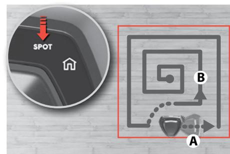
**TRAIPU tīrīšana (maza zona, ~ 1 m<sup>2</sup>):** novietojiet robotu tā, lai tas būtu ar skatu pret traipu, un piespiediet TRAIPU taustiņu. Robots notīrīs zonu divas reizes.
