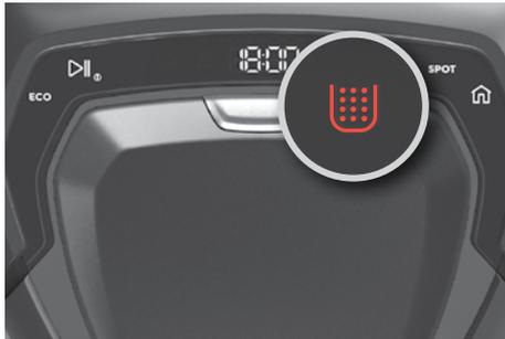
1. **Leeren Sie den Staubbehälter** regelmäßig oder sobald das Staubbehälter-Symbol aufleuchtet
