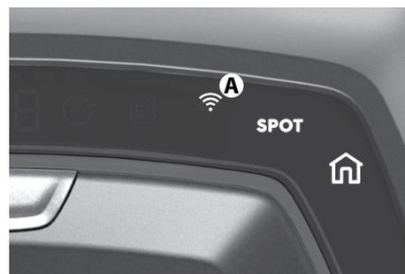
**3. Drehen Sie nach dem Installationsende den Roboter um**, zurück in seine normale Position. Das WiFi-Symbol (A) leuchtet auf und zeigt an, dass der Roboter erfolgreich mit Ihrem Heimnetzwerk verbunden wurde. **Anmerkung:** Es kann einige Minuten dauern, bis sich die Uhr des Roboters mit der Uhr Ihres Mobiltelefons automatisch synchronisiert. **Anmerkung:** Ein pulsierendes WiFi-Symbol zeigt an, dass der Roboter versucht, eine Verbindung mit Ihrem Heimnetzwerk herzustellen.
