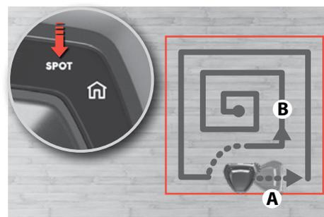
**PUNKTSTÄDNING (liten yta, ca 1 m<sup>2</sup>):** Placera robotdammsugaren så att den är vänd mot punkten och tryck på SPOT-knappen. Roboten dammsuger området två gånger.
