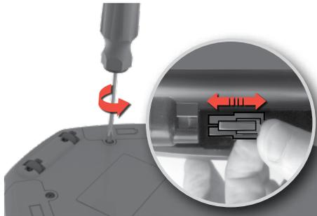
**1. Das Akkufach befindet sich auf der Unterseite des Roboters.** Verwenden Sie einen Schraubendreher (PH2), um die Abdeckungen des Akkufachs abzuschrauben. Tauschen Sie die Akkus aus und bringen Sie die Abdeckungen wieder an.
