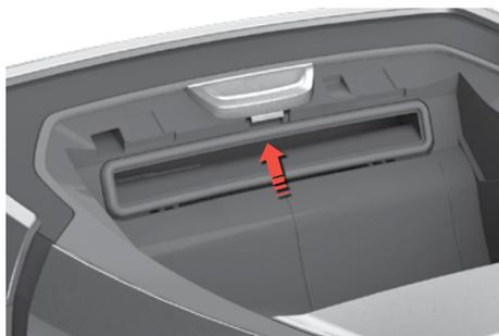
**Eemaldage tolmukonteiner.** Eemaldage õhukanalist kogunenud praht. Pange tolmukonteiner oma kohale.
