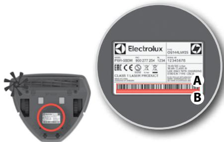
**2. Konfiguroinnin aikana sovellus pyytää sinua kääntämään robotin ylösalaisin** aktivoitaksesi WiFi-moduulin ja skannataksesi sarjanumeron viivakoodin (A) tai syöttääksesi sen manuaalisesti (B). Jatka tämän jälkeen sovelluksen ohjeiden noudattamista.
