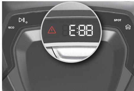
**1. Sollte ein Fehler auftreten,** unterbricht der Roboter den Reinigungsvorgang. Das Warnsymbol pulsiert und die Zeichen **“E:“ gefolgt von einem Fehlercode** werden auf dem Display angezeigt. Der Fehler wird ebenso mithilfe einer Audiomeldung beschrieben. Drücken Sie eine beliebige Taste, um die Audiomeldung nach einem Fehler erneut abzuspielen.
