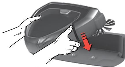
**Lai robotu ieslēgtu un izmantotu, pievienojiet to uzlādes stacijai.**
