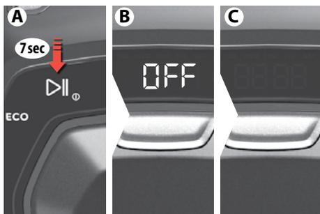
**Stäng av roboten:** Det går också att stänga av roboten helt, om du inte ska använda den på ett tag. Följ nedanstående steg:
