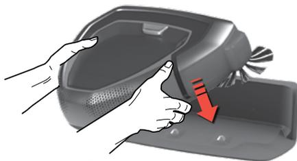
**För att starta om roboten och använda den igen, sätt in den i laddningsbasen.** Det går också att stänga av den i laddningsbasen. Men då måste du lyfta den och sätta in den i laddningsbasen igen för att använda den.
