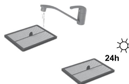
3. Skölj filtret i kallt vatten. Knacka på filterramen för att avlägsna vattnet. Låt filtret torka i 24 timmar innan du sätter tillbaka det i maskinen.
