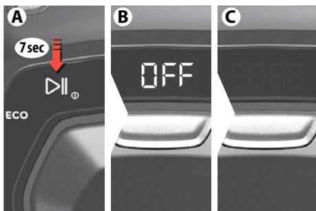
**Robota izslēgšana:** Ja robotu nav paredzēts izmantot ilgāku laiku, to var pilnībā izslēgt. Lai to izdarītu, veiciet turpmāk norādītās darbības.
