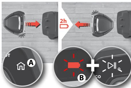
**Jos robottia on ladattava puhdistuksen aikana**, Koti-painike syttyy ja robotti palaa lataustelakkaan. Koti-painike (A) syttyy. Akun merkkivalo ja Käynnistä/Keskeytä-painike (B) vilkkuvat osoittaen, että robotti latautuu ja jatkaa myöhemmin puhdistusta kohdasta, jossa siivous keskeytyi. Robotti latautuu enintään 90 %:sti väililatauksen aikana, jotta se voi jatkaa puhdistusta mahdollisimman nopeasti. Lataaminen kestää ~2 tuntia.
