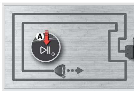
1. Tryck på Spela/Paus-knappen (A) för att starta städningen. Efter några sekunder (systemstarten) börjar roboten dammsuga. Robotdammsugaren börjar städa längs väggarna och arbetar sig inåt rummet. **OBS!** Tryck på "Spela/Paus" (A) för att sätta dammsugaren på paus eller håll ner knappen för att avsluta dammsugning.
