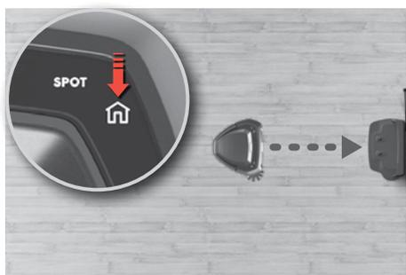
**Die Reinigung beenden und den Roboter an die Ladestation schicken:** Drücken Sie die Home-Taste. Wurde der Roboter nicht von seiner Ladestation aus gestartet, kehrt er auf die Startposition zurück.
