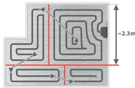
**2. Größere Räume werden in zwei Bereiche aufgeteilt mit einer Größe von max. 2 x 2.3 m.** **Anmerkung:** Das Reinigungsmuster ist effizienter, wenn der Roboter mit der Reinigung an einer Wand beginnt.
