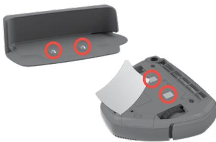
**Reinigen Sie die Ladeanschlüsse regelmäßig mit einem trockenen und weichen Tuch** an der Ladestation und unter dem Gerät.
