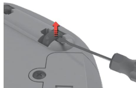
2. Wenn die kleinen Räder blockieren, sollten sie vorsichtig mithilfe eines Schraubendrehers entfernt und gereinigt werden.
