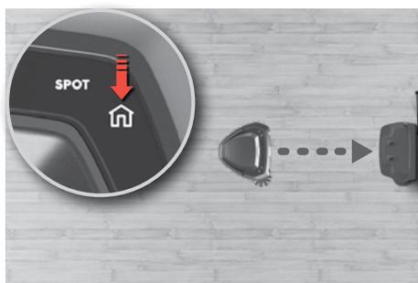
**Imuroinnin lopettaminen ja robotin lähettäminen lataustelakkaan:** Paina Koti-painiketta. Jos robottia ei ole alun perin käynnistetty lataustelakasta, se palaa telakan sijasta käynnistyksen aikaiseen alkusijaintiin.
