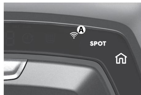
3. När configurationen är klar, ska du vända robotdammsugaren rätt igen. WiFi-symbolen (A) lyser för att indikera att robotdammsugaren är ansluten till ditt hemnätverk. **OBS!** Det kan ta en liten stund innan robotdammsugaren har synkroniserats med din mobila enhet (det sker automatiskt). **OBS!** En blinkande WiFi-symbol indikerar att robotdammsugaren försöker ansluta till nätverket.
