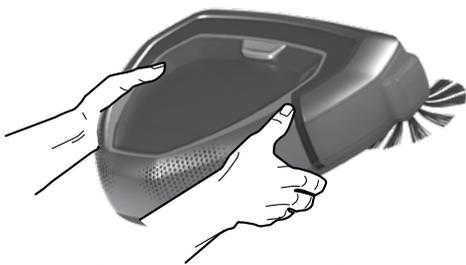
**Tragen Sie den Roboter stets mit beiden Händen die Vorderseite hoch haltend. Den Roboter per Hand bewegen:** Ein manuelles Eingreifen in den Reinigungsvorgang des Roboters ist nicht ratsam, da die Reinigung unter Umständen von vorne beginnt.
