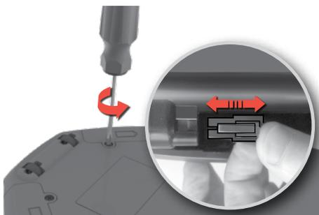
**1. Akumulatoru nodalījumi atrodas robota apakšpusē.** Atskrūvējiet akumulatoru nodalījuma vāku ar skrūvgriezi (PH2). Nomainiet akumulatoru blokus un uzstādiet atpakaļ akumulatora nodalījuma vāciņu.
