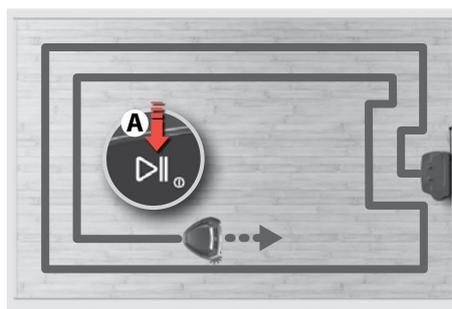
**1. Puhastamise alustamiseks vajutage nuppu Esita/paus (A).** Pärast mõni sekund kestvat käivitumist algab puhastamine. Robot alustab puhastamist seinte äärtest, liikudes järk-järgult sissepoole.
