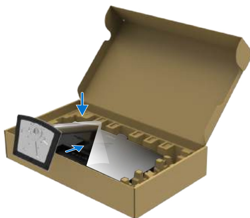
Rysunek 22. Wsuwanie wypustek na kolumnie podstawy w szczeliny
