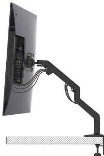
Rysunek 66. Podłącz kable przy ustawieniu monitora w najwyższym położeniu i maksymalnie obróconym w osi
