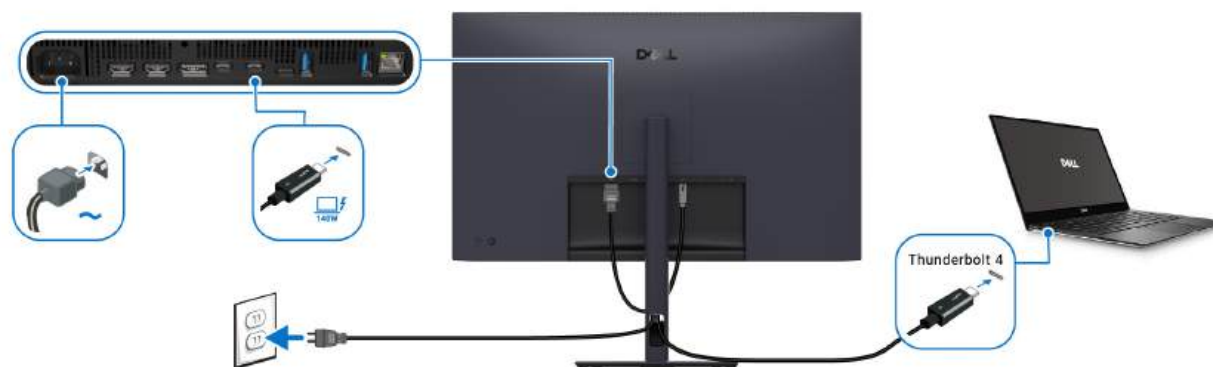
Rysunek 38. Połączenie Thunderbolt 4
