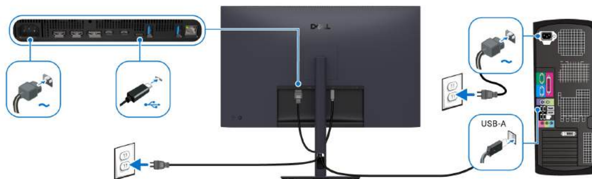
Rysunek 37. Podłączanie kabli USB typu C do typu A
