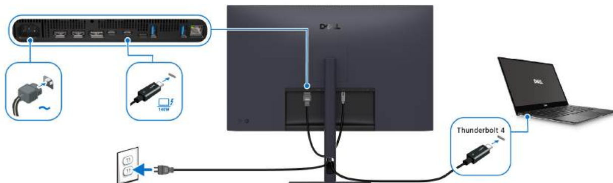
Rysunek 45. Podłączenie aktywnego kabla Thunderbolt 4 dla DPBS
