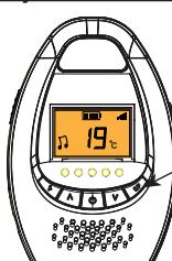
Wyświetlacz na urządzeniu rodzica pokazuje temperaturę mierzoną przez urządzenie dziecka. Należy pamiętać, że temperatura ma charakter wyłącznie orientacyjny, z tolerancją +/- 2°C.
