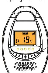
Pokud změřená teplota překročí 32°C, objeví se na displeji symbol „HH“. Při teplotě pod 15°C objeví se symbol „LL“. Pamatujte, že teplotní čidlo potřebuje dokonce i 24 hodiny pro zobrazení pokojové teploty.
