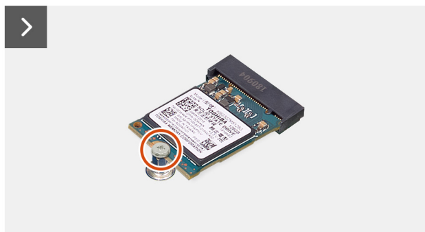
Rysunek 22. Wymontowywanie dysku SSD M.2 2230
