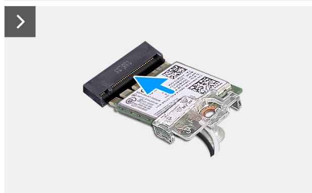
Rysunek 27. Instalowanie karty sieci bezprzewodowej
