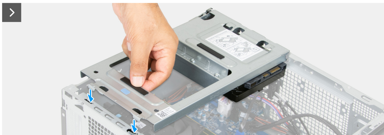
Rysunek 31. Instalowanie wnęki na dysk
