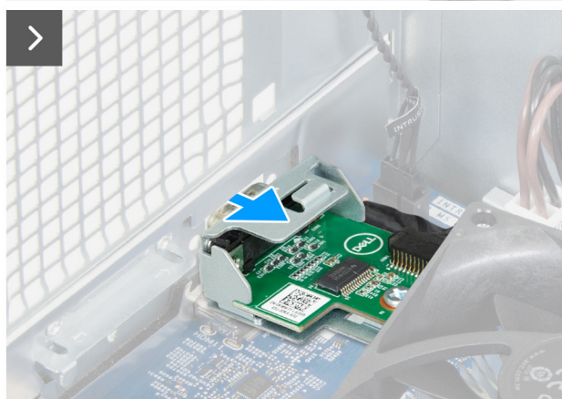
Rysunek 41. Wymontowywanie modułu portu szeregowego
