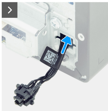
Rysunek 36. Instalowanie przycisku zasilania
