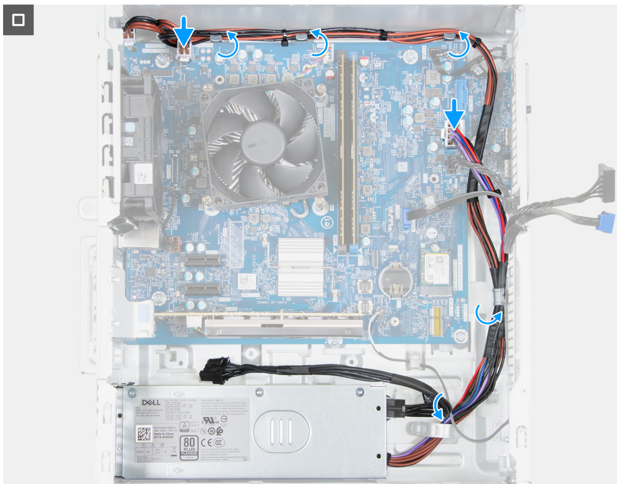
Rysunek 49. Instalowanie zasilacza
