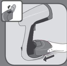
**FR** Remettez le réservoir d'eau à sa place en le verrouillant sur l'appareil.
