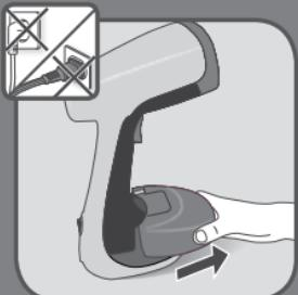
**PT** Pressione o botão de bloqueio do depósito da água.
