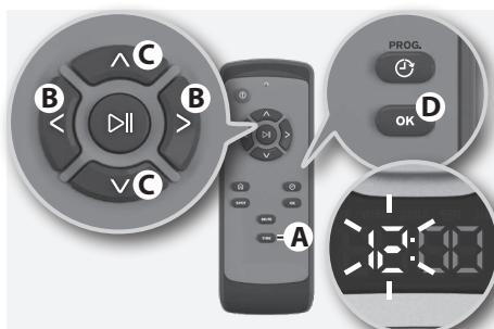
**3. Endre «Time»:** trykk på &- eller &-knappen (C) til korrekt time blinker. Bekrefte ved å trykke på «OK» (D).
