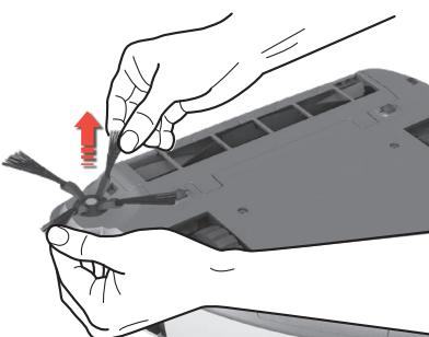
**1. Tirare le spazzola laterale verso l'esterno per rimuoverla.** Pulirla. Fissarla nuovamente nell'attacco. È possibile sostituire la spazzola laterale. (Rif: ERK1)
