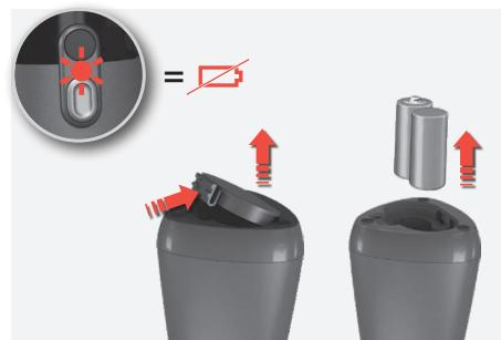
**5. Opladning af batterierne:** Den røde blinkende lampe indikerer, at batterierne skal oplades. Batterirummet er placeret på undersiden af den virtuelle barriere. Tryk klinken indad og fjern låget. Udsift de to batterier, og sæt batterirummets låg på plads.
