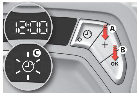
**2. Endre «Time»:** trykk på +-knappen (A) til korrekt time blinker. Trykk på «OK» (B) for å bekrefte.
