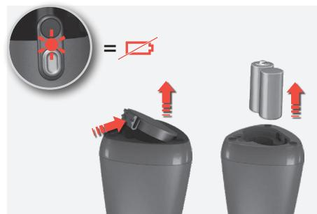
**5. Skifte batteriene:** Den røde, pulserende LED-lampen indikerer at batteriene må skiftes. Batteriene er plassert nederst på siden av den virtuelle barriermen. Trykk inn lukkemekanismen og ta av lokket. Skift ut de to batteriene og sett lokket tilbake.
