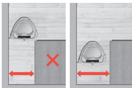
1. **For at sikre, at robotten rengør overalt**, anbefales det, at man sørger for tilstrækkeligt plads mellem møblerne og væggene (ca. 40 cm).
