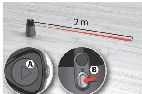
2. Anbring den virtuelle barriere på gulvet. (Pilen i toppen (A) angiver barrierens retning.)
