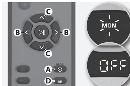
**5. Skift "Hour" (time).** Tryk på ^ eller v knappen (C), indtil den ønskede time blinker. Tryk "OK" (D) for at bekræfte.
