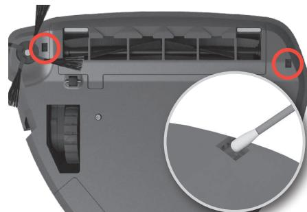
**2. V zájmu zachování optimální výkonnosti pravidelně čistěte snímače srázu.**
