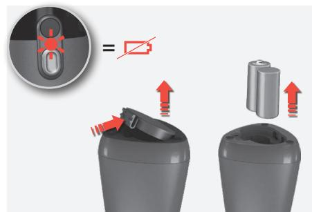
**5. Sostituzione delle batterie:** Il LED rosso lampeggiante indica che è necessario provvedere alla sostituzione delle batterie. Il vano batteria si trova sul lato inferiore della barriera virtuale. Premere il blocco verso l'interno e togliere il coperchio. Sostituire le due batterie e inserire nuovamente il coperchio del vano batteria.
