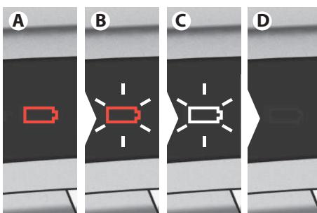
**1. Červená baterie (A)** značí, že zařízení potřebuje dobít. **Červené blikání (B):** Zařízení se dobíjí – nízký stav nabíjet.
