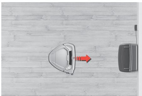
1. Al termine della pulizia il robot torna automaticamente alla base per il caricamento.
