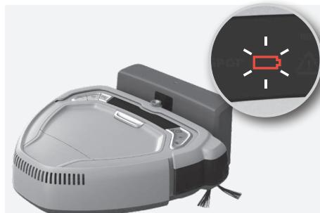
**3. Per avviare il robot, collocarlo sulla base di caricamento.** L'icona della batteria lampeggia in colore rosso, ad indicare che la batteria è scarica e che si sta ricaricando.
