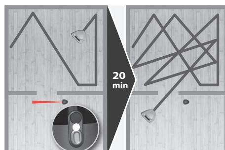
3. Spegnimento automatico dopo 20 minuti: Posizionare la barriera virtuale sulla soglia della porta. Premere una volta il pulsante, la spia LED verde indica che si spegnerà dopo 20 minuti. Il robot concentrerà la pulizia sull'area definita. La barriera virtuale si spegnerà automaticamente dopo 20 minuti consentendo al robot di pulire una nuova area.
