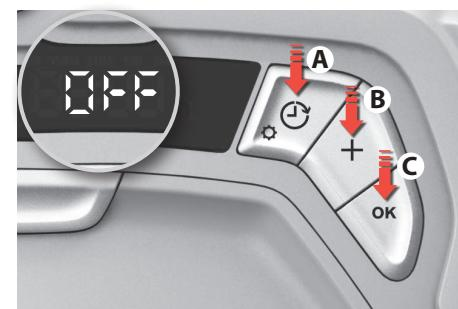
**3. Fjern en planlagt rengøring:** Tryk på Schedule/Setting knappen (A), ugedagene blinks, tryk på + knappen (B), indtil den ønskede dag blinks. Tryk "OK" (C) for at bekræfte. Tryk på + knappen (B), indtil "OFF" blinks. Tryk "OK" (C) for at bekræfte, og afslut.
