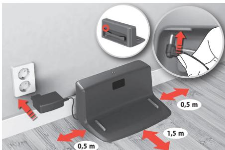
**1. Collocare la base di caricamento a terra**, appoggiata contro la parete. Collegare l'adattatore al jack di alimentazione sulla parte posteriore della base. Collegare il cavo di alimentazione alla presa principale. Avvolgere il cavo in eccesso sulla parte posteriore della base. Verificare che ci sia uno spazio vuoto di 0,5 m sui lati e di 1,5 m sulla parte anteriore della base di caricamento.
