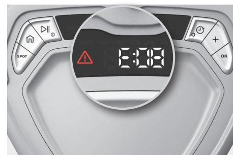
1. Qualora si verifichi un errore, il robot aspirapolvere interrompe l'operazione di pulizia. L'icona di avvertimento lampeggiava e la lettera "E" seguita da un codice di errore viene visualizzata sul display.
