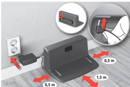
**1. Dobijecí stanici položte** na podlahu ke zdi. Zapojte konektor adaptéra do zástrčky na zadní straně stanice. Zasuňte zástrčku napájecího kabelu do sítové zásuvky. Navířte nadbytečný kabel na zadní stranu stanice. Ujistěte se, že je na obou stranách dobijecí stanice 0,5 m volného místa a 1,5 m volného místa před ní.
