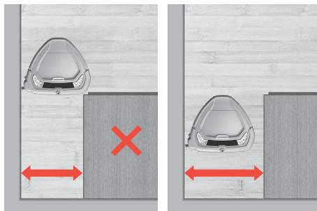
1. **For å sikre at roboten rengjør overalt**, anbefaler vi at du lar det være nok plass mellom møblene og veggene (omrent 40 cm).
