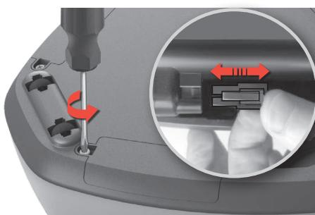
1. Gli scomparti batteria si trovano sul lato inferiore del robot. Usare un cacciavite (PH2) per svitare i coperchi dello scomparto batteria. Sostituire i due pacchi batteria e inserire nuovamente i coperchi del vano batteria.
