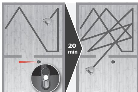
3. Autosluk efter 20 minutter: Anbring den virtuelle barriere i døråbningen. Tryk én gang på knappen, og den grønne lampe indikerer, at den slukkes om 20 minutter. Robotten fokuserer rengøringen i det angivne område. Den slukker automatisk efter 20 minutter, så robotten kan rengøre et nyt område.
