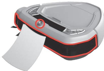
**1. Systém MotionSense funguje nejlépe, když je přední část spotřebiče čistá.**
