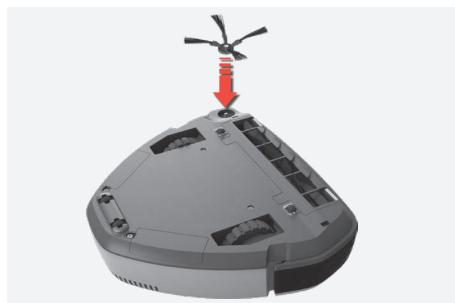
**2. Servirsi della funzione magnetica per fissare la spazzola** laterale nell'attacco che si trova sul lato inferiore del robot.
