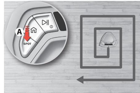
3. **Spot rengøring (lille område, ~1 m<sup>2</sup>):** Anbring robotten på den plet (spot) du vil gøre ren og tryk på SPOT knappen (A). Spot rengøring kan startes, mens robotten støvsuger eller er i tidsplan funktionen. Når robotten er færdig, går den i hviletilstand. Tryk på Play/Pause knappen for at fortsætte støvsugningen i normal funktion.
