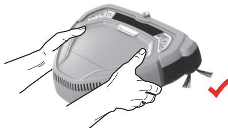
1. Bær altid robotten med to hænder og hold forsiden opad.
