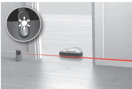
**4. Automatisk av etter 8 timer:** Plasser den virtuelle barriermen for å definere den forbudte sonen. Trykk på knappen to ganger. Den grønne, pulserende LED-lampen indikerer at den vil slå seg av etter 8 timer, noe som tillater én ekstra rengjøringssyklus.
