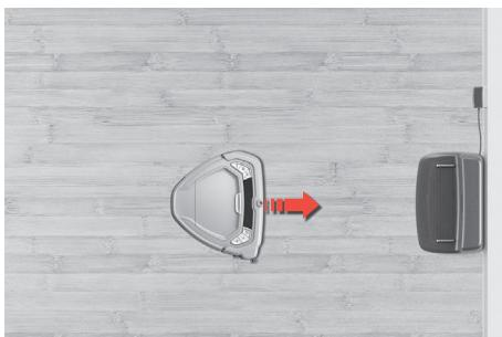
1. Når rengøringen er færdig, vender robotten automatisk tilbage til ladestanden for at blive opladt. Hvis robotten er i et andet rum, søger den efter ladestationen, indtil den løber tør for batteri.
