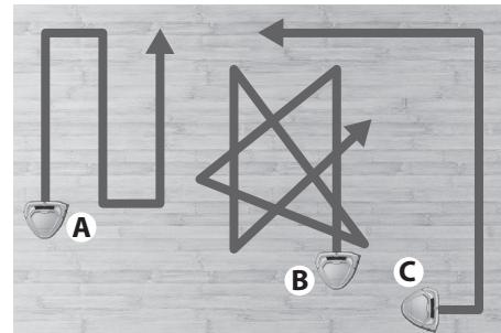
2. **Robottens intelligens registrerer forhindringer og beregner derfor den optimale rengøringsbane til en effektiv rengøring.** Den skifter automatisk mellem forskellige rengøringsfunktioner:
