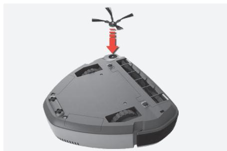
**2. Pomocí magnetu připojte boční kartáč do držáku na spodní straně robotického vysavače.**
