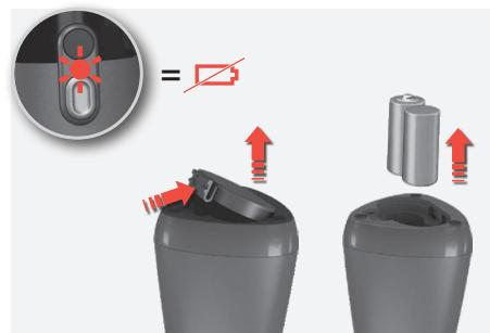
**5. Výmena baterií:** Červená blikající LED kontrolka značí, že je zapotřebí vyměnit baterie. Prostor pro baterie se nachází na spodní straně virtuální bariéry. Stiskněte západku a odstraňte víko. Vyměňte obě baterie a znova nasadte víko pro baterie.
