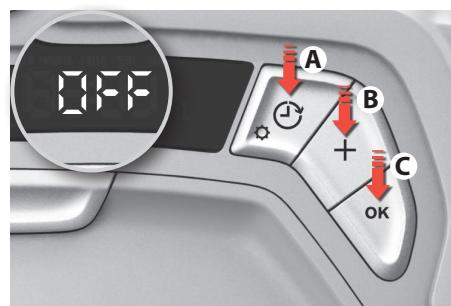
**3. Odstranění plánovaného vysávání:** Stiskněte tlačítko plánovacího časovače/nastavení (A), rozbliká se den v týdnu, stiskněte tlačítko + (B), dokud nebliká správný den. Potvrďte stisknutím „OK“ (C). Stiskněte tlačítko + (B), dokud nebliká „OFF“. Potvrďte stisknutím „OK“ (C) a opusťte nabídku.
