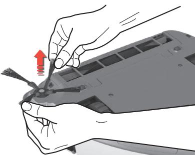
**1. Vytažením směrem ven vyjměte boční kartáč. Boční kartáč vycistěte. Nasadte boční kartáč zpět do držáku. Boční kartáč lze vyměnit. (Ref.: ERK)**
