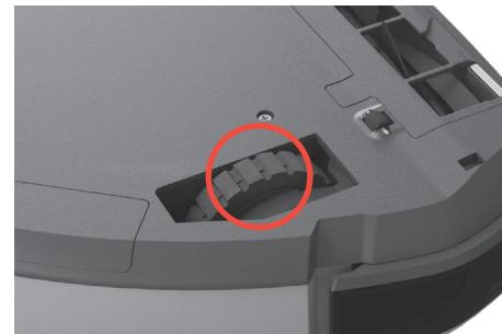
**3. Rimuovere i capelli impigliati nelle ruote principali di modo che possano girare senza difficoltà.****3. Ta bort hår och dylikt från hjulen så att de kan röra sig fritt.****Pulizia della spazzola laterale**
