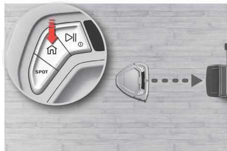
2. Stop rengøringen og send robotten til ladestationen: Tryk på Home knappen. Robotten stopper automatisk rengøringen og vender tilbage til ladestationen. Hvis robotten er startet i et rum, hvor der ikke er nogen ladestation, begynder den at søge efter den.
