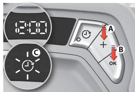
**2. Skift "Hour" (time):** Tryk på + knappen (A), indtil den ønskede time blinks. Tryk "OK" (B) for at bekræfte. **Skift "Minutes" (Minutter):** Tryk på + knappen (A), indtil det ønskede minut blinks (der kan kun vælges 10 minutter ad gangen). Tryk "OK" (B) for at bekræfte. Planlægningsikonet (C) lyser for at angive, at den planlagte rengøring er aktiv.
