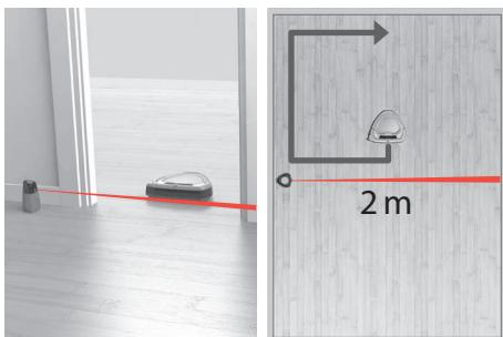
1. Den virtuelle barriere skaber en usynlig linje (2 m), som robotten ikke kan overskride. Den kan bruges til at definere et bestemt område, der skal rengøres, eller til at lave forbudte områder (f.eks. kabler eller følsomme genstande).
