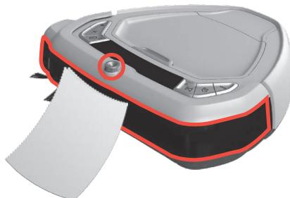
**1. Il sistema MotionSense funziona meglio se la parte anteriore viene tenuta pulita.**
