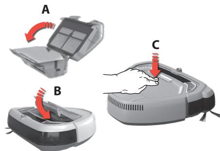
3. Dopo aver svuotato il contenitore, chiudere il suo coperchio (A) e ricollocarlo (B). Rimettere il contenitore della polvere nel robot e premere la parte anteriore del coperchio verso il basso fino a che non sarà completamente bloccato (C).
