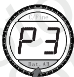
Wyświetlacz lewego kontrolera wyświetla wynik pomiaru naładowania akumulatorów A i B.
