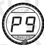
Wyświetlacz prawego kontrolera wyświetla wynik pomiaru naładowania akumulatorów C i D.
