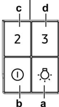
Вытяжка оснащена панелью управления для контроля скорости вытяжного вентилятора и включения света для освещения рабочей поверхности плиты.
