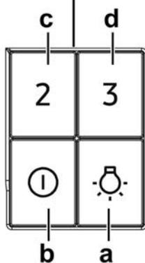
Die Dunstabzugshaube ist mit einer Bedienungsblende ausgestattet, die mit einer Steuerung für die Ansaugstärke bzw. -geschwindigkeit, sowie einer Steuerung zur Einstellung der Arbeitsplatzbeleuchtung versehen ist.
