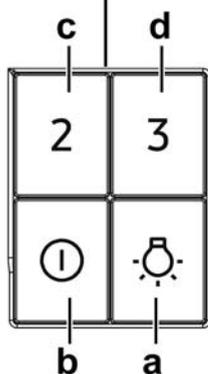
La hotte est équipée d'un panneau de contrôle doté d'une commande de vitesse d'aspiration et d'une commande d'éclairage du plan de cuisson.
