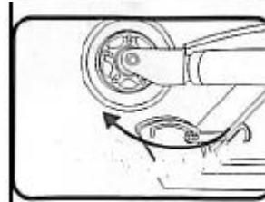
6. Зафиксируйте блокирующий механизм.
