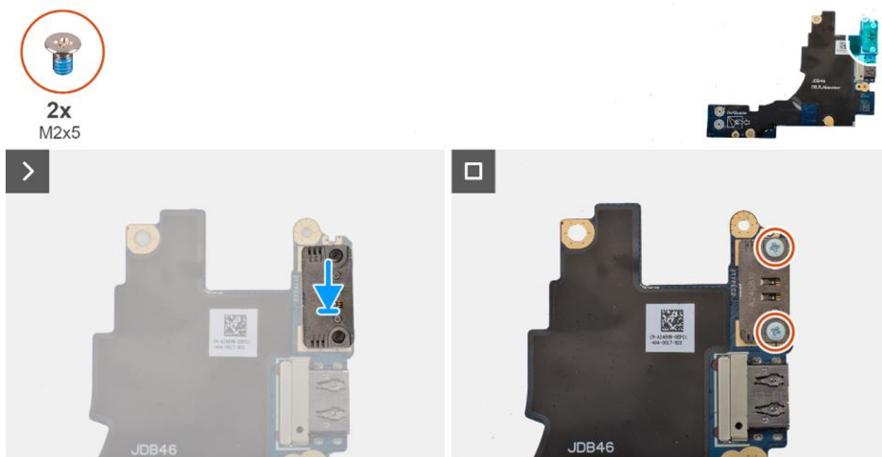
Rysunek 53. Instalowanie lewego modułu USB typu C
